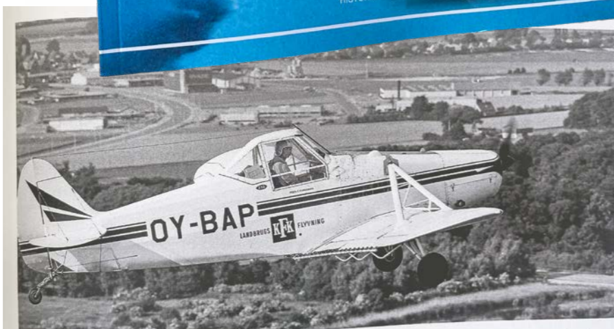
OY-BAP enroute over Lolland med Egon Klinggaard ved roret. Sprøjtebomben ved bagkanten af vingerne er fastgjort med beslag inde fra understellet. Navigationen foregik altid efter landkending og efter visuelle regler. Erik Hansen, Nakskov Lokalarkiv
