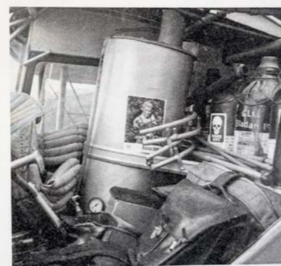
Indretningen i Erik Malmroses første fly, OY-DUB. Kemibeholderen har taget passagerpladsen. Det var nok ikke en arbejdsplads, der ville blive godkendt i dag. Læg mærke til beholderne i baggrunden. Ved et havari nok ikke det sjoveste at få smidt i nakken eller ved udslip. OM.
