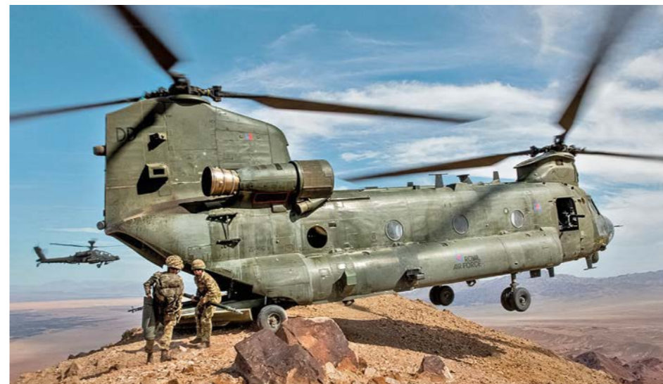
En Chinook-specialitet – baghjulene på en bakketop, forhjulene stadig flyvende. Bemærk Apache-helikopteren bag den. Disse kamphelikoptere eskorterede ofte Chinooks på deres opgaver i Afghanistan. Foto: Crown Copyright/SAC Nicholas Egan
