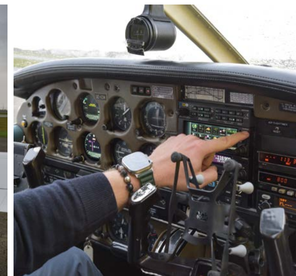
En svensk Piper 28 overleveres til ejerne, efter flyet har gennemgået en større opgradering i cockpittet. Her er den kunstige horisont og gyrokompasset skiftet ud med to runde digitale G1275 instrumenter, der er koblet på en helt ny Garmin GPS/COM GNC355a og en GFC500 digital autopilot.
