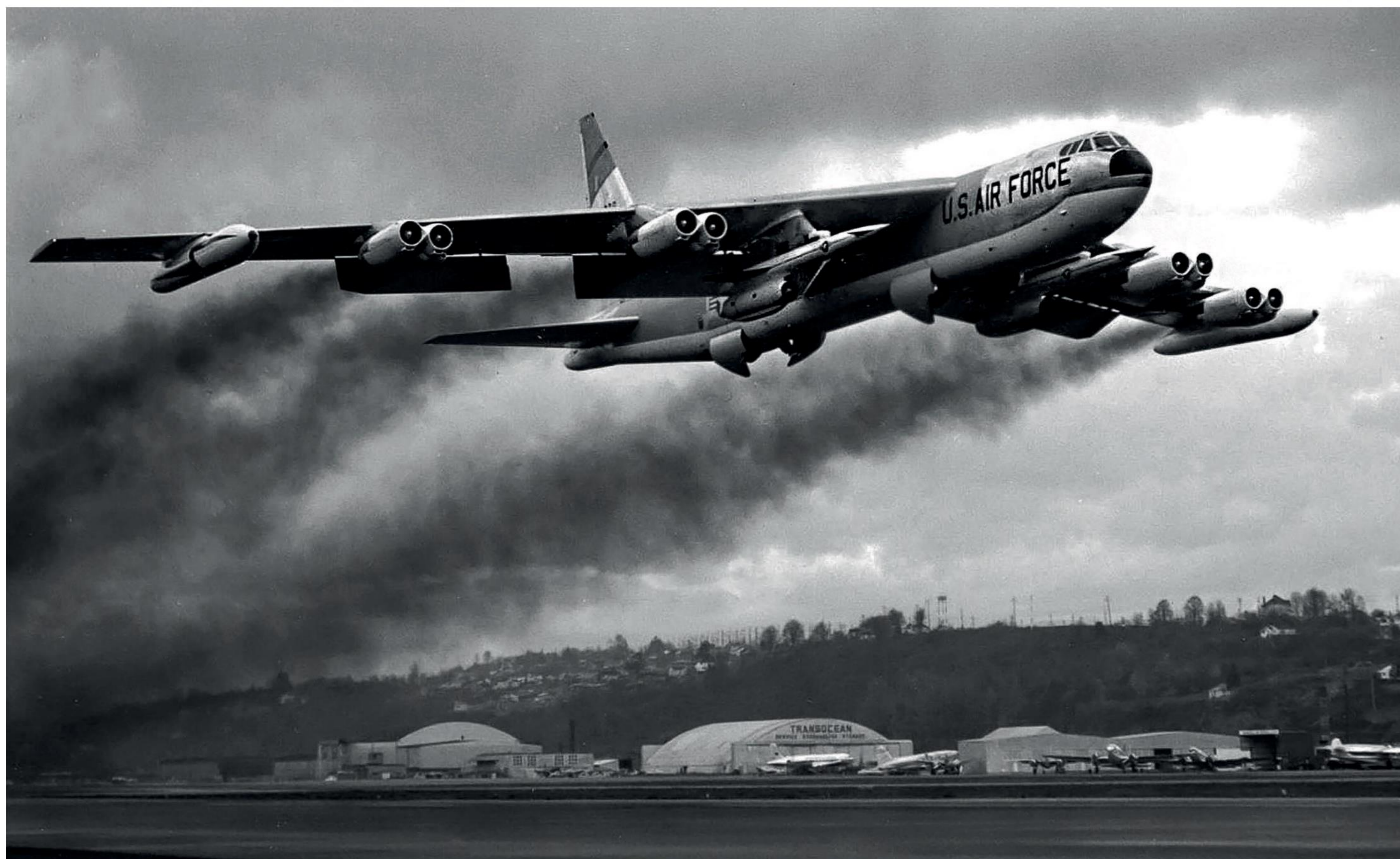
En B-52 letter med et AGM-28 Hound Dog krydsermissil under hver vinge. Missilet havde atomsprænghoved og blev udviklet sidst i 1950'erne, hvor hele USA's atomare afskrækkelse byggede på bombefly. Hound Dog-missilet skulle bruges til at uskadeliggøre sovjetiske luftforsvarsinstallationer – eksempelvis omkring Moskva – så andre B-52'ere kunne komme frem med deres atombomber. Foto: USAF
