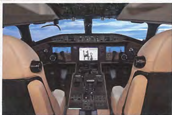
Rockwell Collins Pro Line Fusion med Head Up Display. På skærmen i midten vises lufthavnens layout. Foto: Rockwell Collins.
