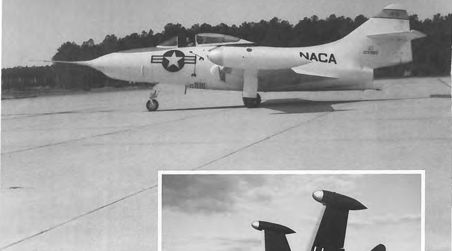
Panther-prototypen efter førsteflyvningen i november 1947. Testflyet er malet helt i hvidt og udstyret med NACA-bemaling samt pitotrør i næsen.
