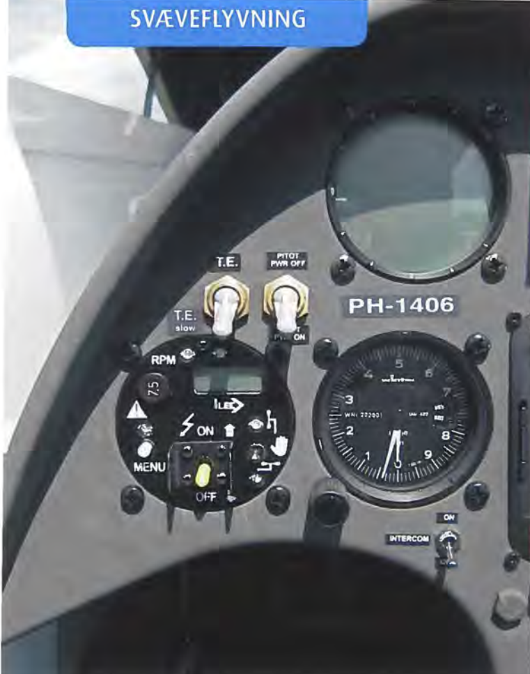
TB06 motorstyringen sørger for fuldautomatisk start og standsning af motoren, dog med mulighed for at gribe manuelt ind.
