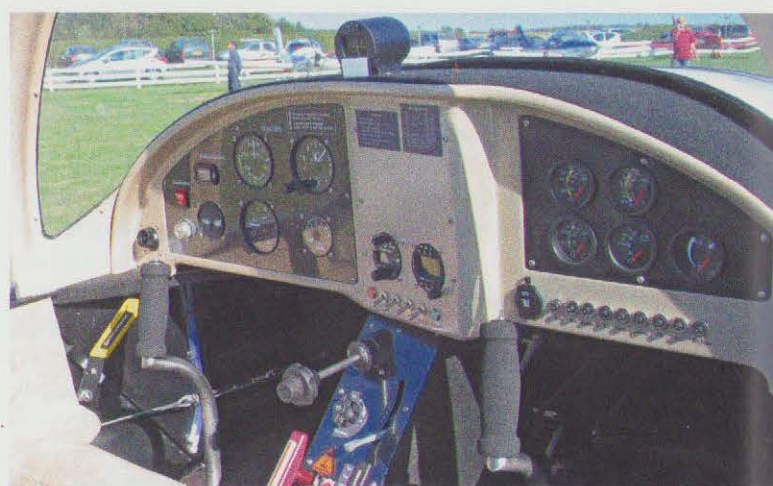
Standardinstrumentpanelet i Breezer. Flyet kan også leveres med to fladskærme og i midterpanelet en GPS.
