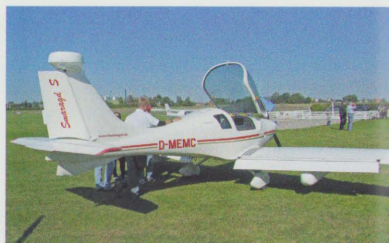
FA01 Smaragd udstyret med kamerapods e.l. under vingerne. På halefinnen ses antennen til transmissionsudsty
