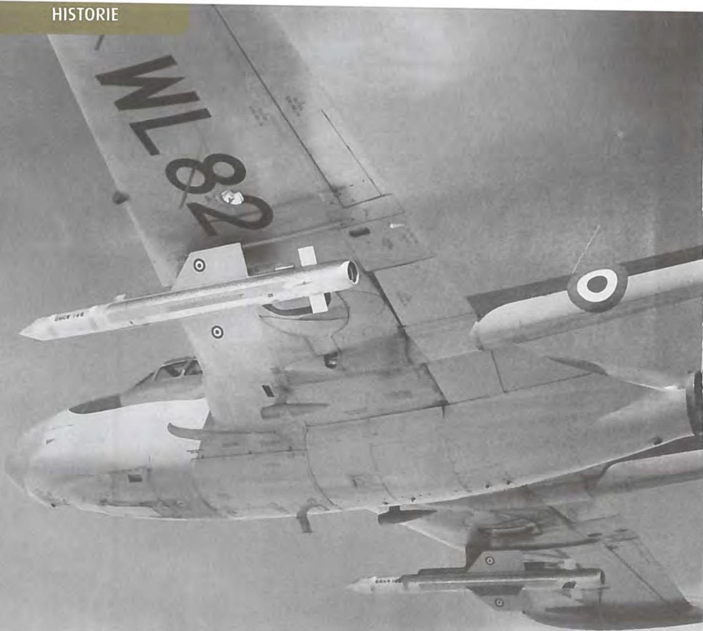
I sine sidste aktive dage i Royal Navy kunne Sea Venom medføre to Firestreak air-to-air missiler under vingerne.
