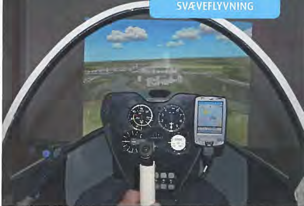
Så flot ser det ud inde fra cockpittet. Hvem kan se at instrumenterne bliver vist på en 9" TFT skærm igennem 80 mm huller i frontpladen?
