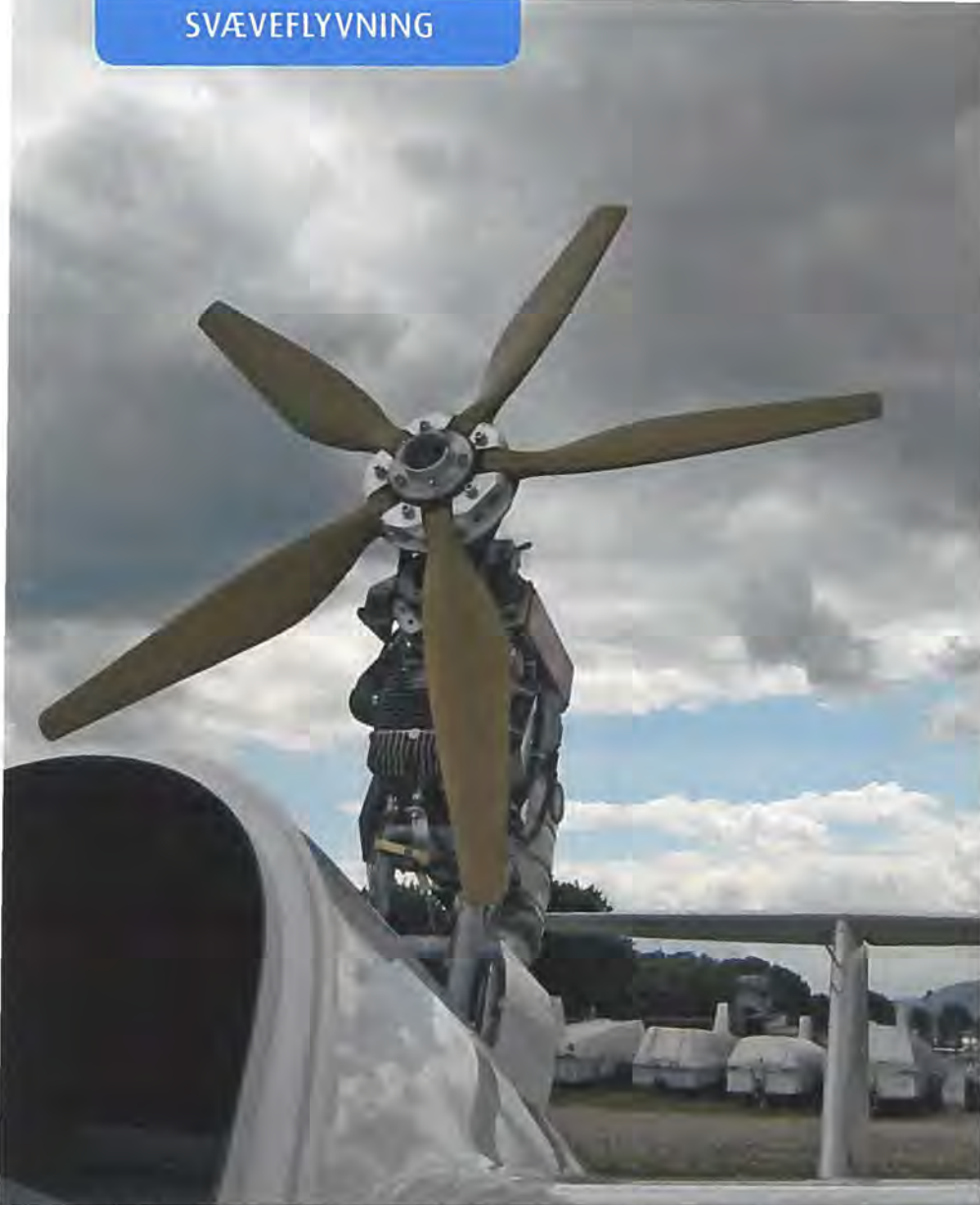
I »T-udgaven« giver et Oehler-drev med den 5-blads foldepropel mulighed for hjemflyvning.
