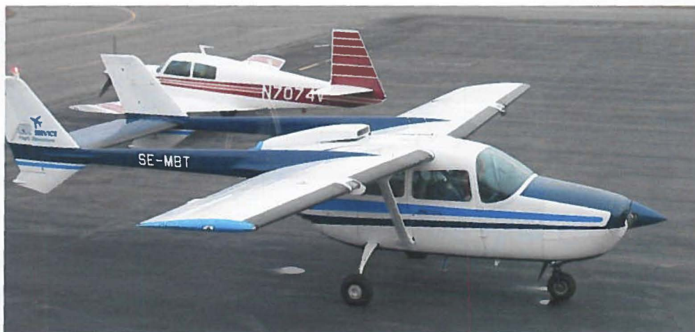
Den bagerste motor er startet. Der er kun dør i højre side af kabinen. Vingerne har gummi-forkanter. (Foto: Niels Löhde Nielsen via Troels Hansen)
