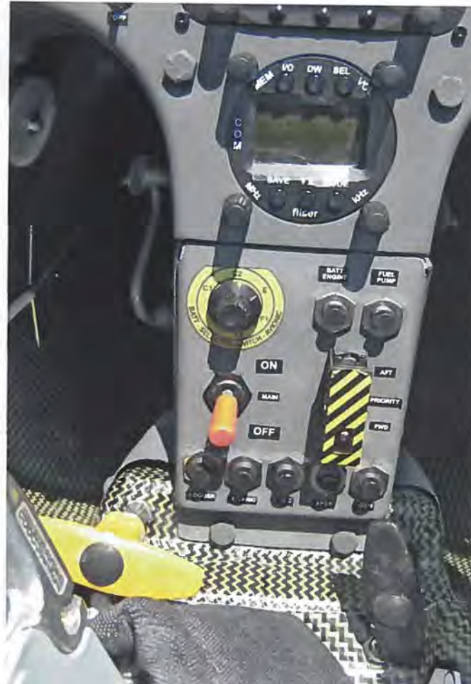
En kontakt med gul afdækningsklap i den forreste instrumentmidterkonsol gør det muligt at overføre motorkontrollen til det bagerste sæde.
