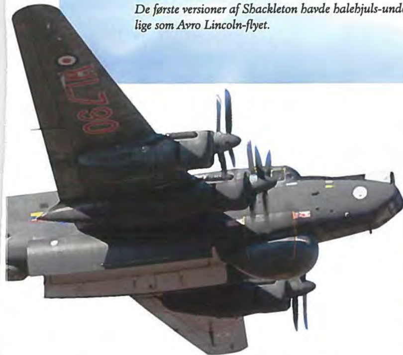
Avro Shackleton med åben bombelem til rummet, hvor flyet bl.a. havde plads til miner, torpedoer og diverse lugte- og lytte-bøjer.
