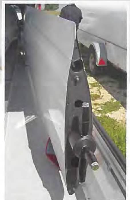
Den yderste ende af vingen, der er blevet væsentligt lettere grundet kulfiberopbygningen – her med påsat bæregreb i stedet for den yderste vingedel med vingetippen. Dette giver god håndtering.
