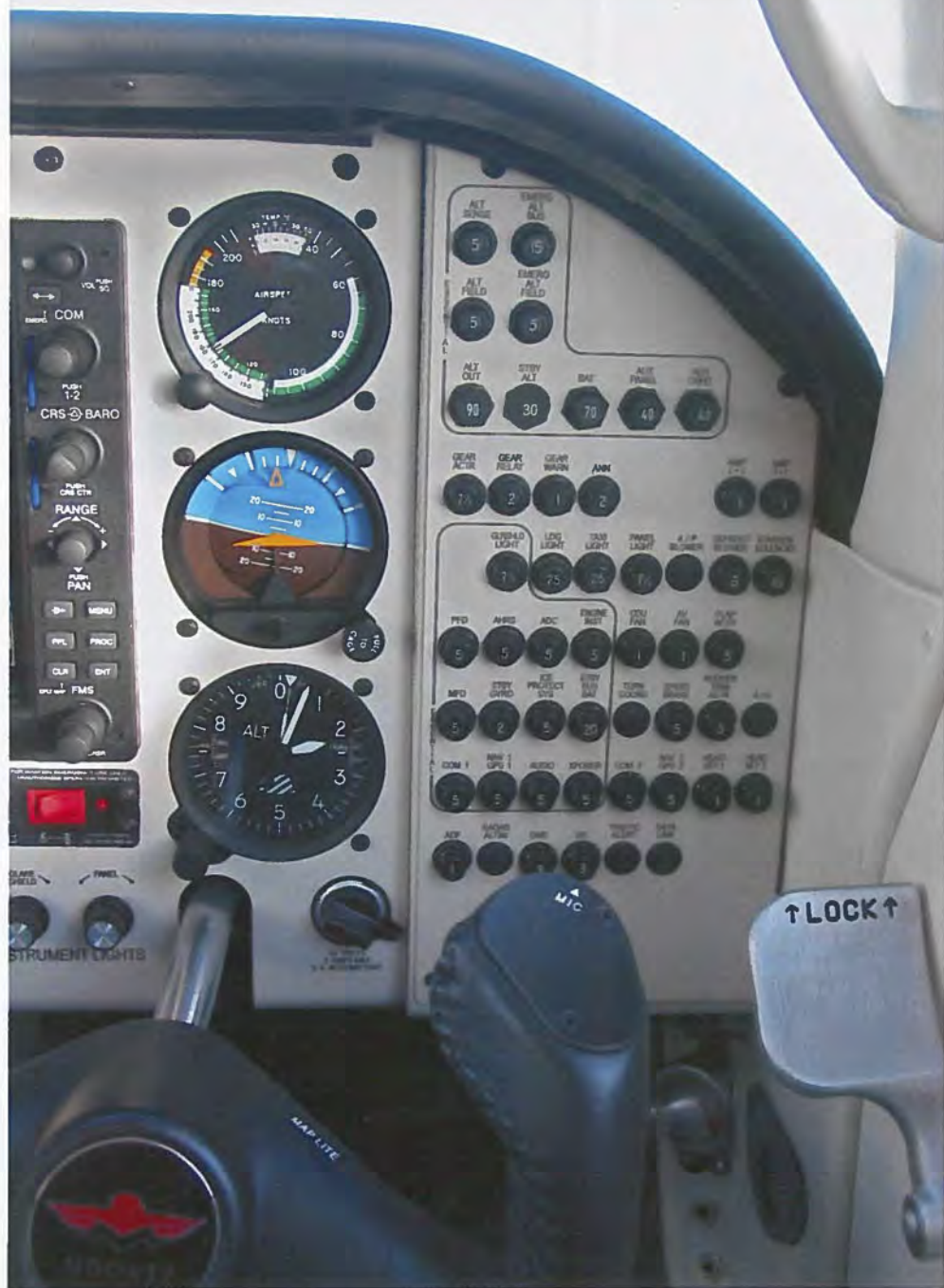
De tre stand-by instrumenter er placeret i panelets højre side sammen med sikringerne.
