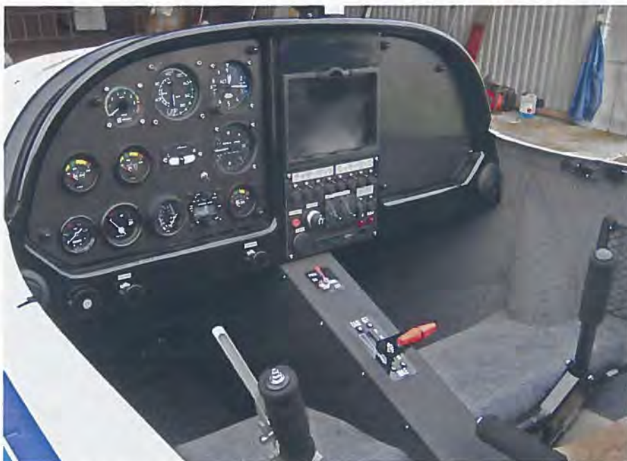
Cockpittet i OY-9363 er helt traditionelt indrettet – dog med holder til GPS'en. Instrumenterne er analoge, men mange nye UL-fly instrumenteres med EFIS-teknologi (Electronic Flight Information System).
