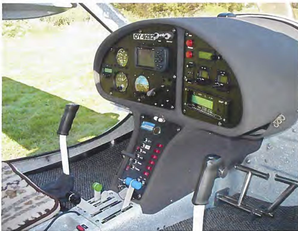
Flyet har to styrepinde, og gashåndtag, trim og hjulbremse sidder i konsollen i midten. På de nye typer, er trimbåndtaget erstattet af et trimhjul.
