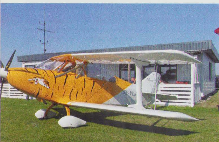
Fk12. FK Lightplanes producerer denne Fk 12 Comet med Rotax-motor. Vingerne kan foldes bagud (max. bredde 2,42 m) så flyet kan transporteres på en trailer.
