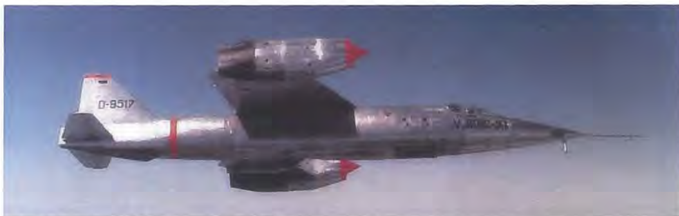
VJ-101 C fotograferet under første-flyvningen med fire af de i alt seks motorer tilsluttet.
