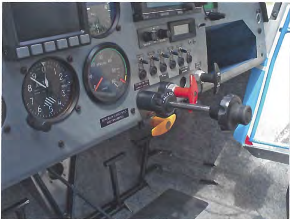
Udløserhåndtaget til slæbekoblingen sidder lige under gashåndtaget
