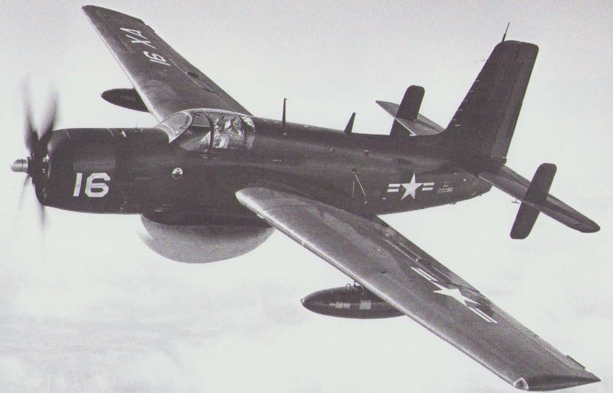
»Hunter« -versionen med den store radarkuppel under bugen af kroppen.
