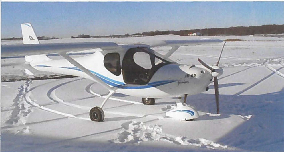
Hjulskærmene er taget af hovedhjulene på grund af sneen. Luftindtagene på oversiden af motorhjelmens forsvinder på den næste udgave af Junior'en.
