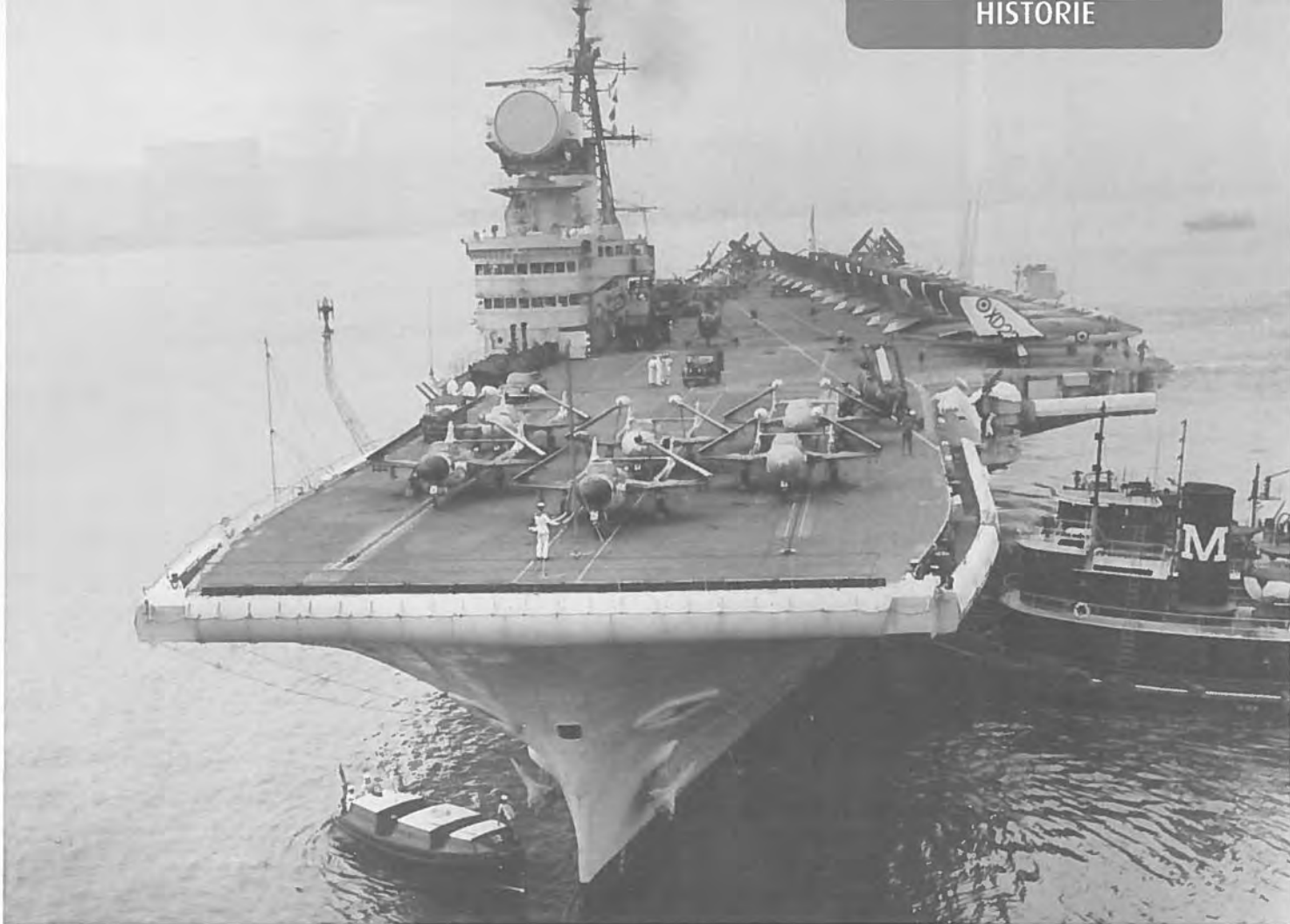
Her står en stribe Sea Venoms med foldede vinger parkeret forrest på hangarskibsdækket.
