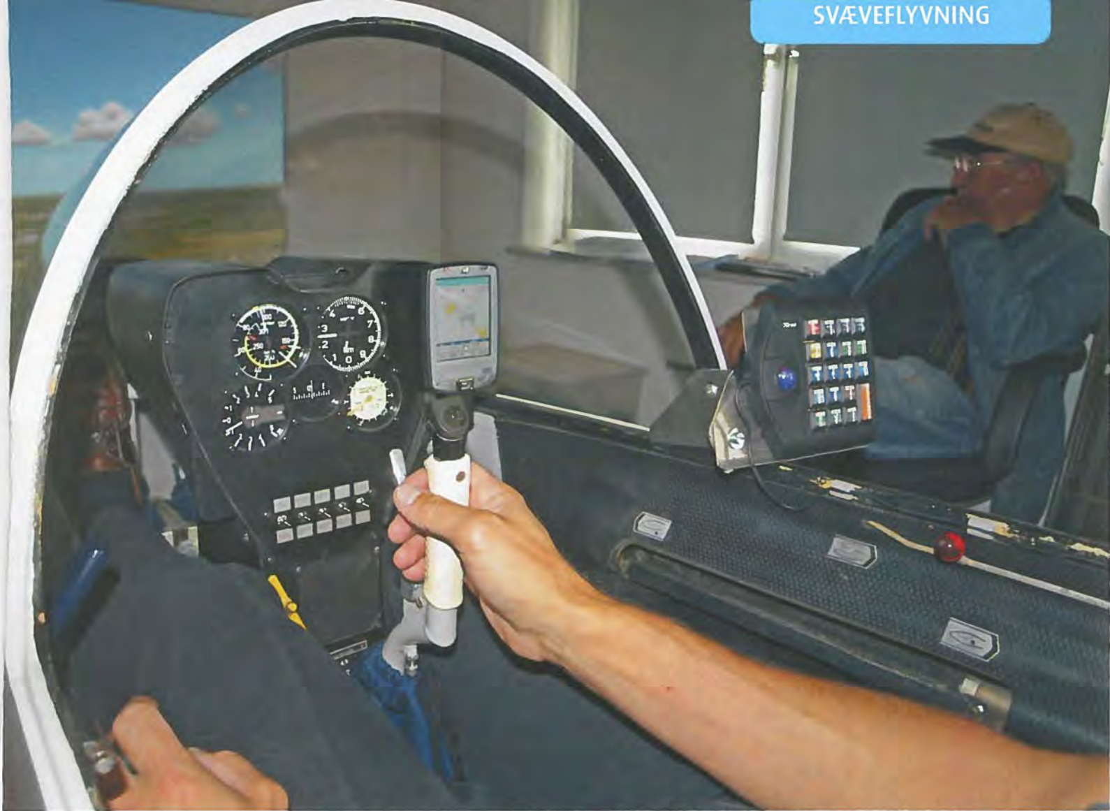
Cockpit med instrumentpanel og PDA. Med det lille tastatur ude til højre kan man styre alle funktionerne i Condor. Tastaturet kan flyttes på siden bag piloten, så instruktøren betjener det.
