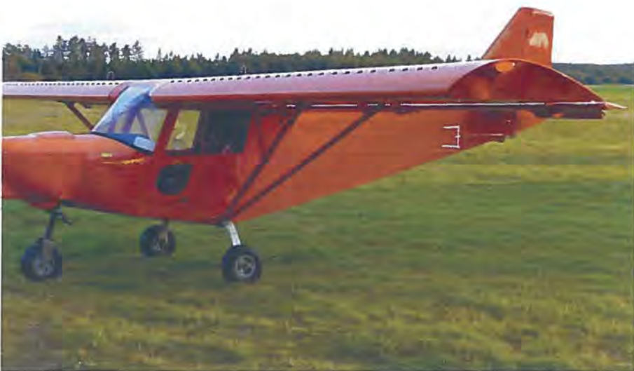
Holstebro Svæveflyveklubs nye Savannah med vortex generators på oversiden af vingen. Det er ikke en fejl, at flyet mangler registrering på siden. Der er alene krav om, at UL-registreringen sidder på undersiden af vingen. De fleste fly har den dog også på flyets bagkrop.
