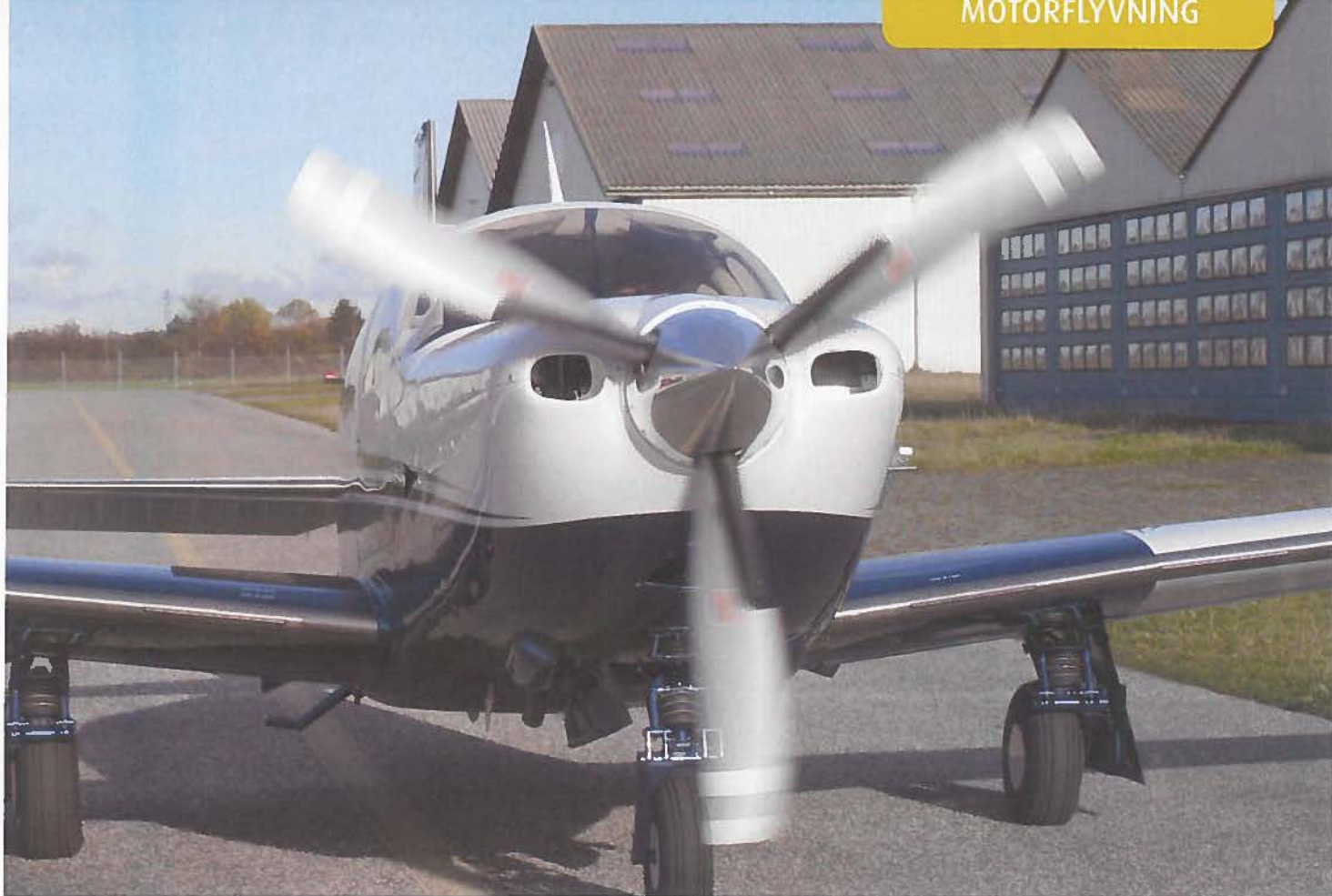
En Hartzell trebladet constant speed propel omsætter motorens 280 hk.
