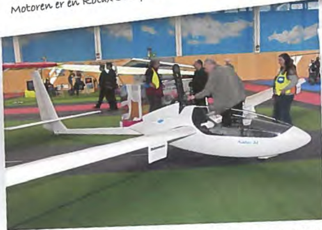
Alatus-M, der er fremstillet i Frankrig, er en UL-motorsvæver i compositmateriale. Flyet fås med en totaktsmotor på 20 hk eller en el-motor på 26 hk. Max. vægten er 235 kg, spændvidden 13,10 m. Flyet kan pakkes sammen og transporteres på en bil. Prisen er med el-motor Euro 35.702 inkl. transportovertræk ( www.randkar.fr ).
