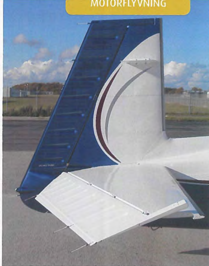
Alle Mooney'ers karakteristiske haleplan. På både den vertikale og horisontale forkant ses TKS afisningsystemet.
