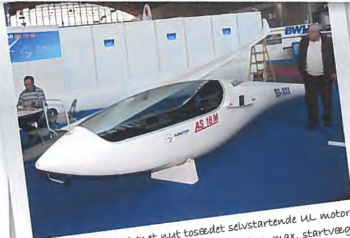
Alatus-M, der er fremstillet i Frankrig, er en UL-motorsvæver i compositmateriale. Flyet fås med en totaktsmotor på 20 hk eller en el-motor på 26 hk. Max. vægten er 235 kg, spændvidden 13,10 m. Flyet kan pakkes sammen og transporteres på en bil. Prisen er med el-motor Euro 35.702 inkl. transportovertræk ( www.randkar.fr ).
