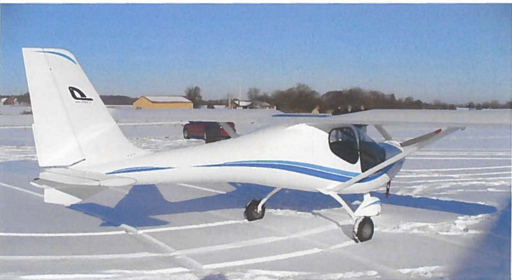
Haleplanet er traditionelt placeret. Junior'en fås for tiden alene med en 80 hk motor, og flyet kan ikke bruges som slæbefly, som er almindeligt ved mange andre UL-fly.
