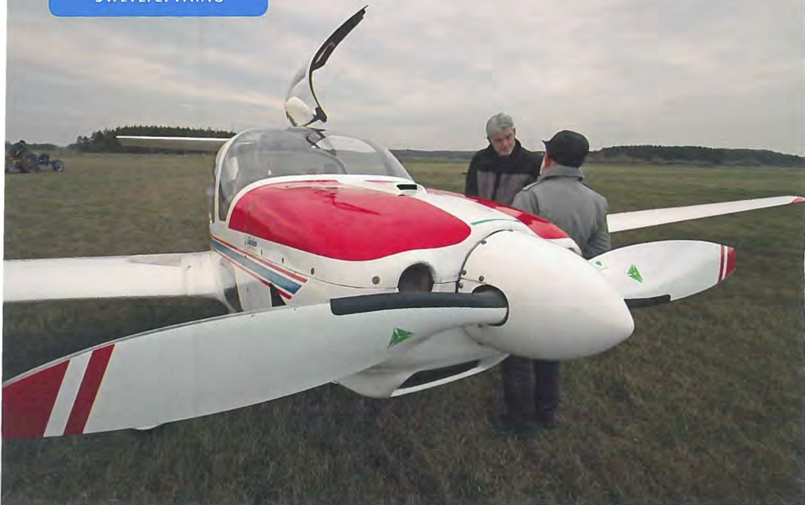
Fremdriften sker gennem en stor MT-propel.
