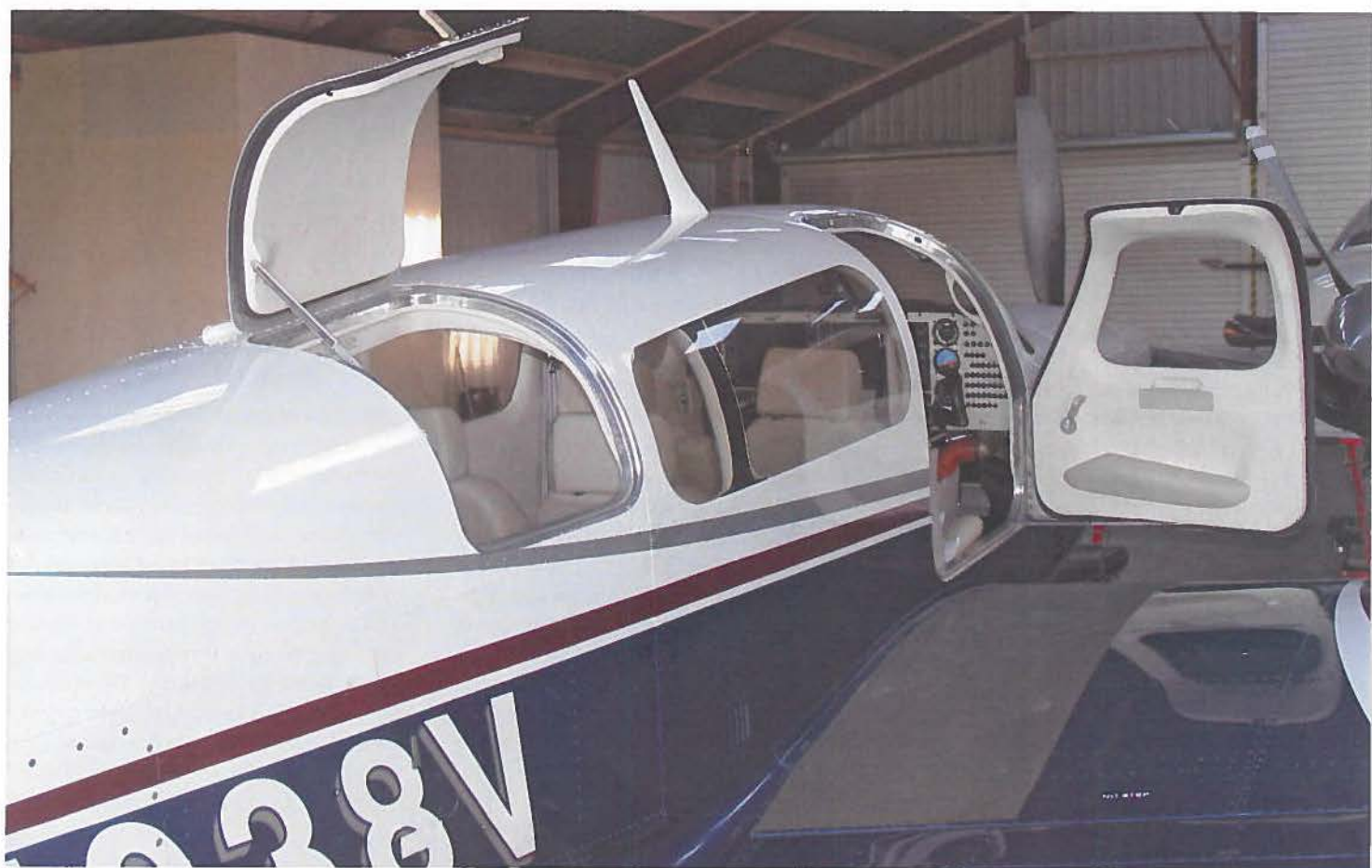
Bagagerumsklappen kan i en snæver vending anvendes som nødudgang.
