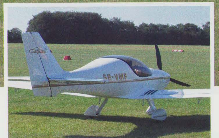
VM-1 Esqual · Lille »jetjager« på svensk register. Flyet er bygget i kompositmaterialer. Flyet har elektriske flaps og mekanisk trim. Man kan vælge mellem Rotax-motor eller Jabiru-motor.
