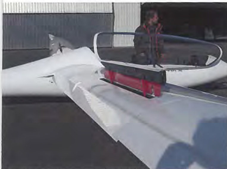
De effektive toetagers Schempp-Hirth luftbremser tager de inderste flaps med via en gastrykcy-linder, hvorved der kompenseres for opdriftstabet.
