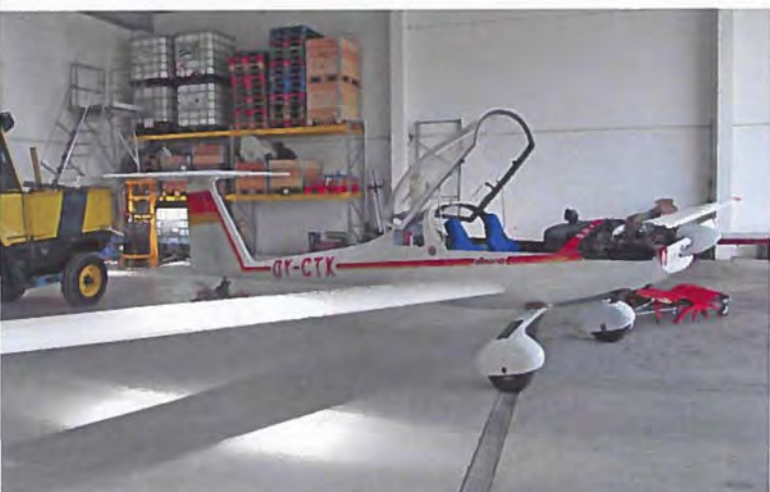
En Hoffmann H36 Dimona motorsvæfely med motorskærmen afmonteret.
