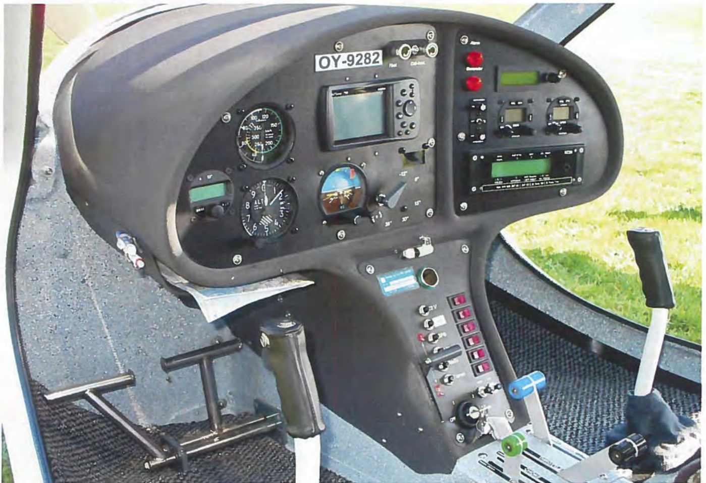
Flyveinstrumenter og autopilot til venstre, og motorinstrumenter og avionics til højre.
