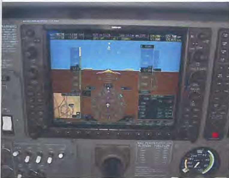
PFD'en samme sted i 6500' med den integreret auto pilot i venstre side af LCD'en.
