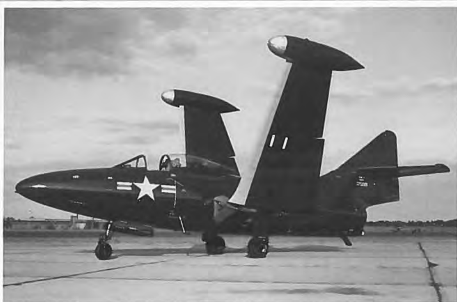
Panther med vingerne foldede. De faste tiptanke betød – mod forventning, at flyet med eller uden brændstof i tankene var eminent til at rulle – også i luftkamp.
