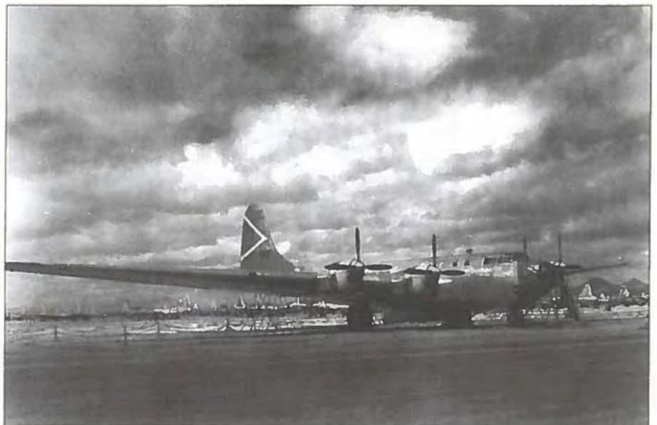
Som fragtfly fik B-19 afprøvet supercharged motorer med firebladede propeller.
