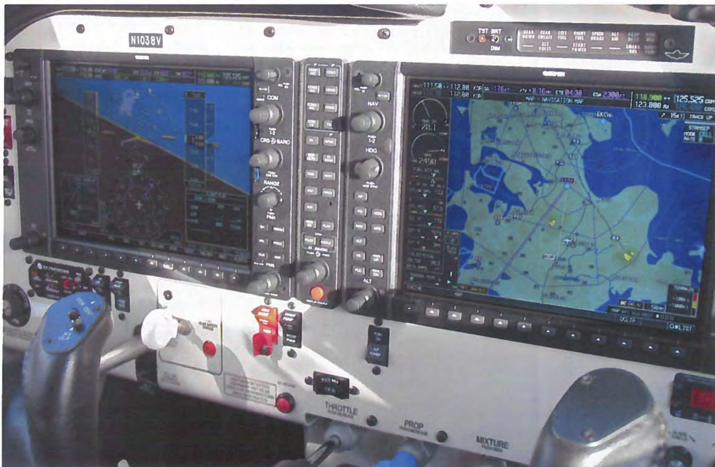
Garmin autopiloten GFC700 betjenes med de flade knapper i den højre skærms nederste venstre hjørne.
