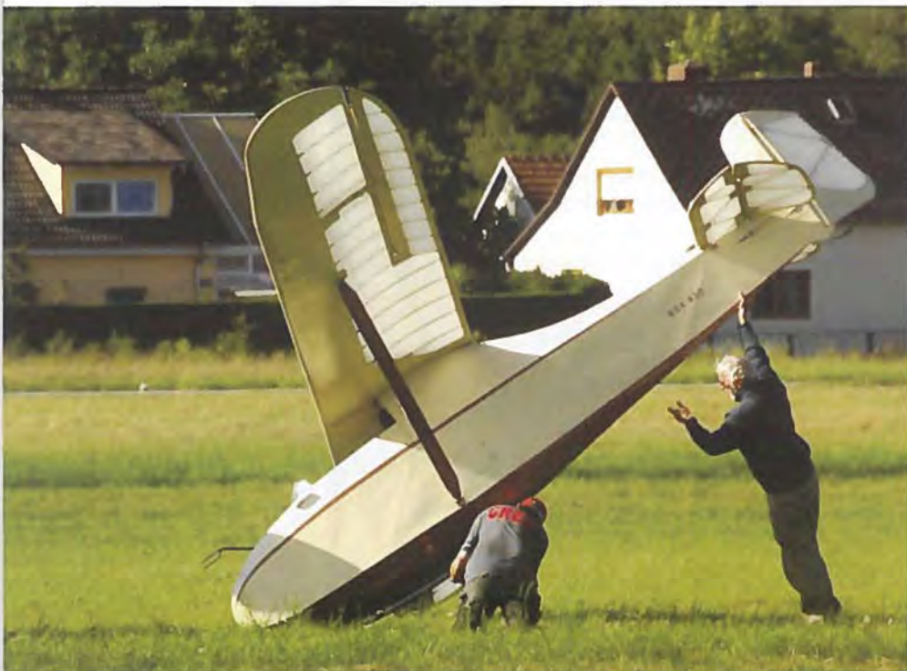
En Hütter 17 vejer ingenting. Man stiller den lige på næsen for at sætte hjulet på til transport.
