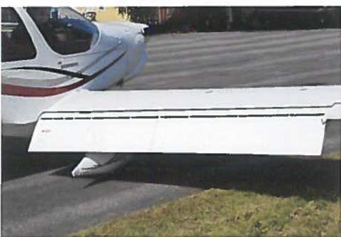
Flaps udfældet i den ret specielle "nødflaps"-setting. Man ser hvor stor flaps'en er og hvordan spaltesystemet er bygget for at give maksimal "blæsning" over flaps'en.
