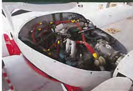
Rotax 912-motoren yder 100 hk og bruger ikke mere benzin end en bilmotor.
