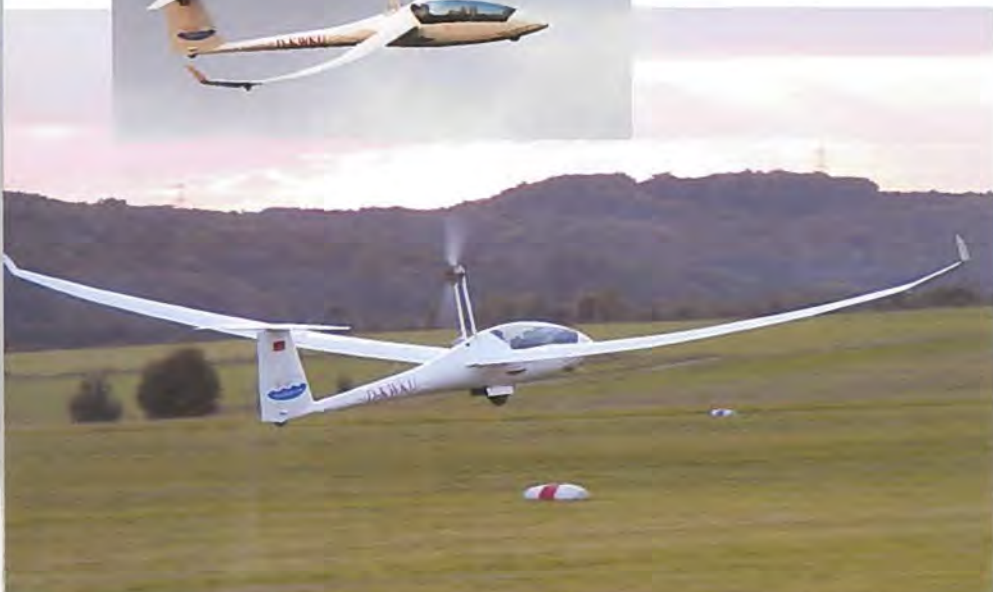
Arcus E flyver nu 2-sædet selvstart på batteripower. Yderst til højre ses den ultrakompakte elektromotor fra Lange Aviation.
