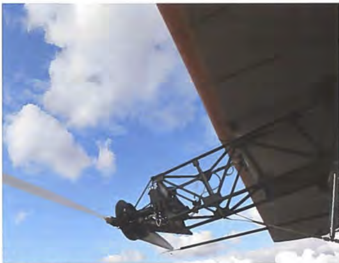
Hver af de i alt 4 motorgondoler huser en 10hk elmotor.
