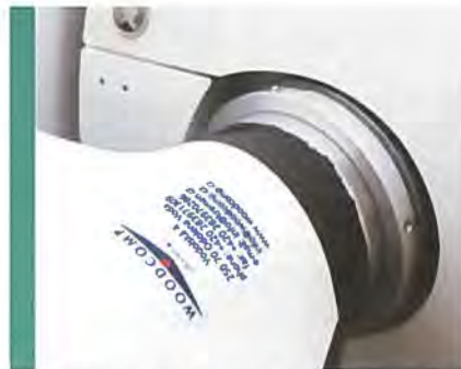
Pipersport kan udstyres med forskellige propelvarianter. Her en to-bladet constant speed
