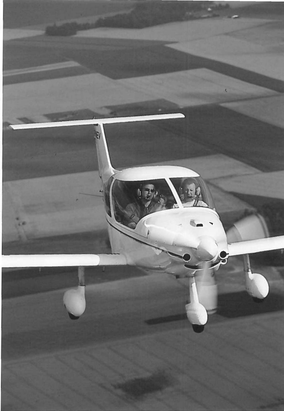
MCR 4S er udstyret med et ret tilgivende understel. For den klodsede eller uerfarne pilot mindsker det risikoen for "hønsning" under landing.
