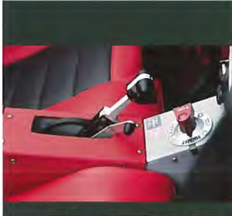
Gashåndtag og fuelvælger er logisk placerede og enkle at betjene.
