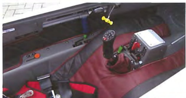
Nydeligt og ergonomisk godt placeret på den venstre kabinevæg: Flapshåndtag (sort), bremseklaphåndtag (blåt) og motor-udsvingshåndtag (gult). På midterkonsollen trim-stillingsviser (grøn) og benzinhane (rød). Trimningen bliver frigivet med det grønne håndtag ved styrepinden.
