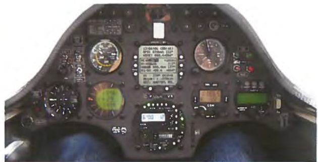
Motorkontrolinstrumentet er centralt anbragt nederst i den midterste opklappelige instrument søjle, hovedafbryderen for motoren helt til venstre.
