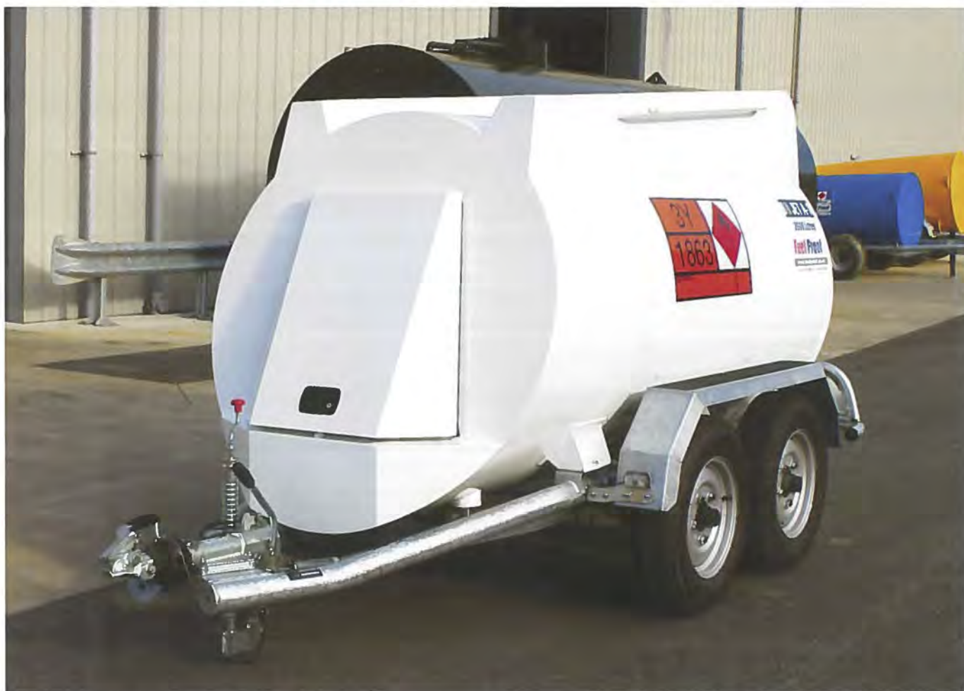
En sådan 999L avgas trailer koster ca. 100.000 kr. inkl. moms. med 12 V pumpe, der kan pumpe 75 l pr. minut. Foto: Fuel Proof Ltd.
