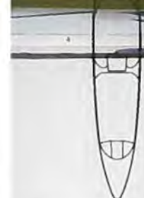
Tre-etagers Schempp-Hirth-luftbremser kombinerer høj bremsevirkning med ringe tab af løft.
