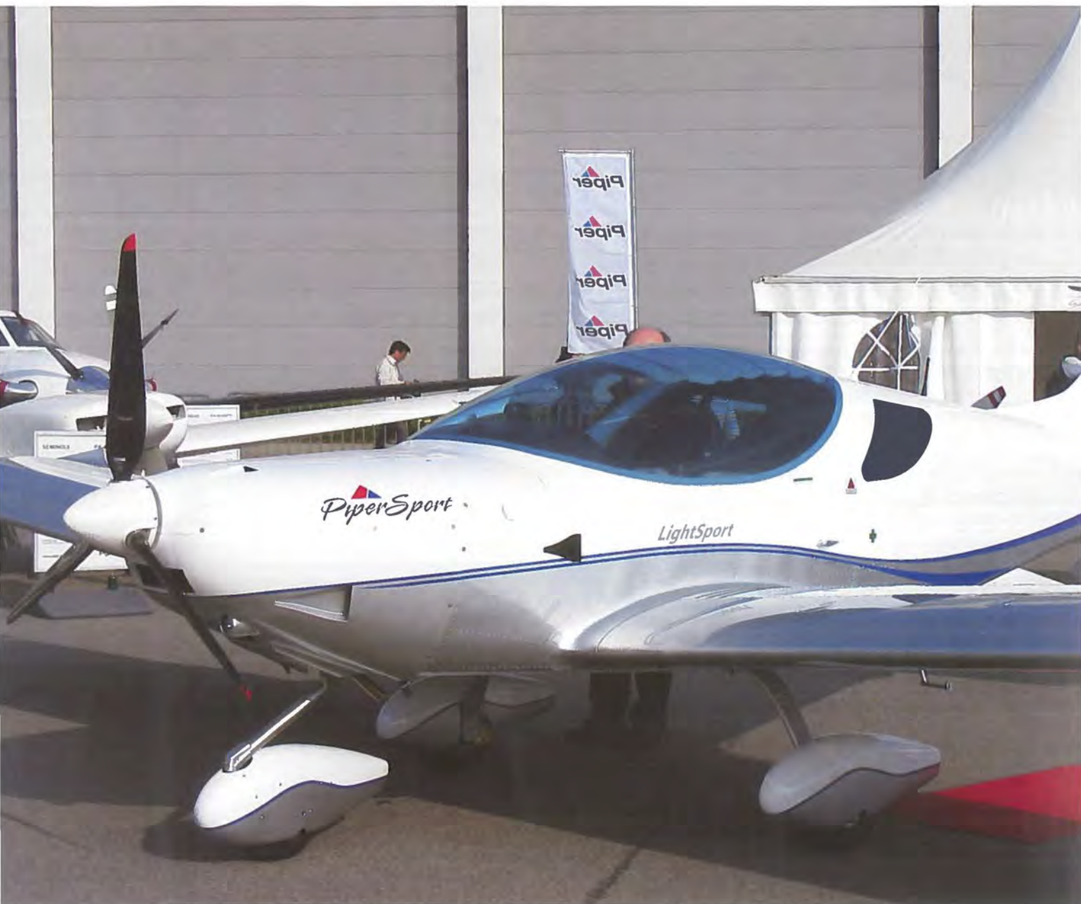
Den trebladede propel trækkes af den firecylindrede Rotax 912- motor.
