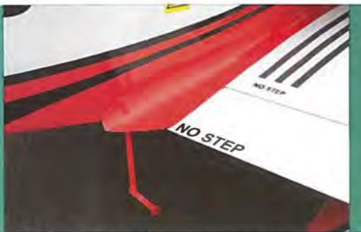
Flaps går helt ind til kroget, og er en potentiel fælde for ukyndige passagerer.
