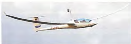
Arcus E flyver nu 2-sædet selvstart på batteripower. Yderst til højre ses den ultrakompakte elektromotor fra Lange Aviation.
