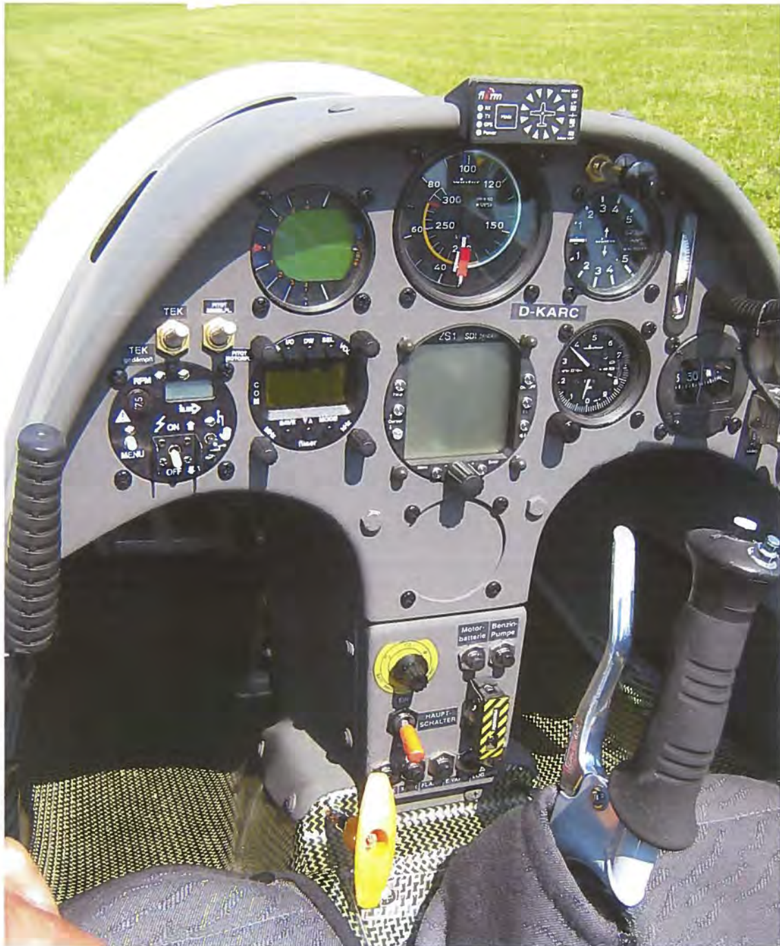
Forreste cockpit byder på masser af plads og er udstyret med en TB06-kontrolenhed til motoren. Man kan overføre autoriteten over motoren til bagsædepilotten ved at benytte den gule guarded switch på instrumentpanelet.
