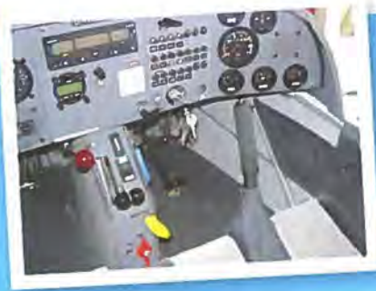
Instrumentbrættet, hvis højre side er trukket en anelse indad i cockpittet gør motorinstrumenterne lette at aflæse. Til venstre ved siden af gashåndtaget (sort) der røde håndtag til sikring af hooden.
