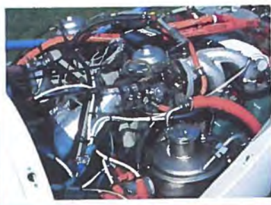
Motoren, som er en Rotax 912 S yder 100 hk og har en fast Mühlbauer-propel
