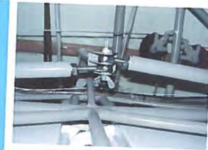
Nem at skille ad: krængerorene forbindes via en bolt med fløjmotrik som sikres med en sikkerhedsnål.
