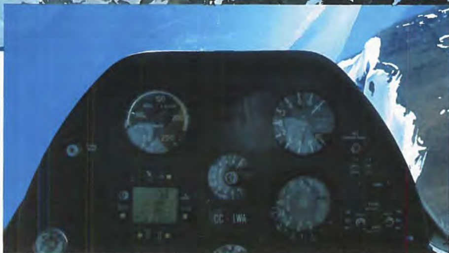
Variometeret viser styrken i termikken helt tydeligt. Bobler på mellem 7 og 9 meter var ikke usædvanlige.
