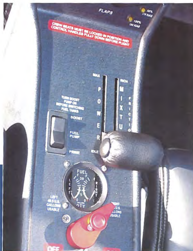
Gashåndtaget, der også styrer propelindstillingen, og tankmåler og tankvælger.
