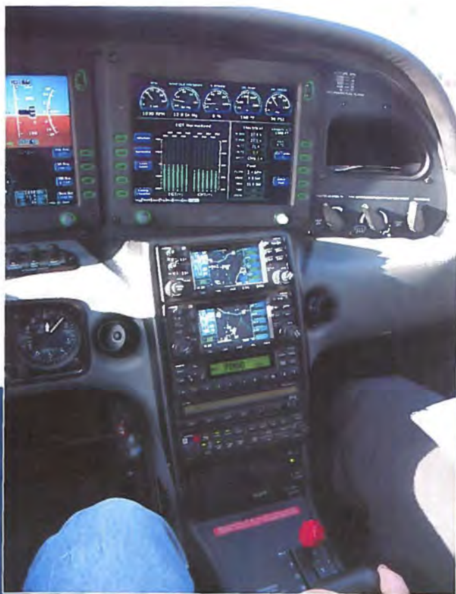
MFD og midterkonsollen med to Garmin 430, transponder, autopilot og intercompanel.
