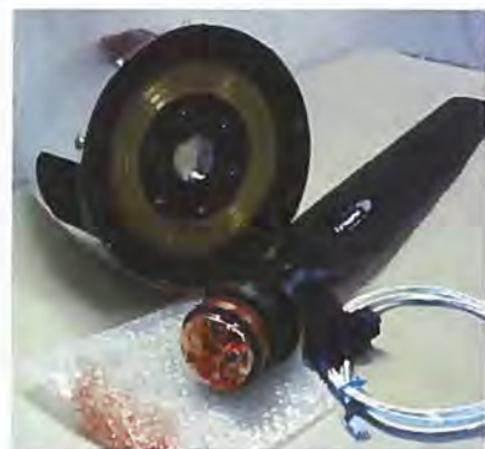
Spinner og et propelblad. Mekanikken der regulerer pitchen på de tre propelblade er indbygget i spinneren, som på den indvendige side er forsynet med tre cirkulære kontaktbaner der via tre kontaktkul får spænding fra kontrolenheden.
