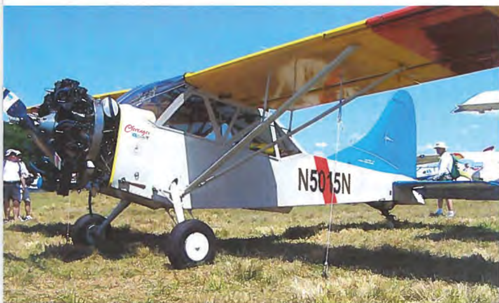
Meget modificeret Stinson L-5. Den oprindelige Lycoming på 185 hk er erstattet af en 7-cyl. Continental på 220hk, og for at holde tyngdepunktet er Stinson'en blevet noget kortsnudet.
