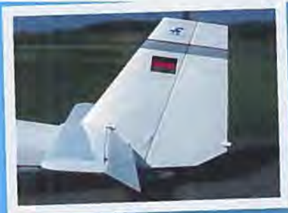
Sideroret er udformet således at det ikke kommer i karambolage med slæbetøvet.
