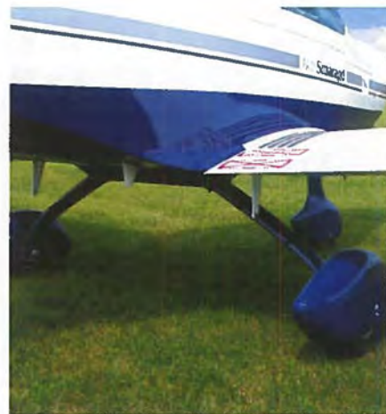
Understellet er en kulfiberbøjle, og hjulene har hydrauliske bremser.
