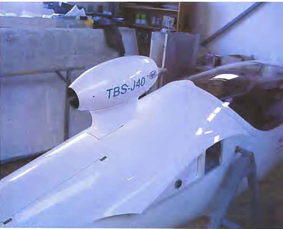
H 304 S Shark kroppen med jetmotoren.
