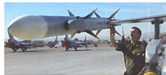
Et AMRAAM missil bliver inspicieret inden flyvningen. I højre side af billedet ses et AIM-9 missil.
