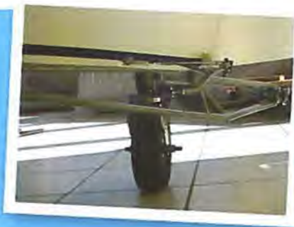
Slæbekoblingen er fæstnet med tre skrue og er let at montere. Halehjulet er koblet direkte sammen med sideroret.
