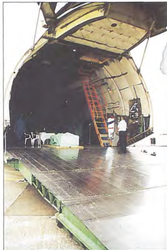
Rampen kan foldes hydraulisk samtidigt med at næsehjulene »knæler« for at mindske lastehøjden. Den røde stige fører op til cockpittet på første sal.
