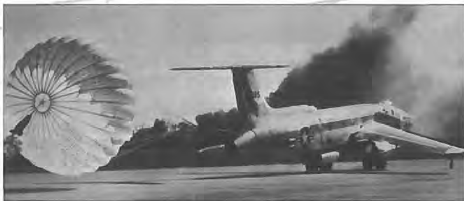
En stor bremsefaldskærm var standard for at mindske landingsafløbet.
