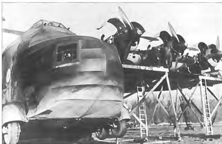
Mekanikerne arbejder med Gnome-Rhone motorerne på en Gigant. Bemærk mundingen af 20 mm kanonen i næsedøren og de løftede forhjul fra det fem-dobbelte understelsben, som tyder på, at der er fuld last indenbords.
