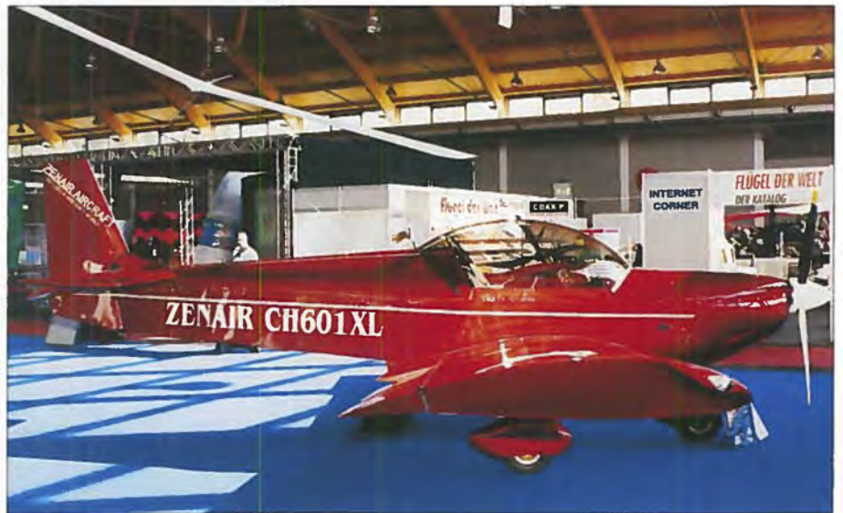
CH601 XL er en helmetal konstruktionen med fast understel.
