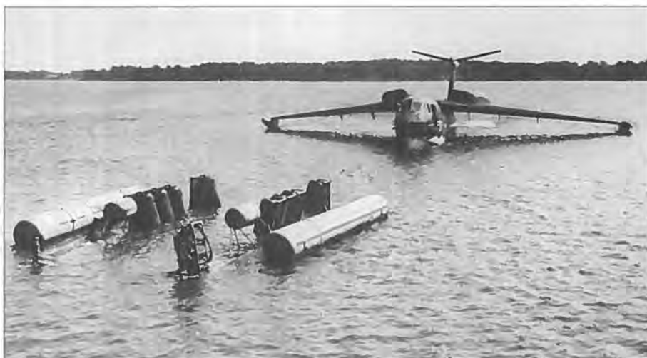
Et specielt beaching-gear gjorde det muligt at køre Seamaster helt op på land.
