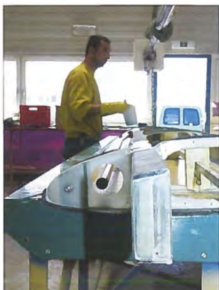
Skelettet til en vinge. Man kan se, at tværbjælken er opbygget af mange lag glas- og kul fibre. Ribberne er også lavet af fibermateriale. Hvert fly har to gennemgående tværbjælker i vingerne.
