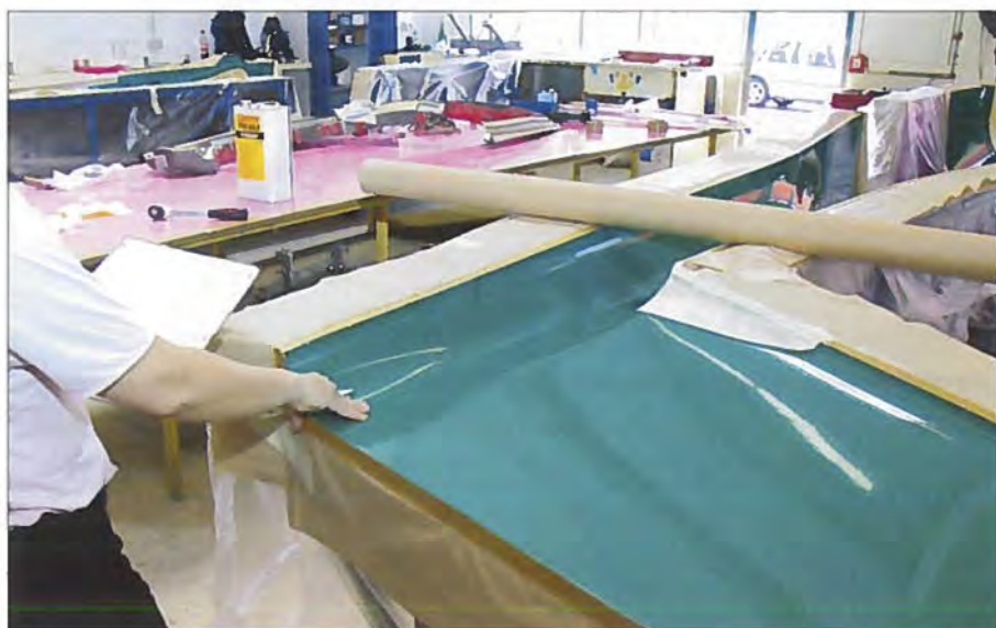
Hele siden af flyet støbes i en sammenhængende form. Nærmest ses det, der bliver til bageste ende på flyet. I formen lægges måtterne af glasfiber lag på lag, der påføres epoxy og øverst lægges et tætsluttende lag af folie. Dernæst påføres vacuum, der sikrer hærdning under et ensartet tryk.
