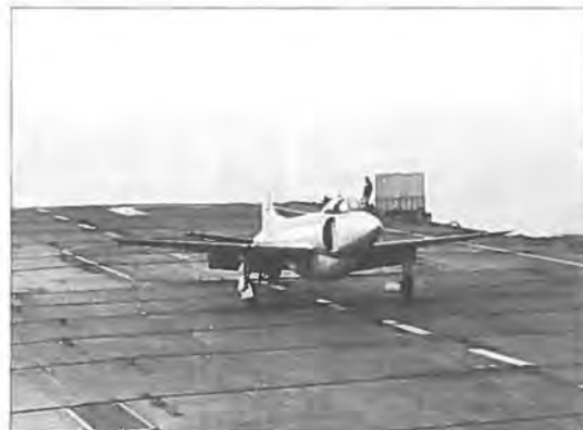
Attacker havde halehjulsunderstel og var derfor særdeles krævende under landingerne på et hangarskibsdæk.
