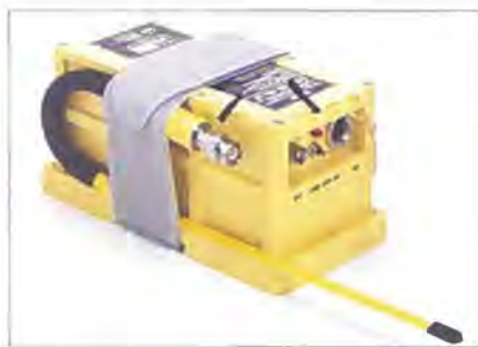
ELT med ekstra antenne.
