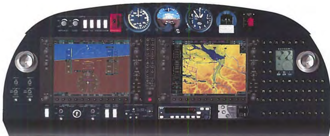
DA42 Twin Star udstyres med Garmins nyeste glascockpit G1000.
