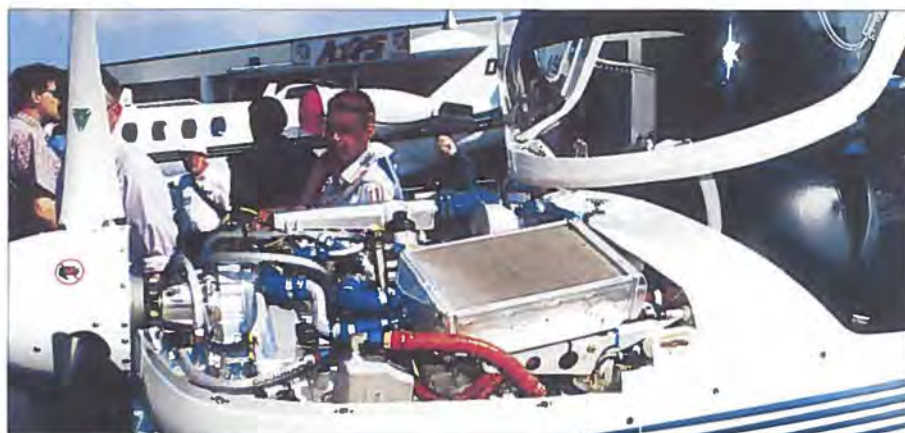
Thielert dieselmotoren monteret i en DA40 TDI. Foto: Knud Larsen.
