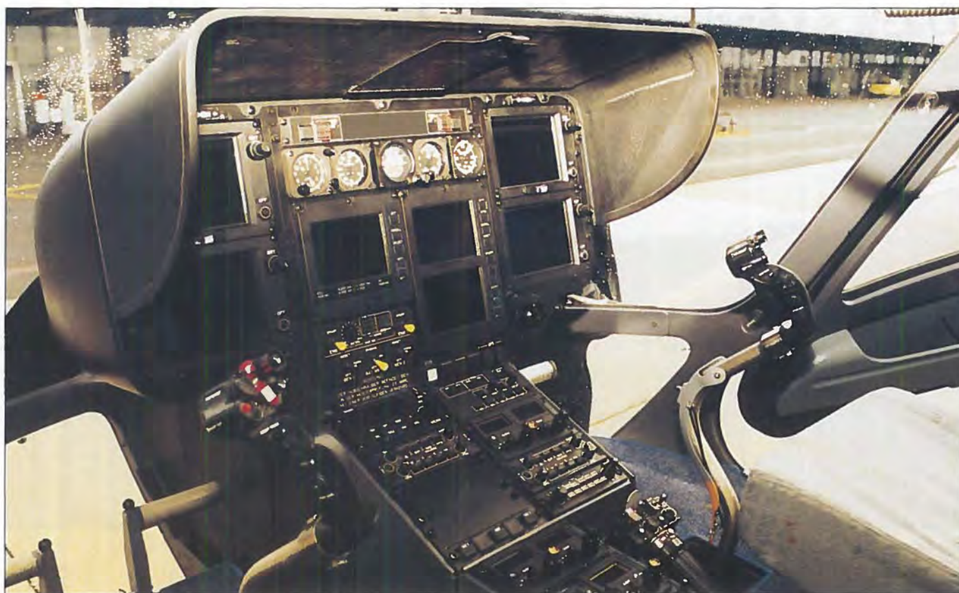
EC145 er udstyret med glascockpit (sorte skærme når der ikke er strøm på flyet). Øverst ses stand-by instrumenterne.
