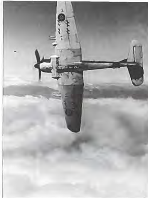
Firebrands bevæbning var foruden torpedoer også raketter samt fire 20 mm kanoner.
