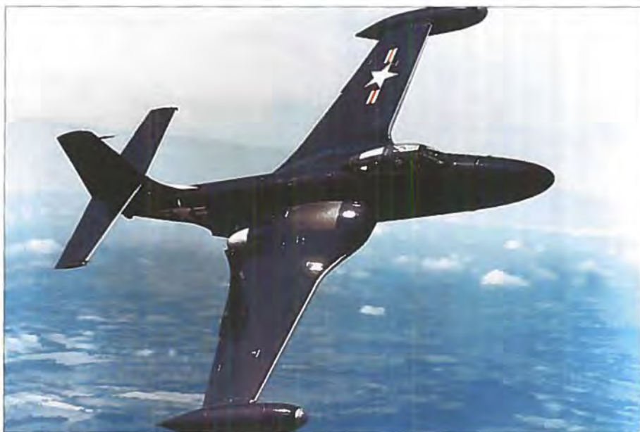
De to forslugne Westinghouse J34 fik brændstof fra tiptankene og fra store center-tanke bag cockpittet.
