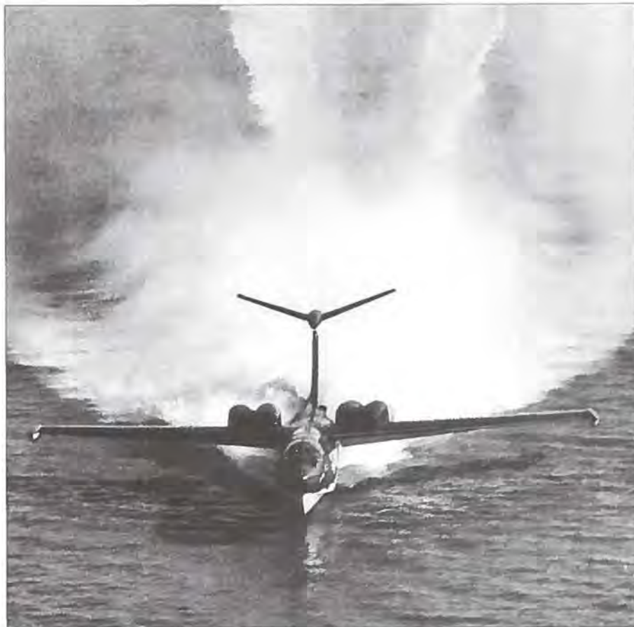
Seamaster havde fire jetmotorer med efterbrændere, der sikrede en stor starthastighed.
