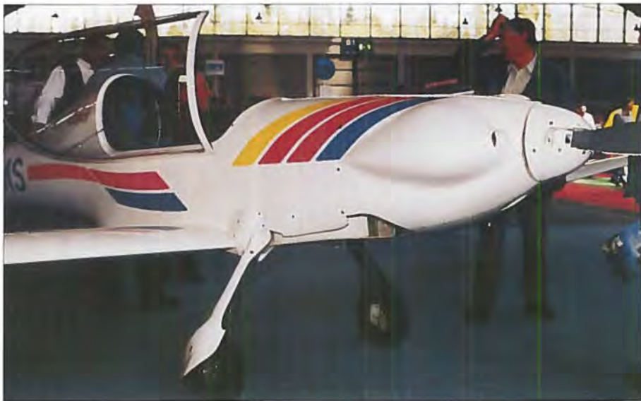
AMS Carat har hydrauliske skivebremser på hovedhjulene.
