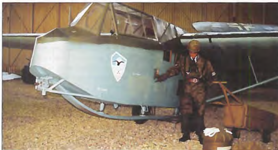
Den tyske lastglider DFS-230A fra Anden Verdenskrig kunne medføre pilot og ni soldater. Flyet er udstillet indendørs.
