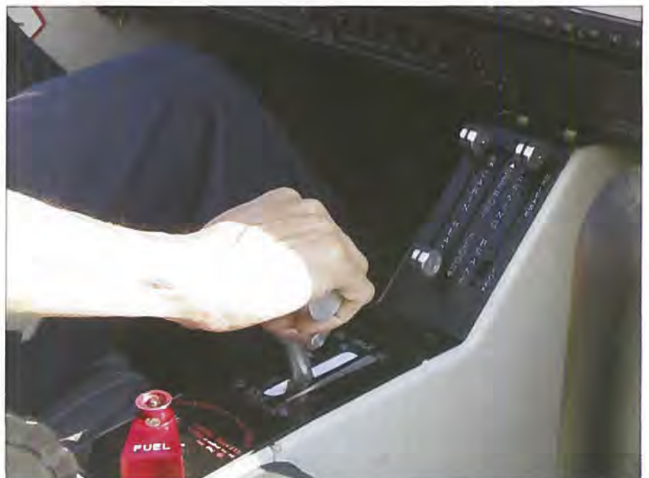
Et enkelt håndtag styrer både throttle, mixture og propelomdrejninger. Systemet kaldes FADEC (Full Authority Digital Engine Control).
