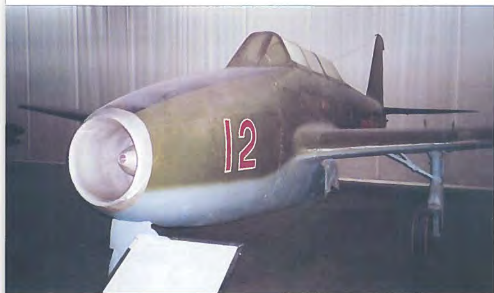
På et tidligt tidspunkt efter anden verdenskrig havde kineserne russiskbyggede Yak-17UTI i tjeneste som tosædede jetskolefly. Det ses tydeligt, at motoren i Yak-17 er udviklet fra den tyske Jumo 004 på den lille ring i næsekonussen, som bruges til at trække den lille totakt startmotor i gang med.
