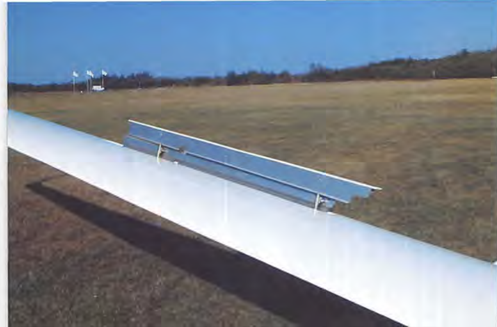
De meget effektive dobbelte Schempp-Hirth luftbremser.
