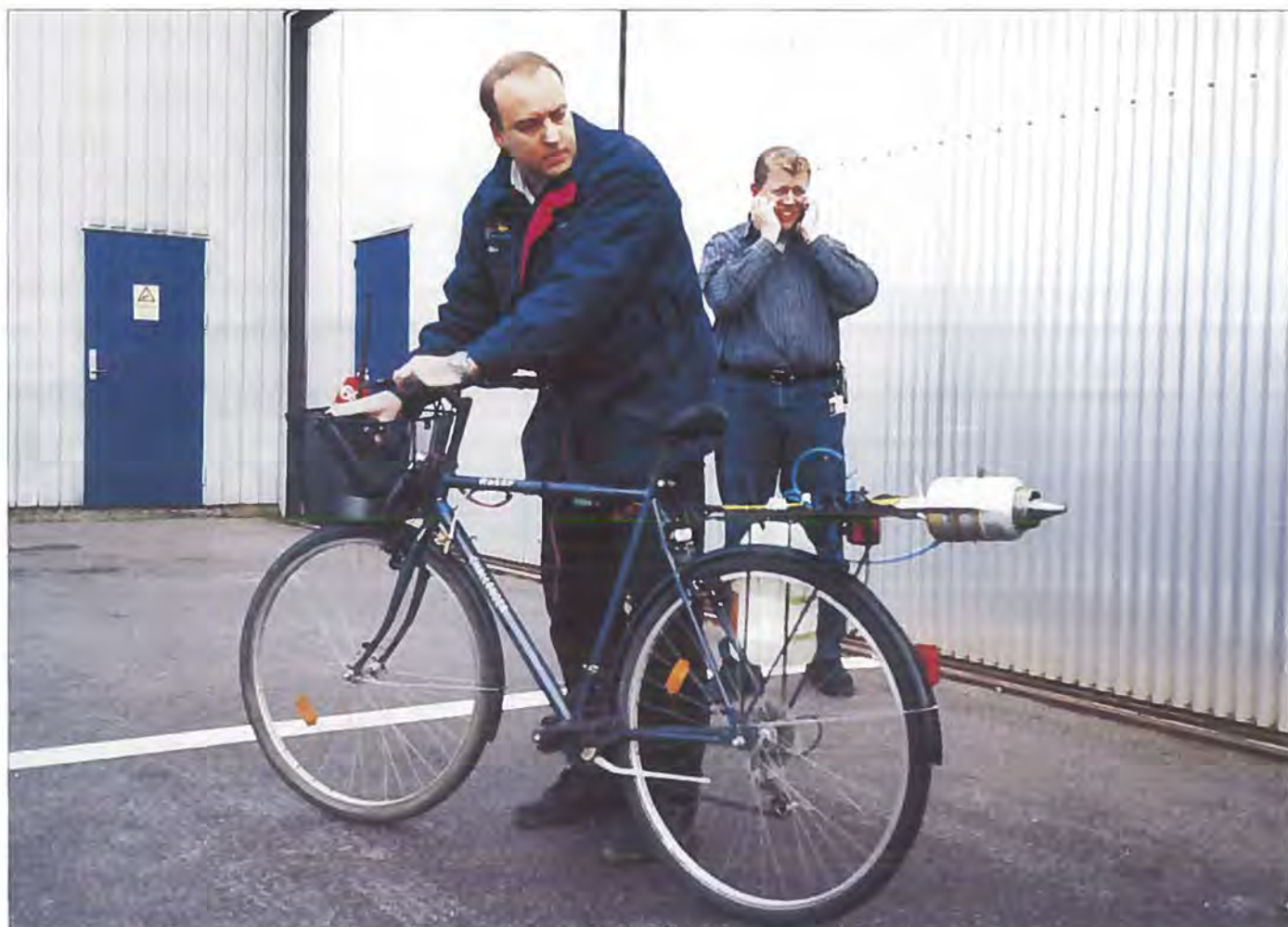
Forfatteren er klar til testkørsel. Fjernstyringsenheden i cykelkurven, brændstoffunken på højre side af bagagebæreren og motoren bagerst. Foto: Knud Larsen.
