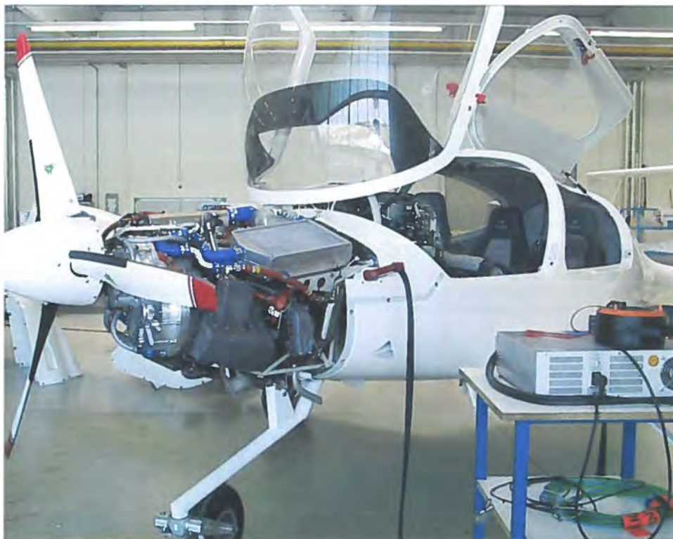
Den næsten færdige Diamond Star DA 40 står klar. Nu er motor, elektronik og interiør på plads. Men der venter stadig en stribe afprøvninger af motoren, instrumenterne og ikke mindst flyveegenskaberne, før den er klar til at flyve fra reden.
