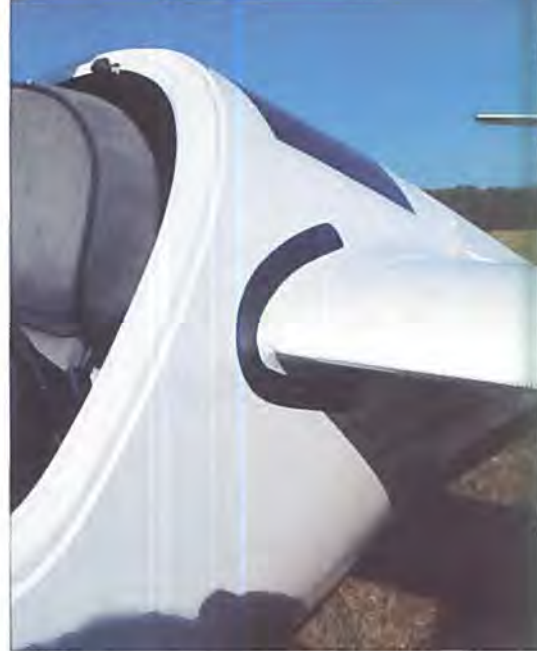
DG-808B har flot integrerede flueskrabere som her ses i lukket position.
