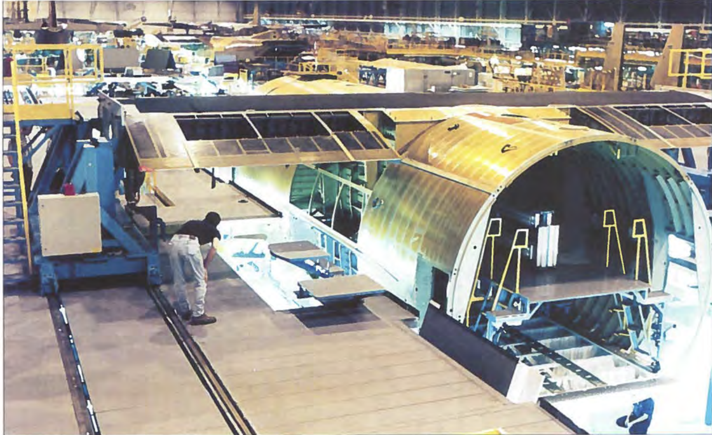
Kroppens centersektion bliver samlet til centralvingen på et ret tidligt tidspunkt i produktionen. Hullerne i vingen bag den bageste hovedbjælke er brøndene til redningsflåderne.
