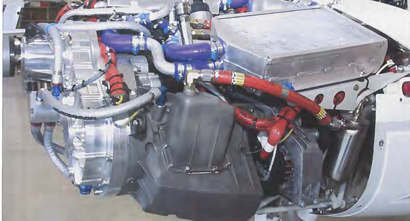
Motor med kølere til det væskekølede system. Desuden ser man fortil reduktionsgearet fra motor til propel.
