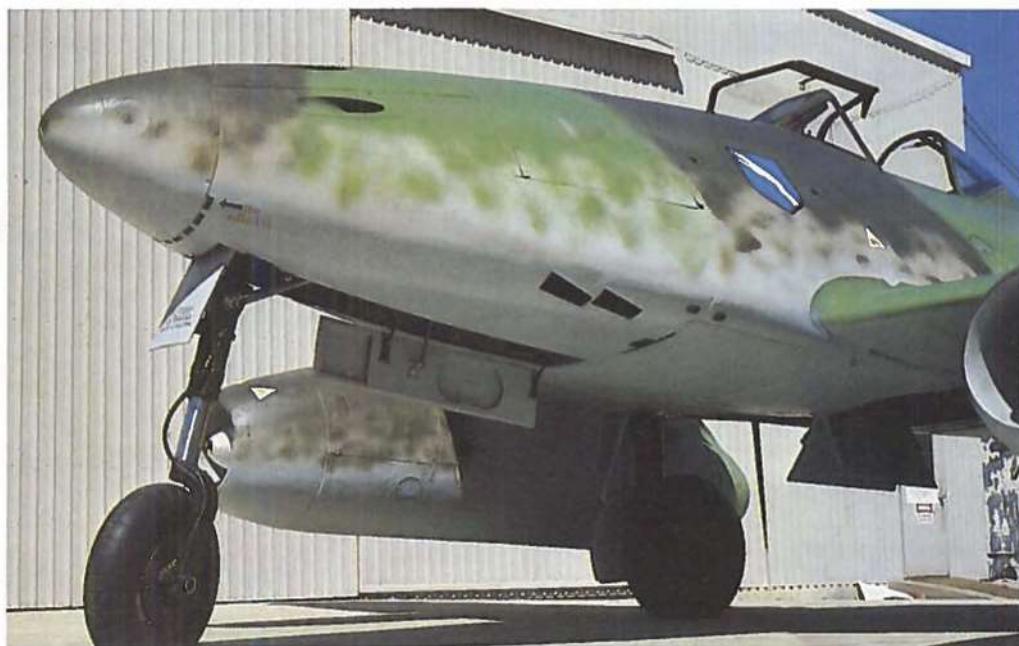
Det store næsehjul og den brede, flade »haj-næse« var meget karakteristisk for Me 262 med tilnavnet »Schwalbe«.
