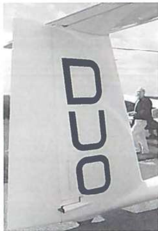
Halefinnen med 9 liters hale-tank og dertil hørende indikeringshuller.
