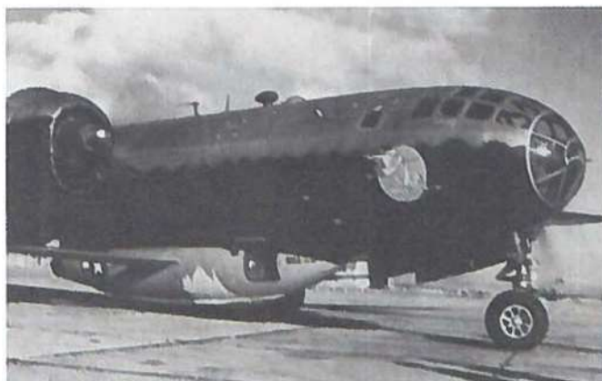
Raket-flyet blev båret op i operationshøjde, ophængt under bugen af en Boeing B-29 Superfortress.
