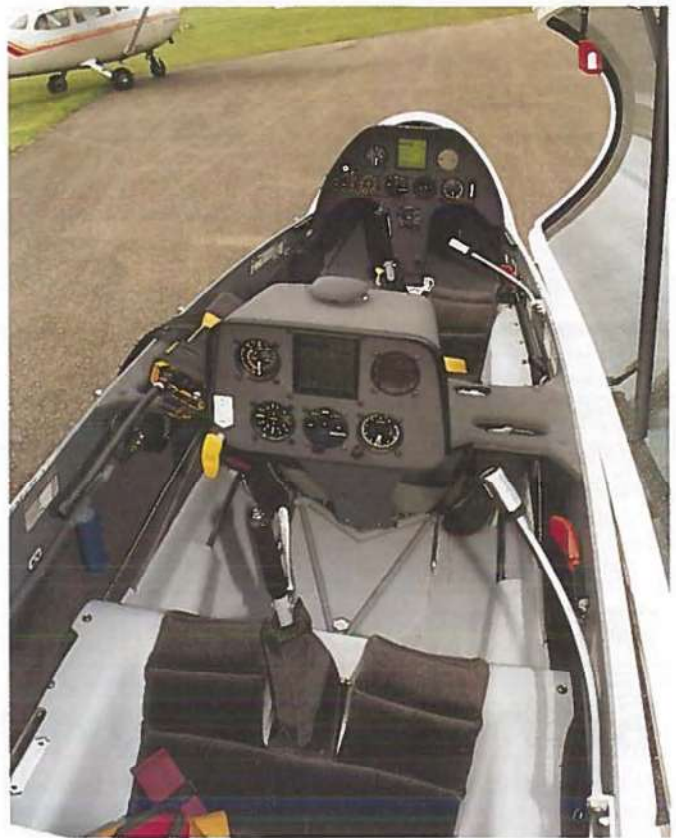
Ved siden af instrumentbrættet til det bageste sæde ses »håndtag« til hjælp ved ind- og udstigning.
