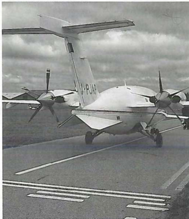
Avantis propeller er fuldt vendbare.
