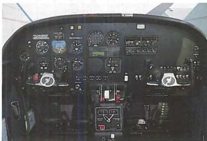
På instrumentpanelet ses i midten GPS-modtager og autopilot, derunder gaspulten og nederst tankvælger og -målere.
