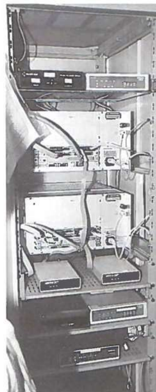
For få år siden skulle der en kælderetage til for at rumme teknikken bag EUROCAT 200. I dag kan den rummes i et skab.
