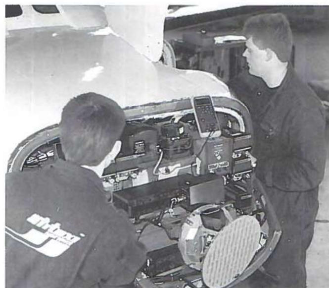
Der udføres service på vejrradaren på en Cessna Citation hos Aalborg Airtaxi Maintenance.
