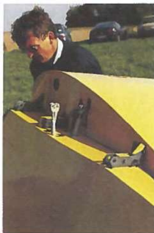
T.v. er højre vinge næsten færdigmonteret, og man ser tydeligt beslag, bolte og rørforbindelser ... og Finn Henningsen.
