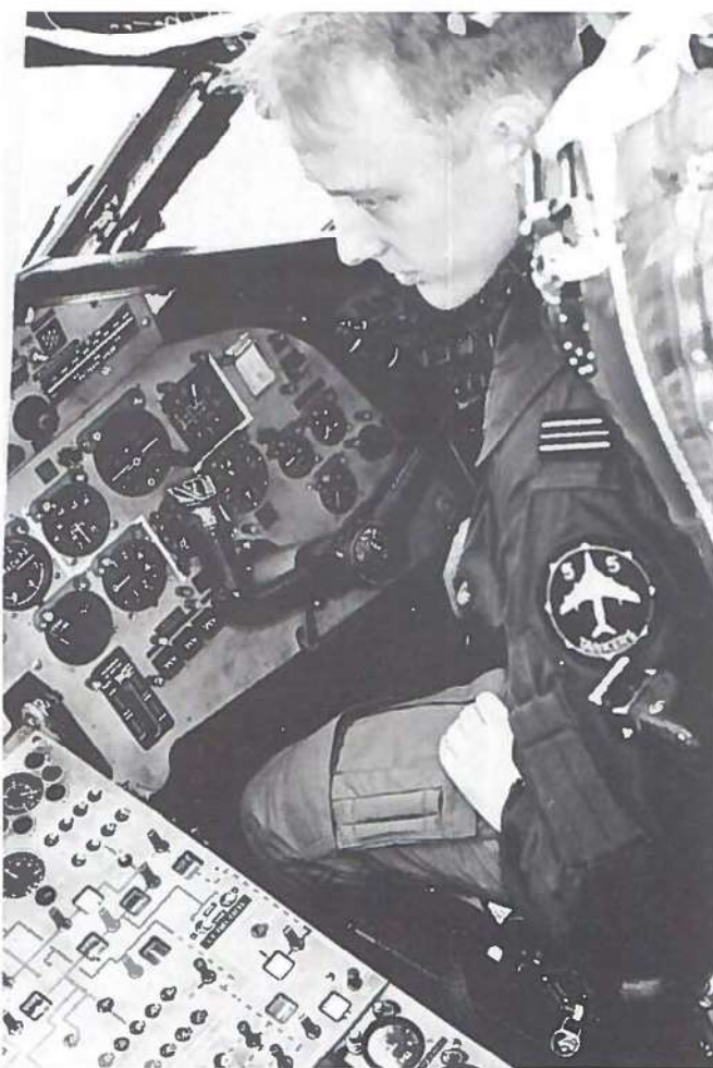
Billede af en del af fuel control panelet, som styrer leveringen af brændstoffet til »kunderne«. Som det ses, er pladsen trang. Det er ikke rart at være 185 cm høj i det cockpit.
