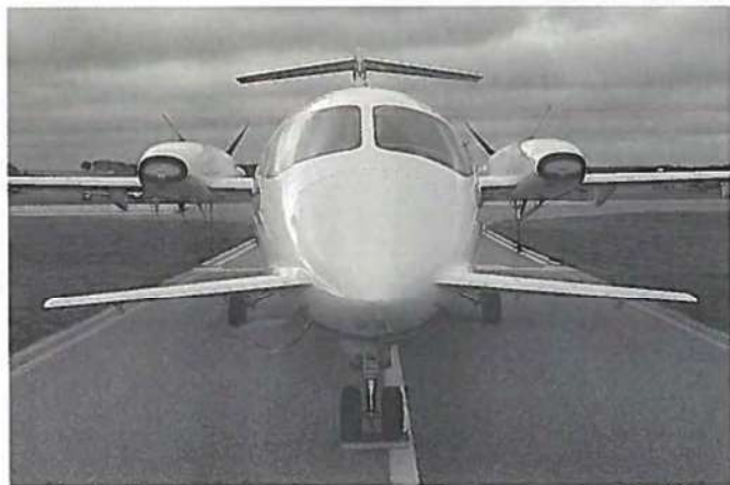
Tre bærende planer: Forvinge, hovedvinge og konventionel T-hale.
