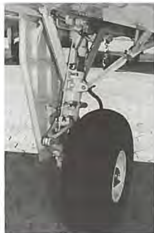
Det kraftigt dimensionerede understelsben i styrbords side.
