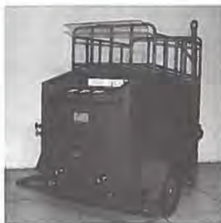
Til det norske flyvevåbens F-16 er leveret et antal af disse 20 kVA, 400 Hz anlæg.
