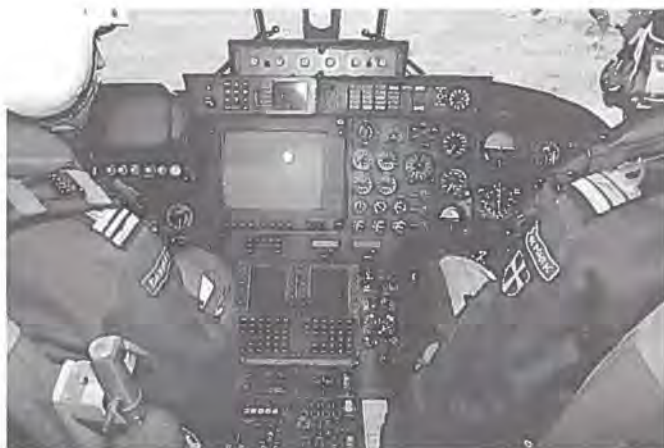
Instrumentlayout i TDS-prototypen S-175, hvor de nye CMS-instrumenter er placeret på brættets centrale del. Nederst de to Control and Display Units ved siden af hinanden og herover det store Tactical Situation Display. Til højre herfor ses motor- og flyveinstrumenter, og til venstre radar- og dopplerinstrumenter. Nederst på midterkonsollen navigations- og radioinstrumenter.
