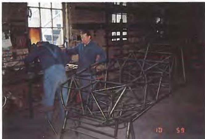
Individuel produktion af utallige rørstumper. Her er det kroppen til en SF 25.
