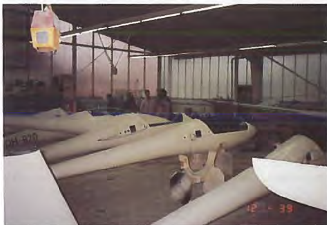
Ved fremstillingen af glasfiberfly ligner det mere en serieproduktion.
