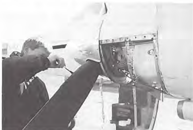
Før afbalanceringen kontrolleres propellens generelle tilstand. Stenslag registreres, heaters efterses og »blade clamps« opsmøres.
