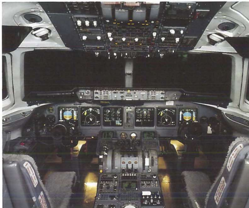
Cockpit instrumenteringen domineres af de seks skærme med flyveinformationer, navigations-data, motor-data og system-data. Over pilotstolene ses panelet for elektricitet, hydraulik, brændstof og airconditionering. Midterkonsollen indeholder radioer og tre Flight Management Systems skærme med tastatur for lateral og vertical navigering.
