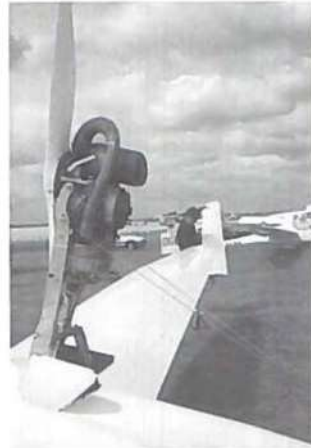
Installationen af Rotax 275 på DG 600.
