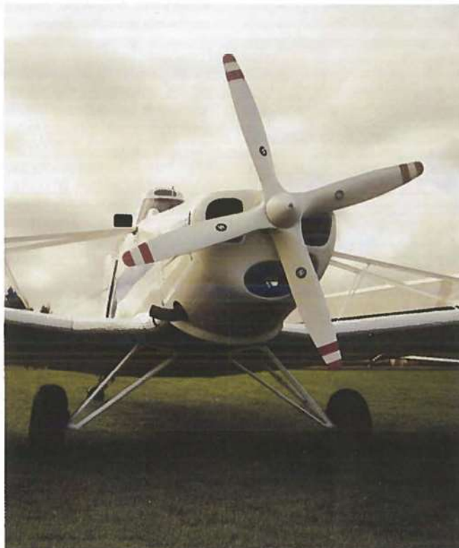
Den 4-bladede Hoffmann-propel har givet Pawnee'en flere fordele i forhold til den originale McCauley. Blandt dem er ikke mindst et væsentligt lavere støjniveau.
