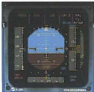
A320 har et såkaldt »glascockpit« med det mest moderne EFIS-panel og ministyrepinde eller »sidesticks«. De små billeder illustrerer en del af EFIS-instrumenternes
