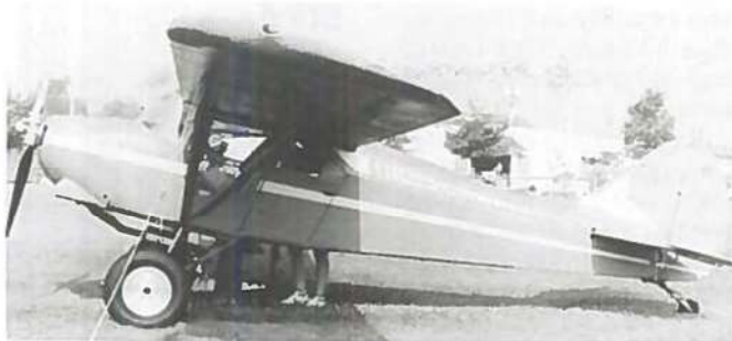
Alaskan Bushmaster udstyret med en 250 hk Mazda bilmotor.
