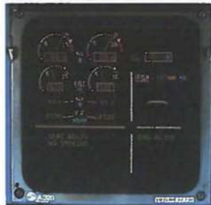
A320 har et såkaldt »glascockpit« med det mest moderne EFIS-panel og ministyrepinde eller »sidesticks«. De små billeder illustrerer en del af EFIS-instrumenternes
