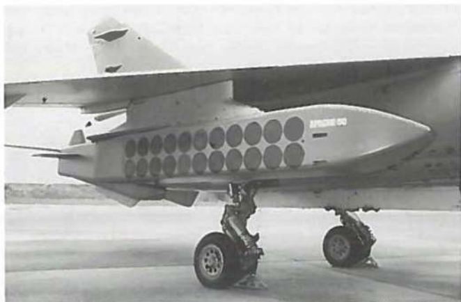
Herover er det Apache dispenser systemet, og til højre ses en special version, der er udviklet af MBB til den svenske JAS 39 Gripen.
