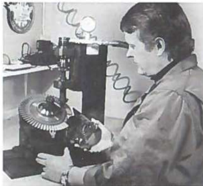
Nitning af turbineblade på CT-disc.
