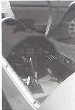
HUDIS med head up display på instrumentsafskærmningen (eng. hood), mens hutten (eng. canopy) står åben.
