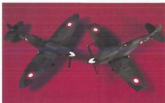
Spitfire Mk. IXE havde enten »klippede« vinger eller de mere almindelige ellipseformede.
