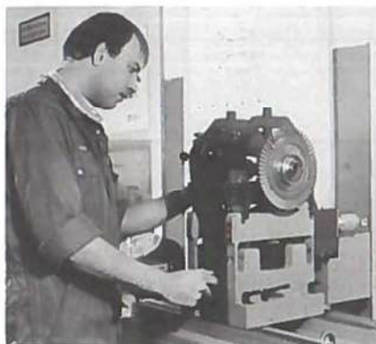
To-plans dynamisk afbalancering af compressor turbine disc.
