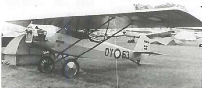
Den danske Marine har fået en ny flytype, denne helt nye Piety Air Camper bygget af Harry K. Olsson og drevet af en luftkølet Continental motor.
