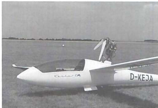
Det ser grotesk ud, når Solo 2350-motorens propel slår vildt om sig med bladene, mens motoren går i gang eller standser.
