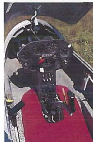
Instrumentpanelet i LAK-12. Håndtagene i midten er til hhv. afkast og lukning af førerskærmen.
