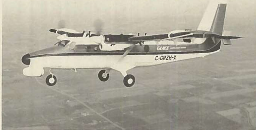
En stadig større dansk erhvervsflyverksomhed sker på Grønland. Her Greenlander Charters nye Twin Otter med radar under næsen til isrekognoscering. Kroptanke giver flyet en flyvetid på 10 timer. Det er nu dansk registreret.
