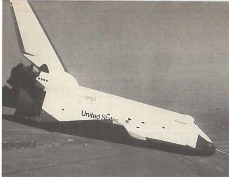
Den amerikanske rumfærge Orbiter er fremtidens forbindelsesled mellem rumfart og flyvning; den starter som rumfartøj og vender tilbage til jorden i glideflyvning, så den kan bruges igen.
