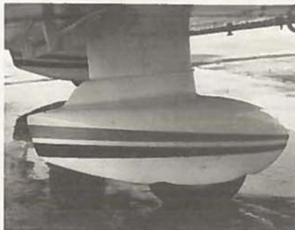
De nye hjulskærme på Cherokee 6 giver forbedrede præstationer.
