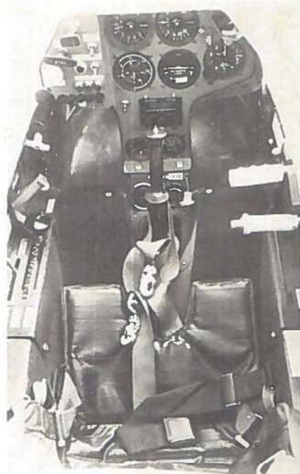
PIK-20E's cockpit med motorbetjening øverst tv og håndtag til at få den ud og ind på højre væg. Det øverste er siden ændret.
