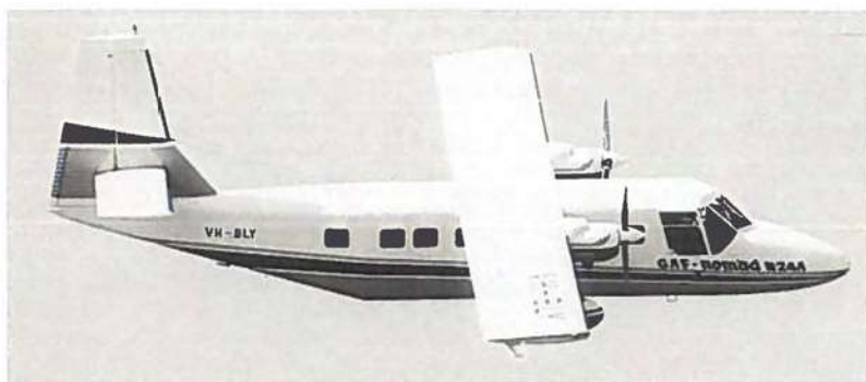
GAF Nomad N24A, en australsk type der også kendes i Danmark (se side 347), men som her vist med forlænget krop til 16 passagerer.
