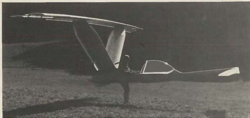
FL står for foot-launched, og flyet kan løbes igang, mens landing normalt sker på en lille mede, mens piloten ligger i kroppen.
