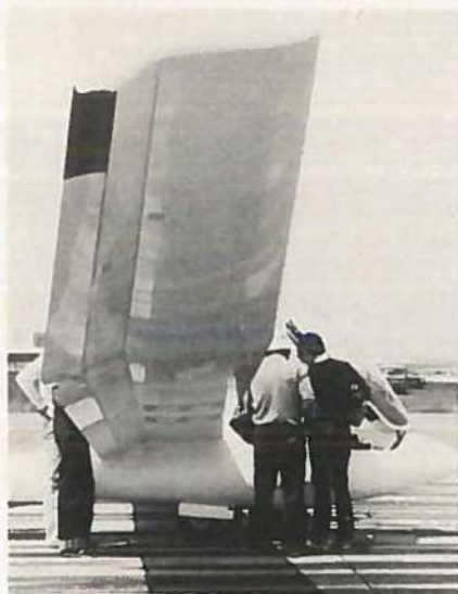
Undersiden af SB-11 vingen med Wortmannflap'en ude. Den alm. flap kan bruges både med det lille og store vingearbejde.
