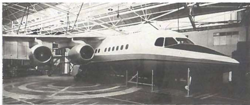
Mock-up i fuld størrelse bygget af træ af BAe 146 i Hatfield. Den har fuldt udstyret kabine og cockpit-indretning.
