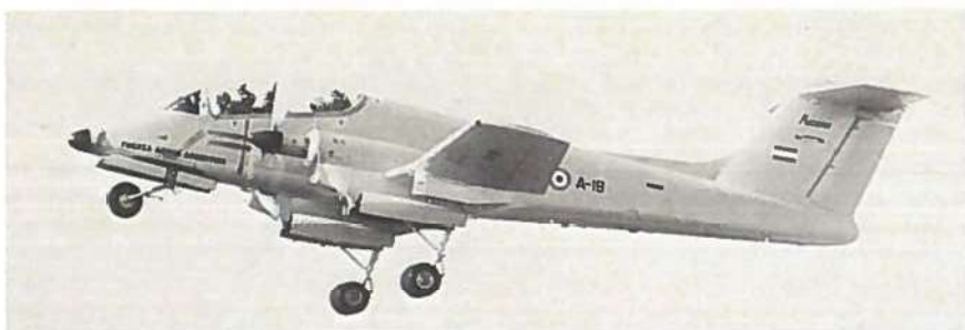
Den argentinske IA 58 Pucara (oprindelig Delfin) har to 1022 hk Turbomeca Astazoum motorer og kan bevæbnes med maskingeværer, kanoner og op til 1500 kg udvendige våben.
