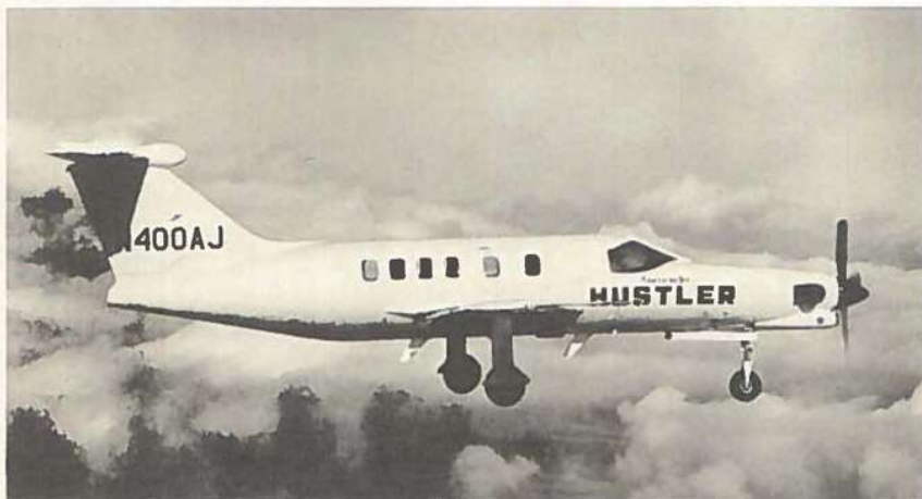
Så kom American Jet's Hustler i luften. Det skete den 11. januar ved hjælp af turbinemotoren i næsen, mens jetmotoren bagi først indbygges senere.
