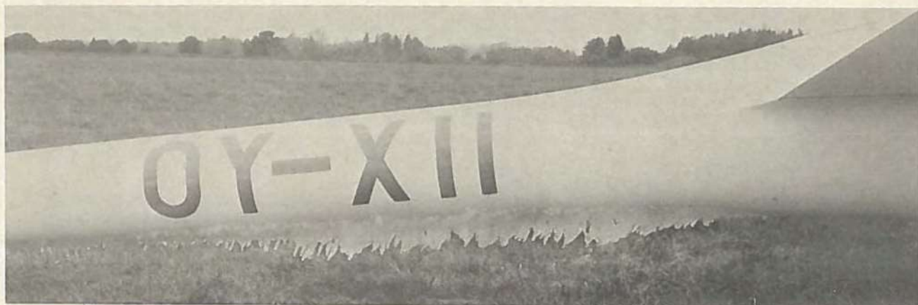
Istapper på flyene var intet usædvanligt syn, men denne bræmme af istapper på Standard Jantar, da den landede efter en opgave, viser et problem, der bør passes på, når man udtømmer vand i frostgrader.
