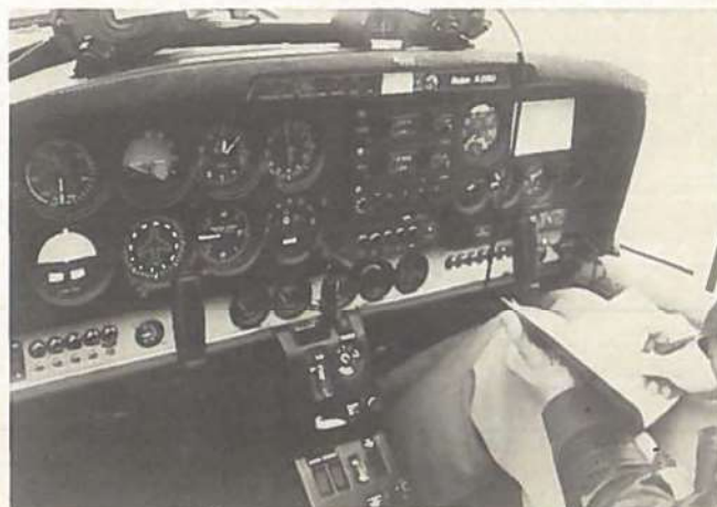
Instrumentbrættet med advarselspanel foroven.
