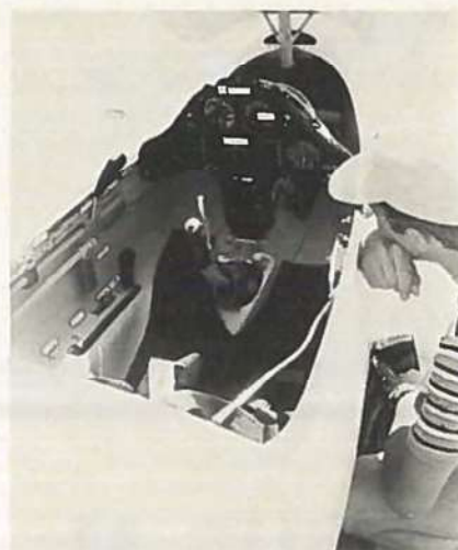
Cockpit'et med flaphåndtaget øverst tv i stilling 4. Når man drejer det udenom spærringen til stillingerne bag denne får man en kraftig bremsevirkning.
