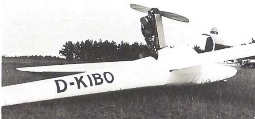
Hirth-motoren ude. Når den er inde, kan man ikke se, det er et motorsvævefly.
