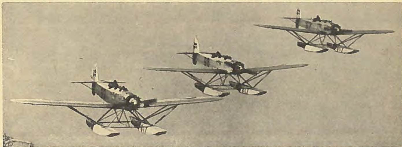
Tre H.M.II eller Heinkel H.E. 8 i formation. Denne type, der også blev brugt på ekspeditioner i Grønland, blev anskaffet i 1928 og var endnu i drift i 1940. De kunne ikke blot operere fra vand, men med særlige skinner under pontonerne også fra is.
