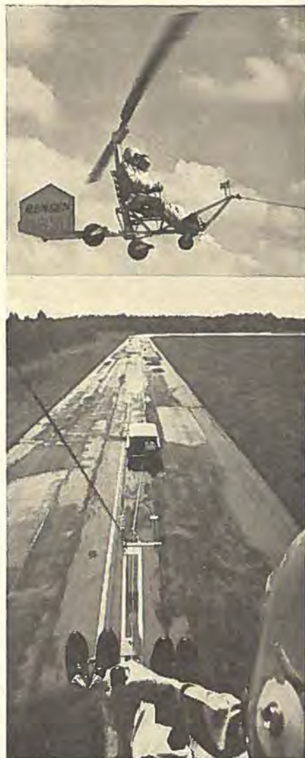
Nederste billede kunne være taget på sydlige rullebane i Vandel, men er fra USA og viser som det første Bensen's nye tosædede motorløse gyroplan, hvori man under autoslæb kan sende begynders solo efter 2-3 timers undervisning. Herefter må man efter nye amerikanske regler også flyve solo på motoriserede gyroplaner, når en instruktør godkender det. Bensen mener, de nye bestemmelser vil øge udbredelsen af hans samlesæt til forskellige typer af rotorfly.
