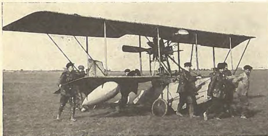
Der rykkes ud til flyvning med Donnet-Leveque-flyvebåden fra 1913. Den havde en 80 hk roterende Gnome-motor.
