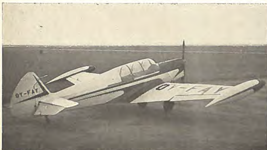
KZ II-KAR må vi vel kalde K. A. Rasmussens ombyggede træner med tiptanke og oprækkeligt understel.
