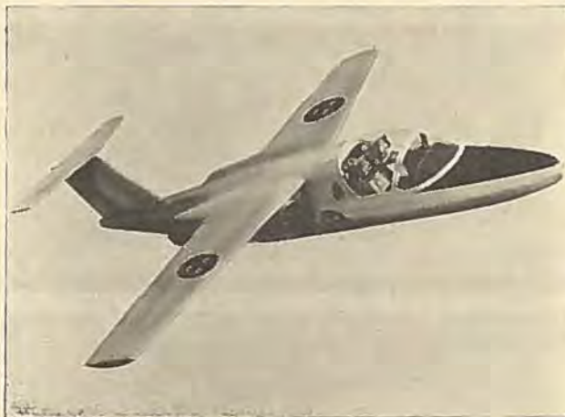
Saab 105 i den militære træningsudgave. Typen planlægges også som forretnings- og transportfly til 5 personer.
