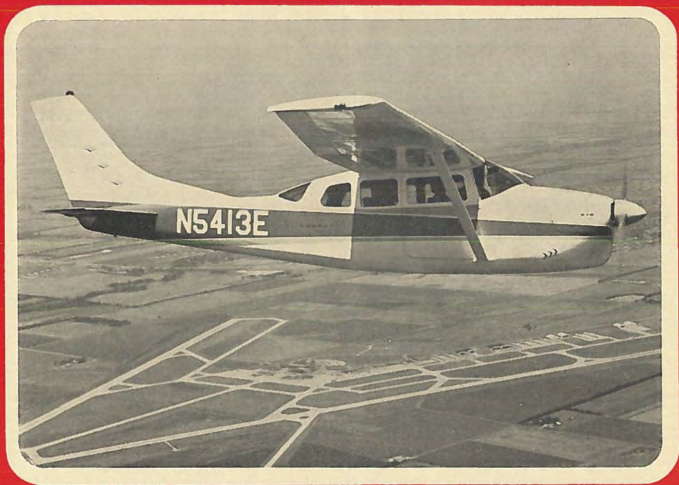
1962-modellen af Cessna 210 har en væsentlig ændret krop med vinduer bagtil, som det fremgår af billedet.
