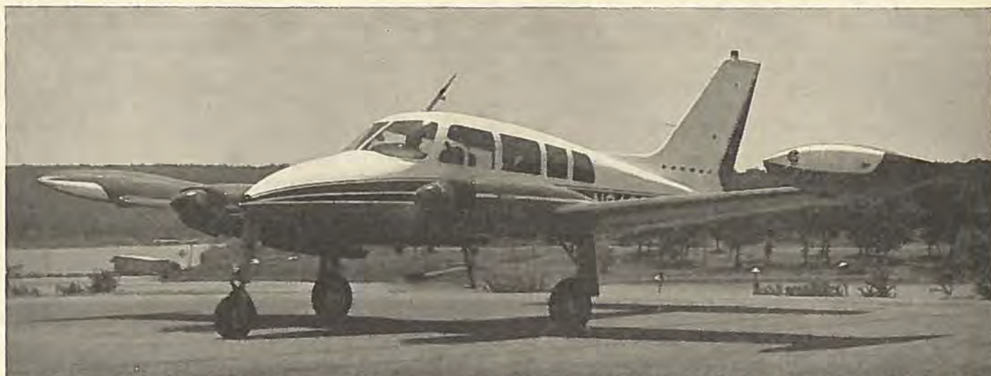
Der er stil over Cessna Skyknight med den pilformede halefinne og de opadrettede tiptanke, der giver meget fine kurveegenskaber. Tophøjden er 8.600 m, på én motor godt 6000 m. Rejsefart 288-392 km/t.
