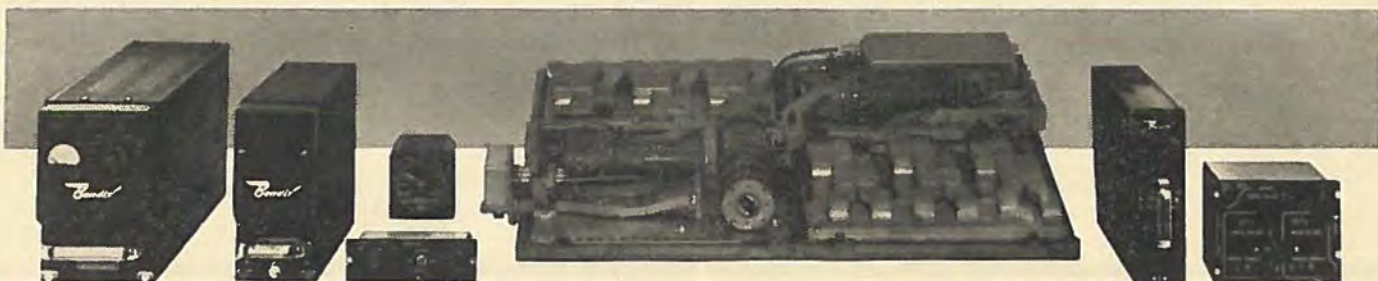
Dette Bendix Doppler-system vejer kun ca. 43 kg 1. Indtrækker 2. Sender/modtager. 3. Kontrolenhed 4. Indikator 5. Antenne 6. Omsætter 7. Funktionsvælger for omsætter.
