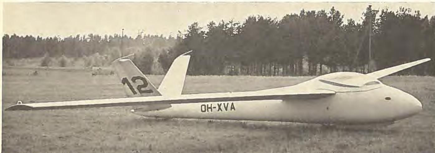
Her ses den elegante prototype til den finske Vasama. V-halen bliver i produktionsudgaven erstattet af et konventionelt haleparti.
