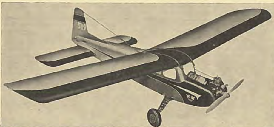
White Cloud er en radiostyringsmodel, der kan anvendes til såvel enkanalstyring som styring med op til 8 kanaler.
