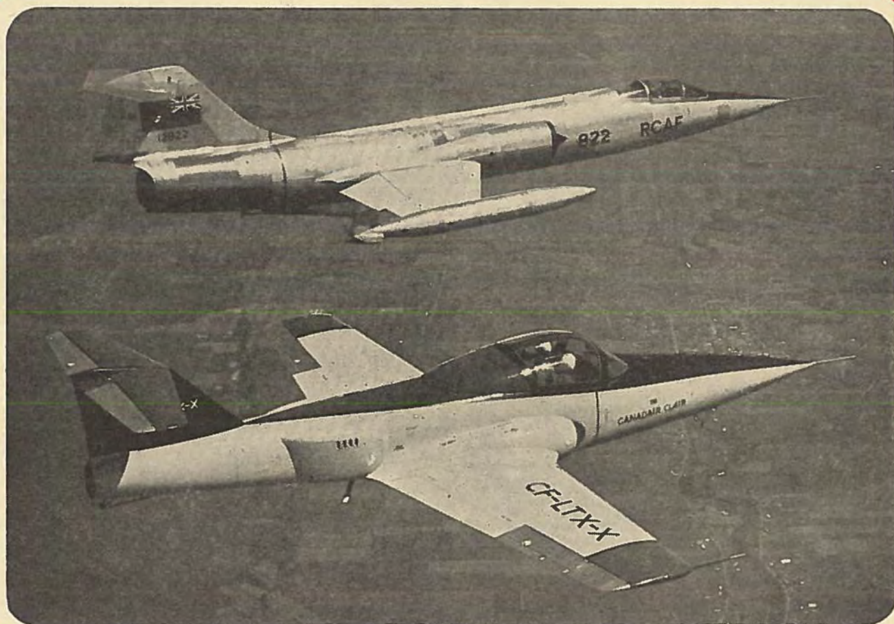
Canadair CL-41R har samme radarudrustning som Lockheed P-104G i baggrunden. For at skaffe plads er en del anbragt i stublere på bagkroppen.
