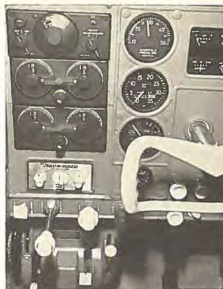
Nav-o-matic's kontrolpanel installeret i en Cessna 210 under radio'erne.
