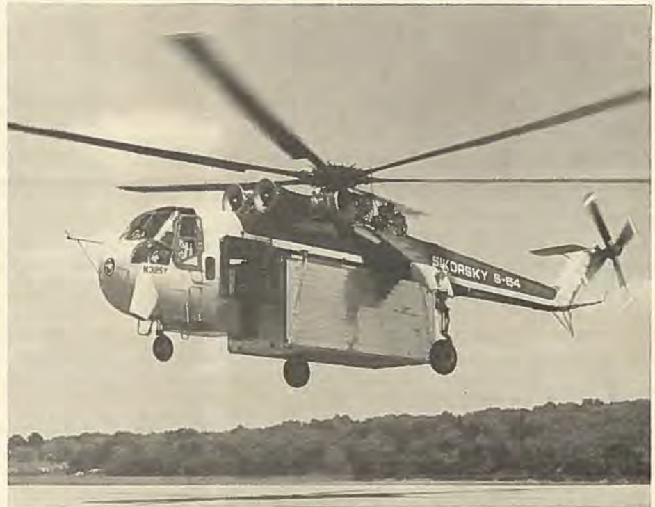
Sikorsky S-64 er udviklet af S-59, men forsynet med turbinmotorer. Første prototype fløj 9. maj og første til Tyskland den 5. juli.
