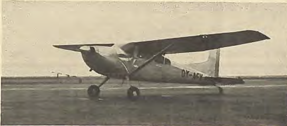
Med halehjulsunderstel og en anden udførelse af finne og sideror har Skywagon et afvigende udseende fra de fleste øvrige af Cessna's 1962-modeller.
