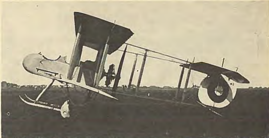
Vickers F.B. 5 Gun-Bus, der blev bygget af hæren i 1916—17. Motoren var en 100 hk roterende Monosoupape.
