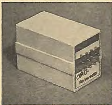
Dele af OMU-anlægget — bemærk de meget små dimensioner. Fra oven ses enkanalmodtageren, bestående af universalmotageren Combiton med påsat 400 Hz Schalter, derunder flerkanalmodtageren og nederst relædelen.
