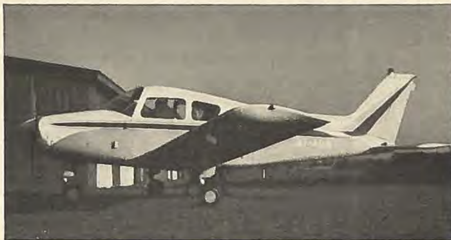
OY-AOW foran den store hangar på Møllemosegård ved Allerød. Læg mærke til den stabiliserende udformning af vingetippen, som iøvrigt er af fiberglas og kan udskiftes.
