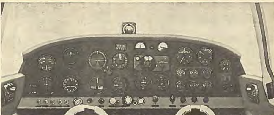
Instrumentbræt i Bolkow 207, som vi omtalte nærmere i sidste nummer. Der er installeret Collins VHF-radio og omni samt Lear ADF .
