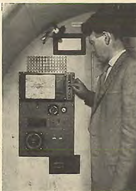
Demonstrationsinstallationen i Deccas' Vaillant viser den selvindstillelige flight-log og nedenunder instrumentet, der viser pejling og afstand til ønskede punkter.
