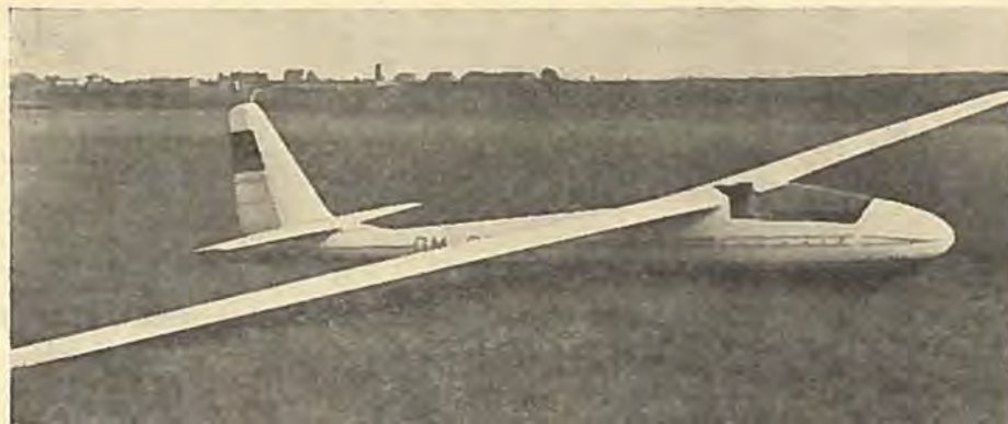
Lom 61 Favorit — det nye østtyske standardsvævefly med glidetal 38, der i år har udført 500 km trekantflyvninger.
