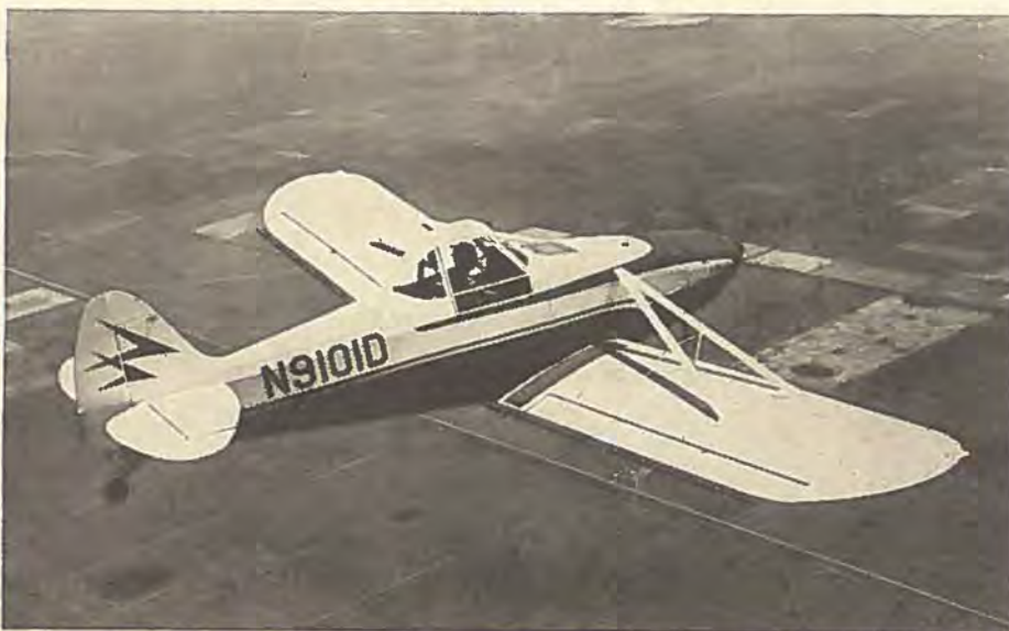
Piper, der fra PA-18A har rige erfaringer mht. landbrugsfly, har nu bragt denne PA-25 Pawnee på markedet; den kan bruges til pudring eller sprøjtning. Motoren er en 150 hk Lycoming. Mange dele stammer fra andre Piper-typer. Der er truffet omfattende foranstaltninger for at gøre den så sikker for piloten som muligt.
