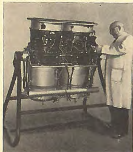
Rolls-Royce RB.108, den løftemotor der anvendes i Short SC.1 i fem eksemplarer.
