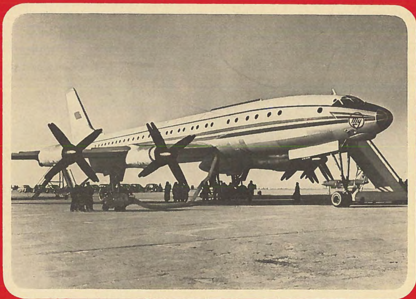
Den russiske Tupolev Tu-114 Rossiya er ikke alene verdens største luftliner, men samtidig verdens hurtigste propeldrevne fly, hvad nye FAI-rekorder bekræfter.
