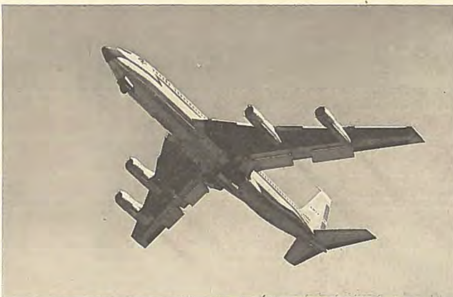
Boeing 707-120B med den nye Pratt & Whitney JT3D sturbofansmotorer var i luften første gang d. 22. juni.
