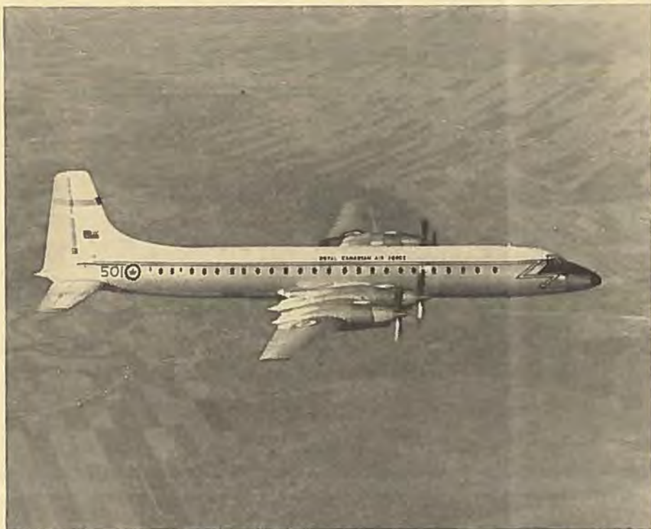
Den ny Canadair Forty Four på en af sine første prøveflyvninger. Det er en videreudvikling af Bristol Britannia, forsynet med Rolls-Royce Tyne turbomotorer, og den tegner til at blive en særdeles økonomisk transporttype til såvel militær som civil brug (fragtflyvning).
