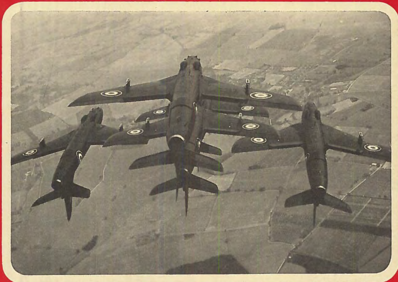
Fem Hawker Hunter F. 3 fra RAF's berømte 111. eskadrille fotografet under et loop fra et ledsagende fly. Bemærk, at der bruges flaps under manøveren.
