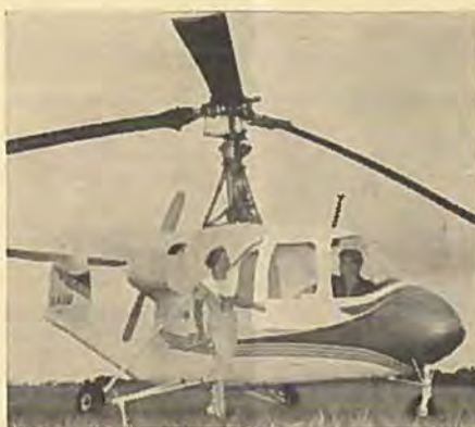
Her er til gengæld et gyroplan: Umbaugh-18, forsynet med 180 hk Wyoming-motor, der driver den skubbende propel og kun før starten bruges til at speede rotoren op. Den sættes i produktion hos Fairchild og skal koste under 70.000 kr.
