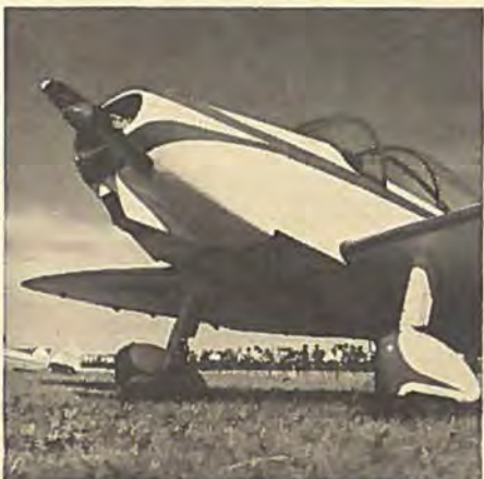
Émeraude's forparti. Oliekpleren bliver mere afrundet i næste udgave. Hjulekærme er ekstraudstyr.
