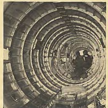
Hvad forestiller dette billede? — Kroppen til en flyvemaskine, vil de fleste mene. Det er imidlertid en af motorgondolerne til den af rustfrit stål byggede Bristol 188.
