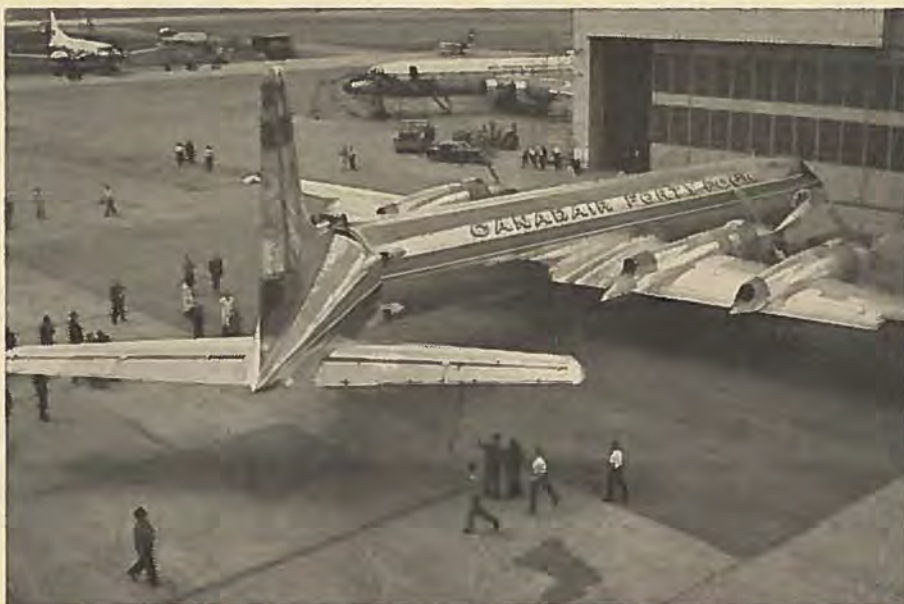
Canadair Forty-Four er det første, men næppe sidste, svinghalefly. Flere andre projekter til fragtfly anvender dette system for at lette lastning og losning.
