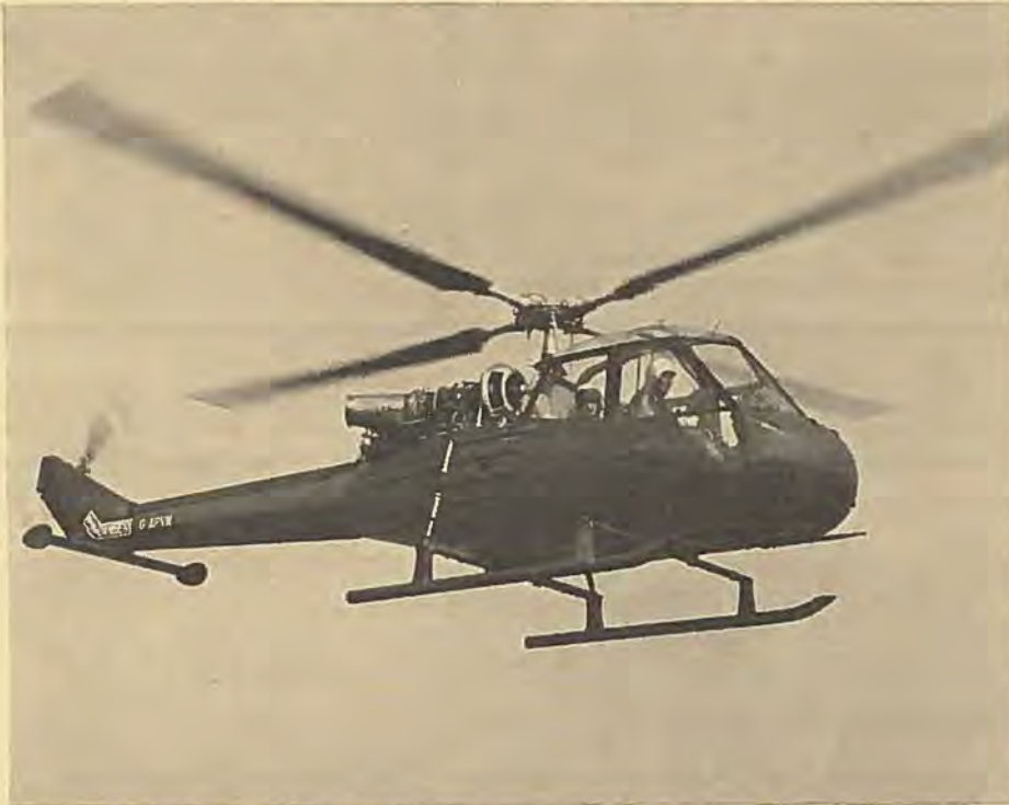
Turbinmotoren er godt på vej til at fortrænge stempelmotoren til helikopterbrug. Billedet viser Saunders-Roe Wasp, som den 3. maj foretog sin første flyvning, udrustet med den amerikanske 1000 hk motor, som de Havilland bygger under navnet Gnome.
