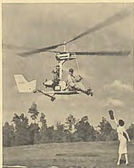
»Du glemte madkassen, råber fru Bensen efter sin mand, der af sine gyroplaner nu har udviklet en helikopter, som bruger almindelig bilbenzin og derved bliver uafhængig af flyvepladserne. Pris ca. 50.000 kr. Motor: 60 hk.
