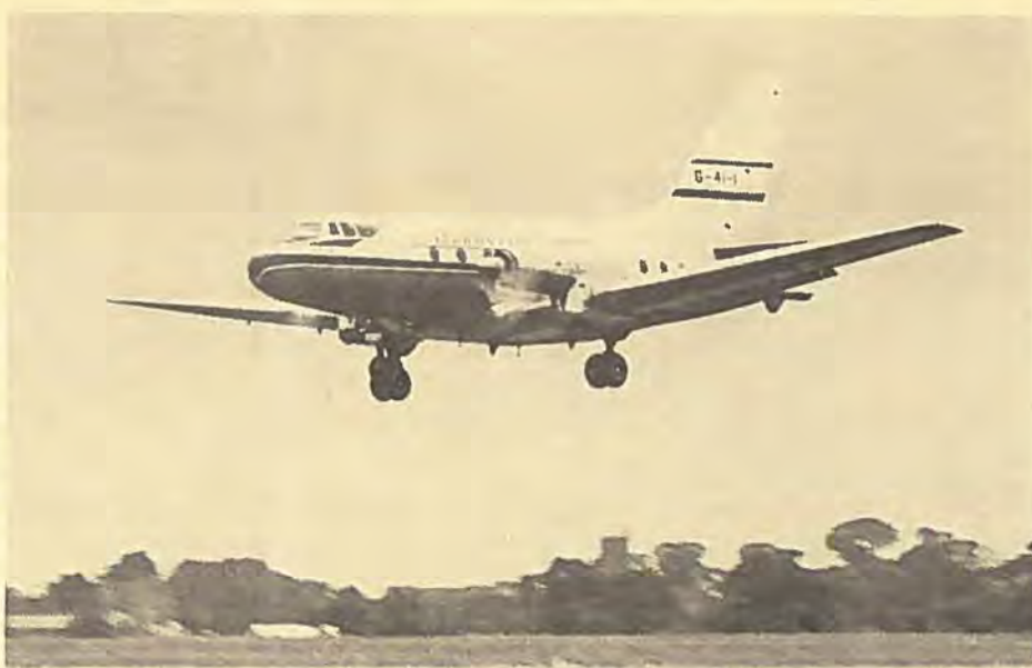
Aviation Traders Accountant foretog sin første prøveflyvning den 9. juli. Den er udstyret med to Rolls-Royce Dart turbinemotorer og beregnet til forretningsflyvning (6 passagerer) eller som erstatning for Dakota.
