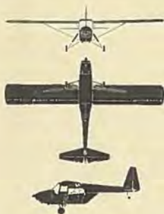
Foto og tegning: Percival E.P.9. Tegningen viser den oprindelige prototypen, hvis finne siden blev ændret som på fotografiet.
