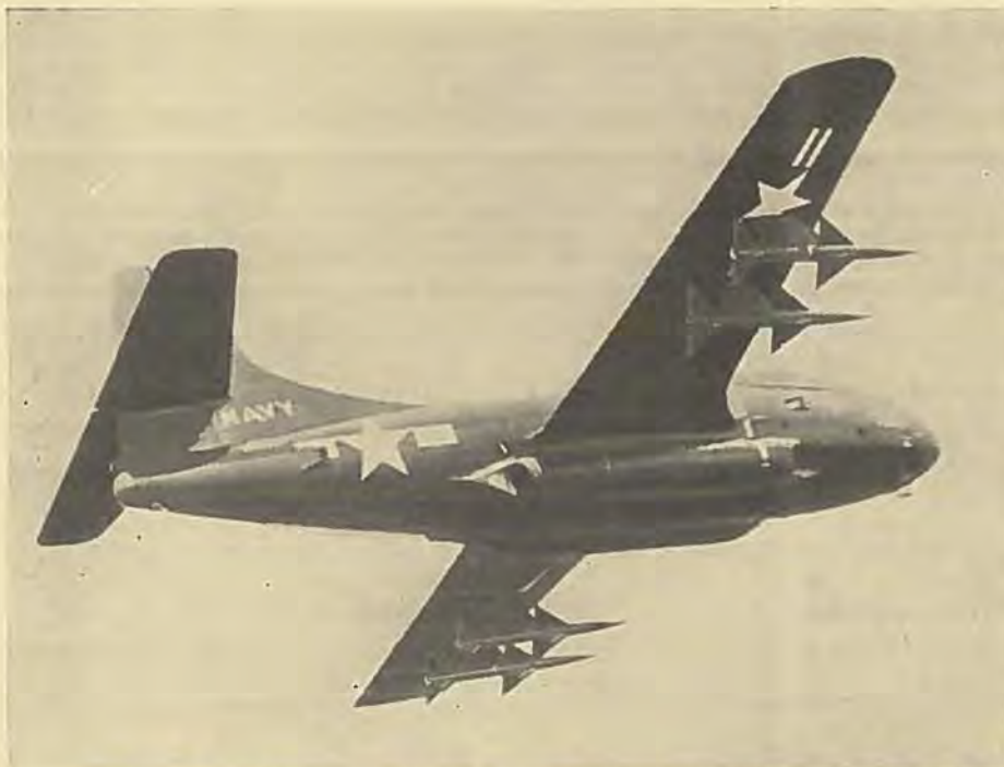
Fire Sperry Sparrow fjernstyrede våben til anvendelse fra en flyvemaskine mod en anden. De bæres af en Douglas F3D Skyknight.
