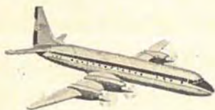
Lockheed Electra udstyret med fire Allison Model 501 propelturbinmotorer med Aeroproducts propeller.
