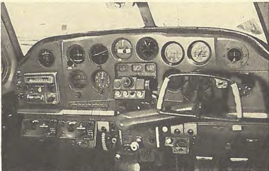
Et i radiomæssig henseende veludstyret cockpit. Til venstre ses en Lear VHF-sender/modtager, VOR og LF/MF radiokompas. Anlægget vil blive nærmere omtalt i en senere artikel.
