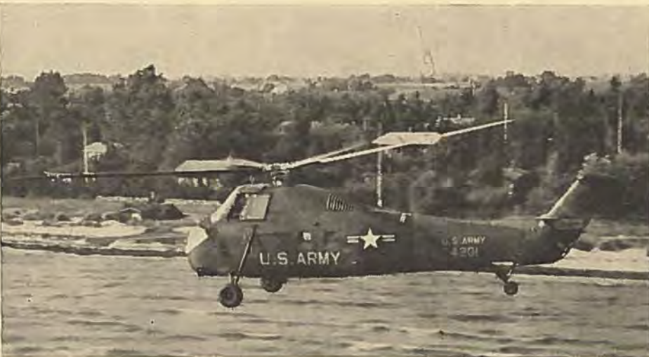
En af den amerikanske hærns Sikorsky H-34 helikoptere under lavflyvning langs de danske kyster. Billedet giver ikke rigtigt indtryk af størrelsen, men der er kabine til 12 for nedden og førerrum på første sal.
