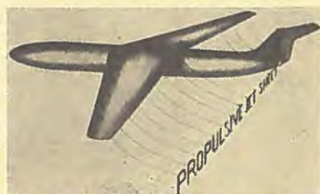
Jet flap'en er en luftstrøm, der dels virker som flap med stærkt øget opdrift, dels virker fremdriftsgivende.
