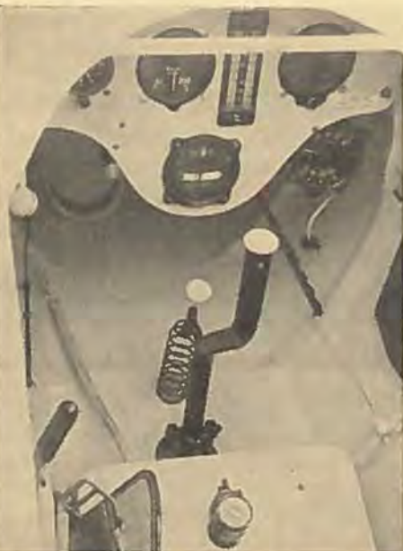
Førersædet i Rhönsegler, som Buch Petersen fløj den ved VM. Man ser tydeligt trimanordningen. Der er både Gosim-variometer og et alm. variometer, og Cook-kompasset har måttet anbringes på sædet.
