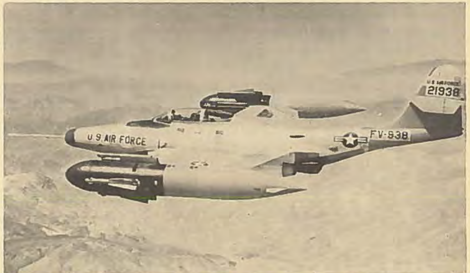
En Northrop F-89H Scorpion bevæbnet med tre Hughes Falcon på hver tiptank. De kan affyres enkeltvis eller i salver.
