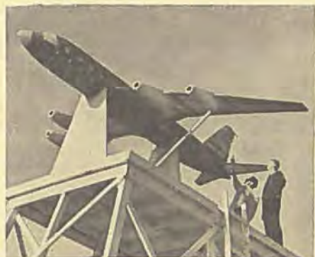
Convair bruger denne model med 5 m spændvidde til forsøg med antennesystemet på den nye Convair 880. Toppen af halefinnen anvendes som antenne. Herren til højre er Convairs elektroniske chefingeniør, W. S. Ivans, fuldt restitueret efter sit havari ved VM i svæveflyvning Ifjor.
