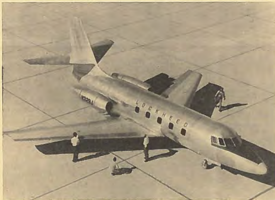
Prototypen til Lockheed Jetstar, der blev bygget i rekordtid, er udstyret med to Bristol Orpheus-motorer, anbragt à la Caravelle på bagkroppen. Senere udgaver skal have fire amerikanske Jetmotorer, to uden på hinanden på hver side.
