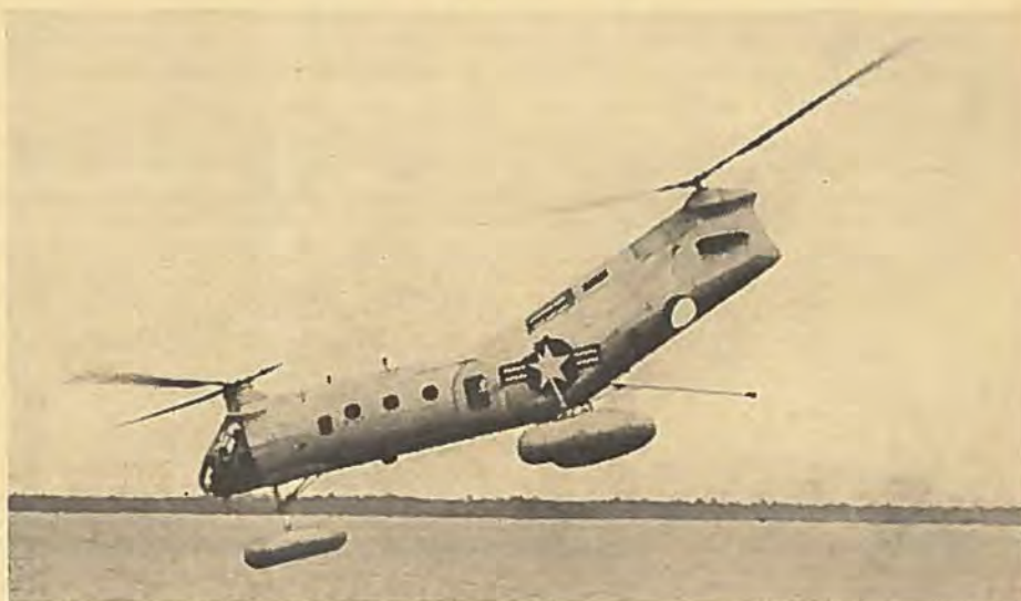
Foruden Bristol i England bygger Vertol i USA store helikoptere med to rotorere, men foreløbig kun en motor. En H-21 kan slæbe skibe op til 3.000 tons.
