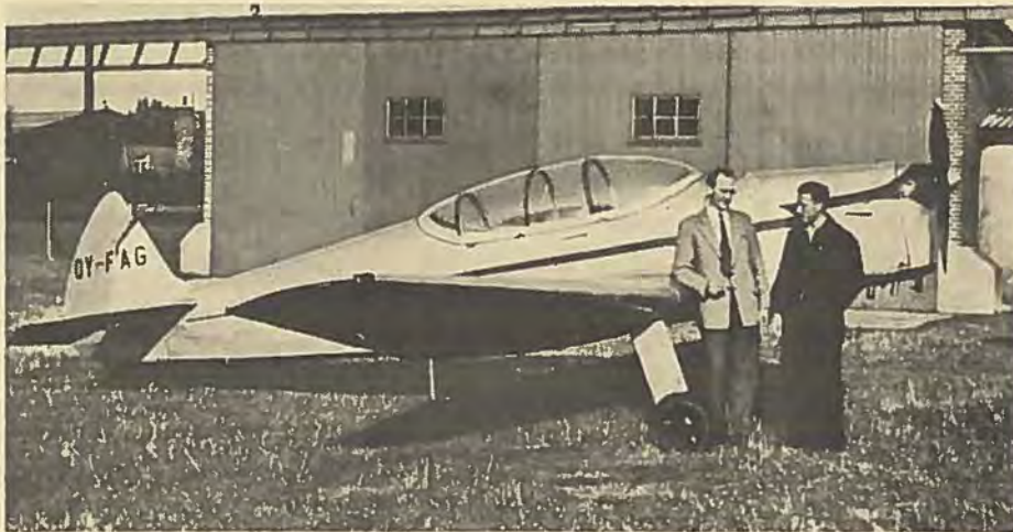
Thyregod (t.h.) og artiklens forfatter foran den ændrede KZ-IIT. Den lukkede førerskærm øgede rejsefarten til 195 km/t (med Gipsy Major I). Den øgede tomvægt modvares af sparet overtøj; selv i december kan det undværes. Udsynet fra bagsædet er forbedret, flyvegenskaberne uændrede.
