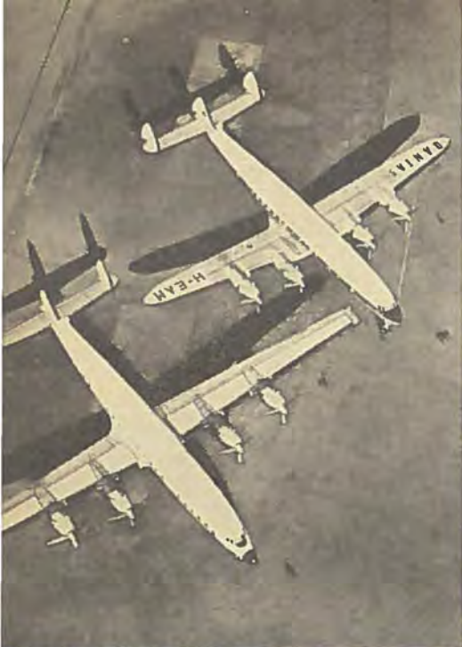
Lockheed 1649A Super Constellation er formodentlig den sidste langdistancetype med støpelmotorer. Med en spændvidde på 45,5 m er den over 8 m større end 1049 H Super Constellation ved siden af. Rækkevidden er op til 10.000 km.
