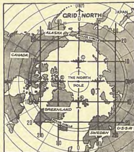
På grid-kortet er Greenwich-meridianen nord, også hinsides nordpolen, og der navigeres efter linier parallele med og vinkelret på denne retning.
