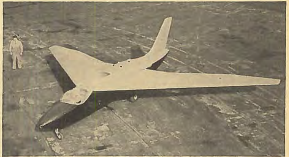
Short SB 4 Sherpa er en lille forsøgsflyvemaskine, udstyret med to Turboméca Palas reaktionsmotorer. Dens formål er at afprøve en ny plankonstruktion. I stedet for almindelige rotor styres den med plan-tipperne, der er drejelige og fungerer både som højderor og krøngeror.
