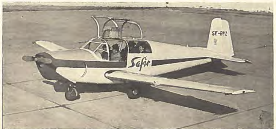
SAAB-91C er den nyeste version af SAAB Safir, der bl. a. (som 91B) er standard-skolemaskine i det svenske flyvevåben. 91C er firesædet og forsynet med en 190 hk Lycoming motor. Den bygges af De Scheide i Holland på licens.
