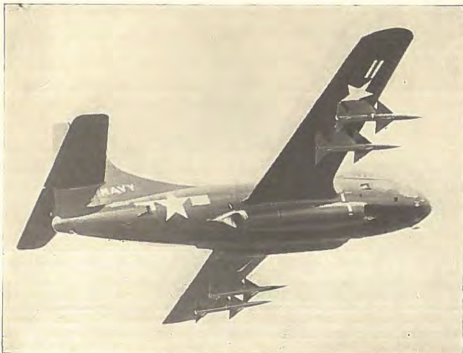
En Douglas F3D Skynight altvejsjager udstyret med fire Sparrow I fjernstyrede projektiler, som med overlydshastighed ledes mod mål i luften.
