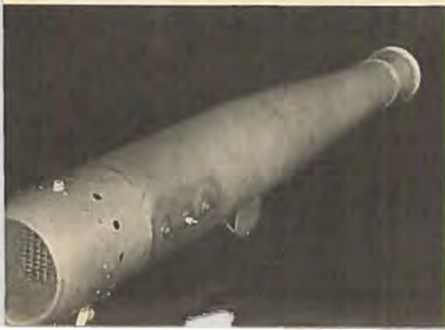
Til venstre SARO's pulserende rammotor til anvendelse på helikopterblade. — I midten de Havilland Super Sprite raketmotor (til hjælp i starten). — Til højre en raketdrevne, fjernstyret bombe fra Armstrong Whitworth.
