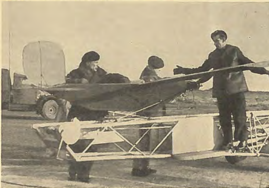
Denne Auster B3 er noget større end de radiostyrede flyvemodeller, som modellflyverne i stadig større omfang flyver med. Det er et skydemål, der kan flyve næsten 200 km/t.
