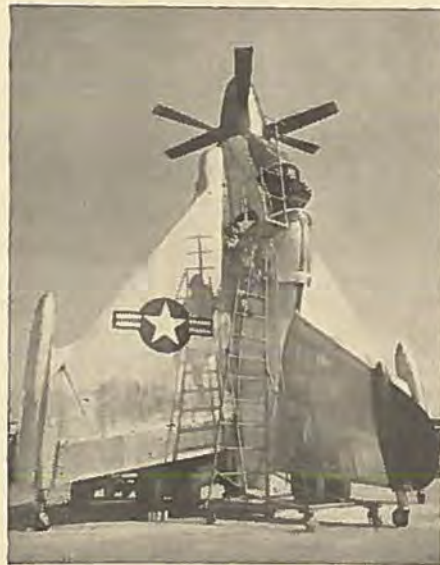
Piloten går ombord i Convair XFY-1, hvis førersæde befinder sig i første sats højde. I øjeblikket prøveflyves maskinen i en luftskibshangar i Californien.
