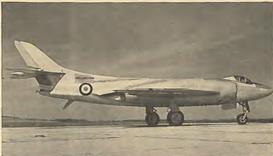
Supermarine 525 er den nyeste engelske type. Den er udviklet af Supermarine 508, men har pilform på alle flader og normal hale i stedet for den v-formede. Den har som 508 to Rolls-Royce Avon motorer og en udvikling af den er sat i produktion for flåden.
