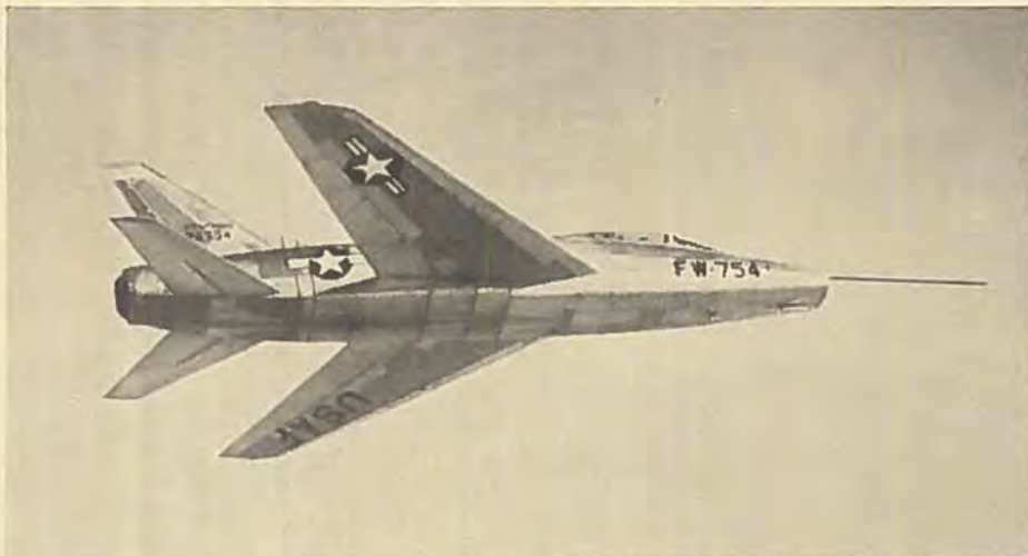
1219 km/t har denne North American F-100 Super Sabre fløjet med en Pratt & Whitney J-57 reaktionsmotor med efterbrænder.
