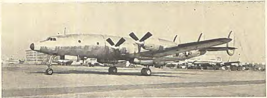
Den første amerikanske trafikflyvemaskine med turbinemotorer er måske ikke så langt borte længere. Blandt de typer, der forøgsvis er udstyret med sådanne motorer, er denne Lockheed R7V-2, en militær Super Constellation med Pratt & Whitney T-34 motorer.
