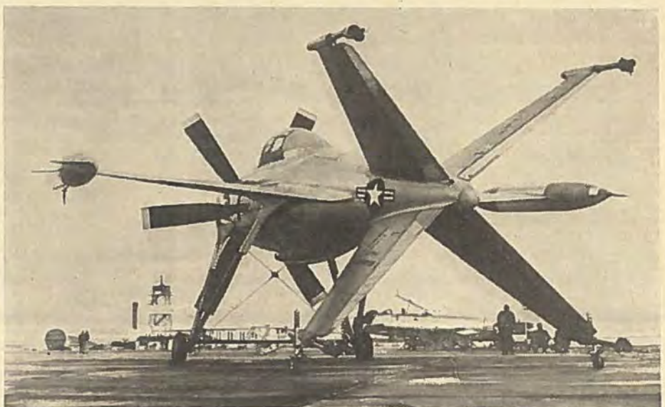
Til venstre ses Lockheed XFV-1 klar til lodret start. Forneiden er den udstyret med et midlertidigt langbenet understel til vandret start.
