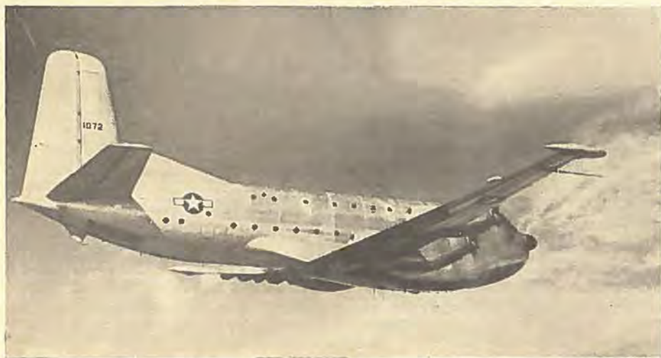
Den første amerikanske transportmaskine med fire turbinemotorer er denne Douglas YC-124B med ialt 22.000 hestekræfter. Den kan rumme 200 soldater.
