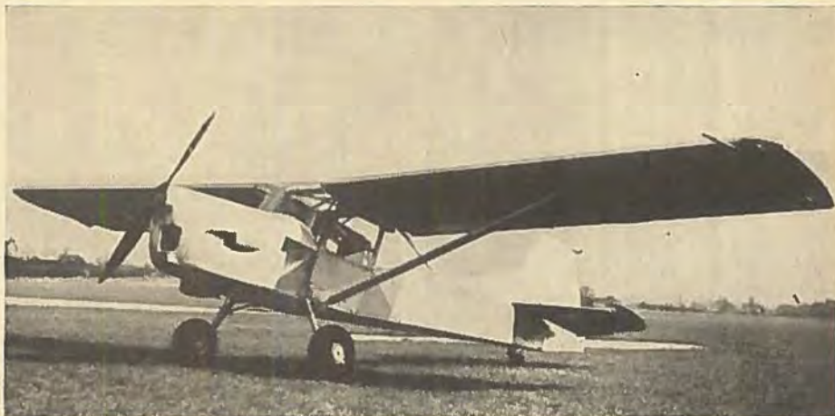
Auster Mk. 9, en ny observationsflyvemaskine med 180 hk Cirrus Bombardier motor.
