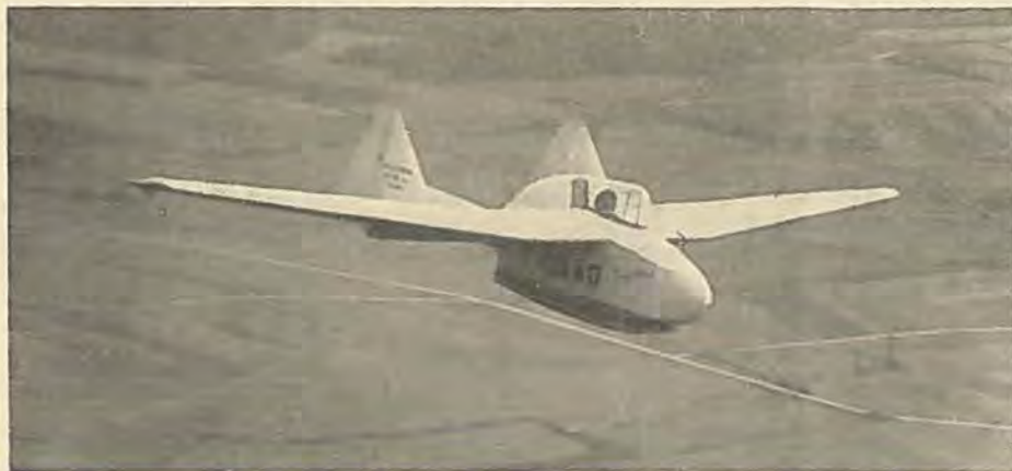
Noget for os? Denne lille haleløse Fauvel AV-36 har vakt opsigt blandt svæveflyvere verden over og bygges i en række lande.
