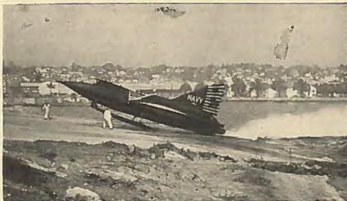
Convair XF2Y-1 Sea-Dart er en forsøgsflyvemaskine med deltaplan, to Westinghouse reaktionsmotorer — og vandski, der kan trækkes op. Den kan ved egen hjælp køre fra land ud på vandet og atter fra vandet og op på land.
