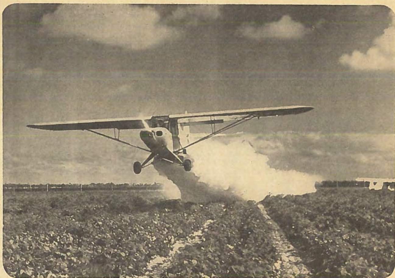
Landbrugsflyvemaskinen i funktion. En Piper PA-18 A pudrer markerne i laveste højde. PA-18 A er en speciel landbrugsudgave af Piper Super Cub.
