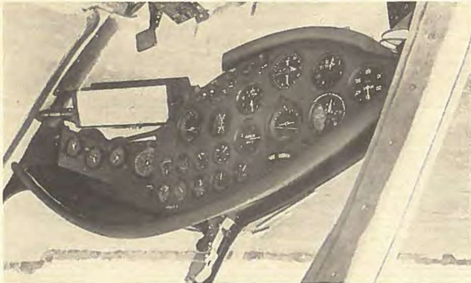
Figur 1 viser instrumentbrættet i en Avro Anson med Decca-instrumenterne til højre og kontrolboxen dertil nederst til venstre.
