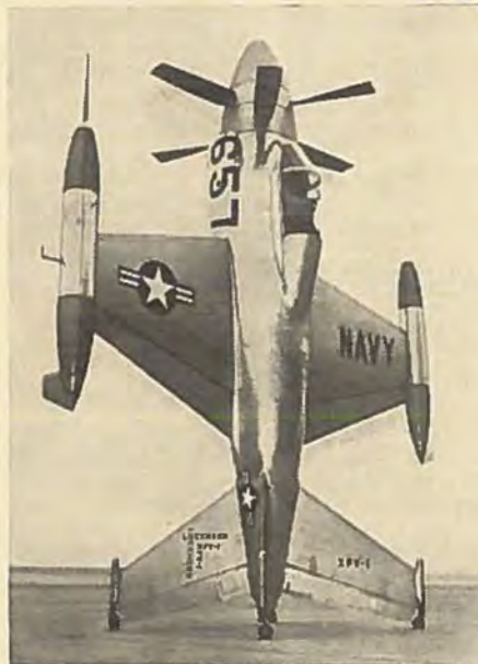
Til venstre ses Lockheed XFV-1 klar til lodret start. Forneiden er den udstyret med et midlertidigt langbenet understel til vandret start.
