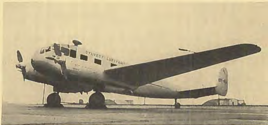
Denne Siebel 204D kom ikke til at opfylde sin mission som øvelsesmaskine for Luftwaffe, men toges nu efter omtrent 10 års forløb i brug som charter- og fragtflyvemaskine i Danmark. Hertil er den yderst velegnet, som artiklen fortæller.
