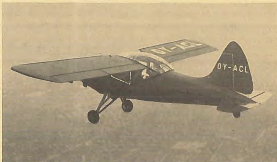
KZ-10 er en videreudvikling af KZ-III og KZ-VII, har samme fremragende langsomflyvningssegenskaber, lidt større hastighed, på grund af større motor, og et førsteklasses udsyn.
