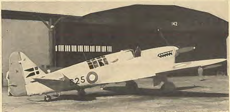
Først i oktober kom den første Fairley Firefly Mk. I til flyvevåbnet hertil. Den drives af en 2250 hk Rolls-Royce Griffon motor. I juni nummeret bragte vi på side 116 nogle billeder af slæbeinstallationen.
