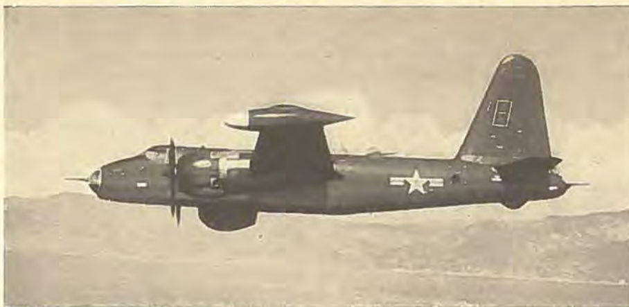
Ubådsbekæmper: Lockheed P2V-5 er den nyeste version af Lockheed Neptune. Udstyret med næsetårn, større vingetanke og med radarudstyr skal den anvendes af USA, England og Australien.
