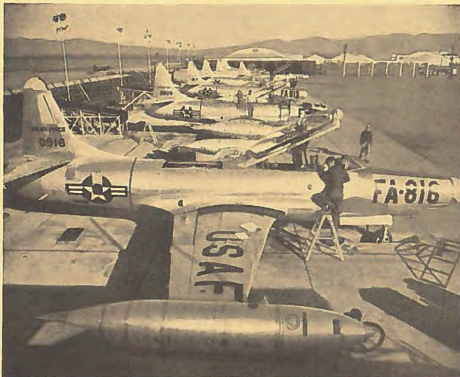
Lockheed F-94, den såkaldte pall weather fighters, er sat i en større serieproduktion. Det er en tosedet videreudvikling af Shooting Star.
