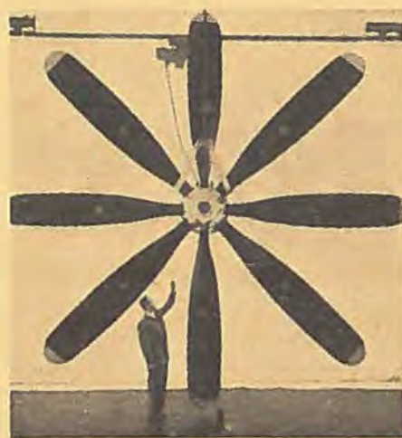
Denne „Octoprop“ er 5,7 m i diameter og beregnet til gasturbiner på 10.000 til 15.000 hk.
