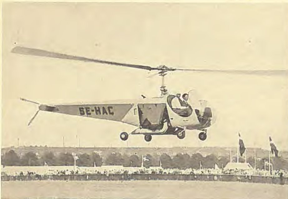
Bell 47 B med aabent Førersæde og specielt udrustet som »Landbrugsmaskine« til Bekæmpelse af Skadedyr etc.
