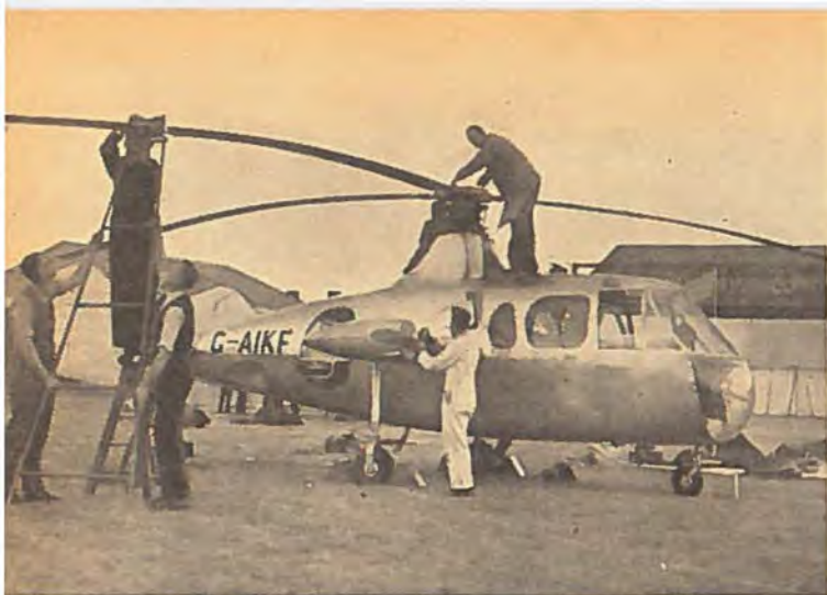
Society of British Aircraft Constructors afholdt i September sit årlige Stævne for 10.000 indbudte flyvesagkyndige fra 50 Lande. En Del af de 60 udstillede Typer demonstreredes ogsaa i Luften. Til venstre ses Fairey Gyrodyne Helikopteren til 5 Personer. Den motordrevne Propel paa højre Side modvirker Rotationstendensen. Til højre ses Faireys flyvende Bombe, Støge, paa sin Startbane. Den radiostyres ved Apparatet til højre.
