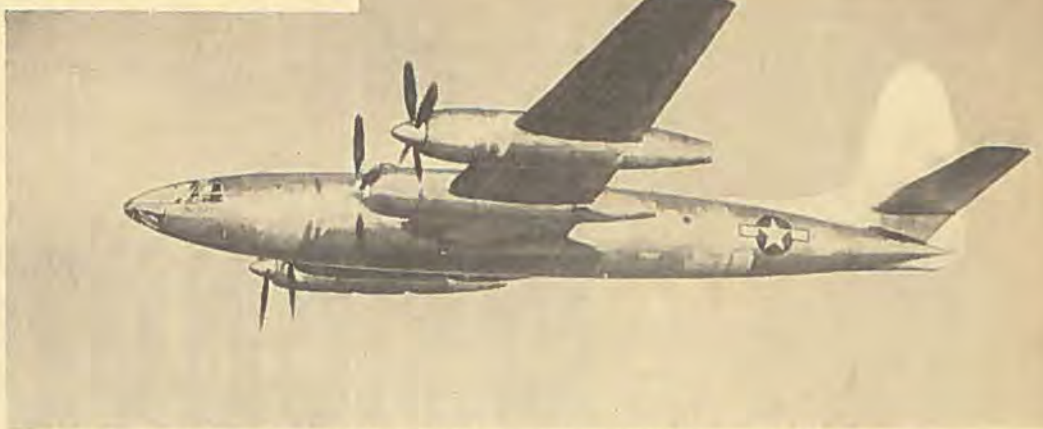
Rainbow har en ualmindelig elegant Form, der har bragt Modstanden betydeligt ned. Vindskærmsproblemet er løst paa den Maade, at den forreste Del ved Start og Landing trækkes ind, saa Piloten faar en normal Vindskærms bedre Udsyn.
