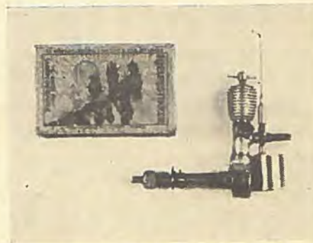
1 cm 3 Dieselmotor, Konstruktion: Øjvind Andersen, sammenlignet med en Tandstikskæke.
