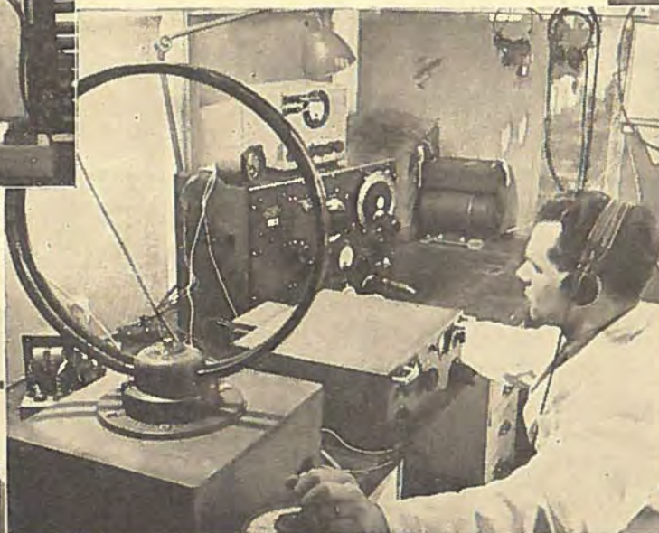
↑ Instrumentværkstederne, hvor man næppe kan finde et Støvgran, og Ingeniører og Teknikere som paa et Hospital gaar rundt i snehvide Kitler, er et af de hellige Steder paa Bromma. Her ses en af Ingeniørerne i Færd med at kontrollere en Pejlemodtager.
