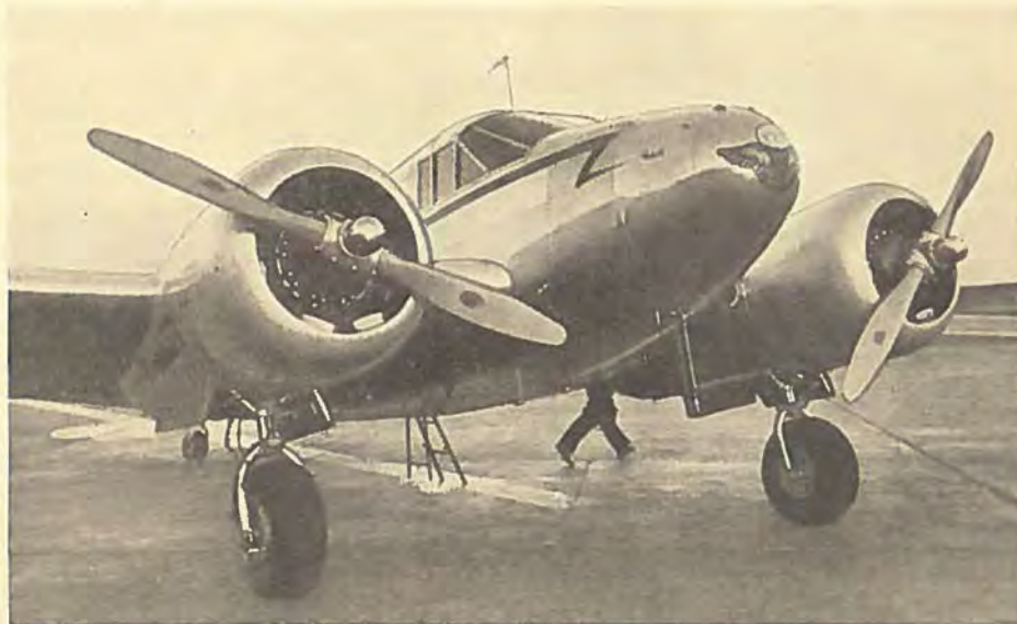
Beechcraft D18 er Civiludgaven af »Expediter«, der anvendes meget som Forbindelsesflyvemaskine under Krigen. Motorerne er to 450 HK Pratt & Whitney Wasp Junior.
