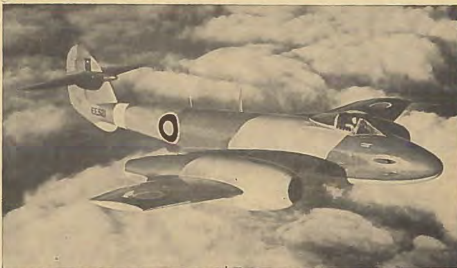
Gloster Meteor IV er den sidste Version af Typen, som er sat i Tjeneste i R. A. F. Den afviger i det ydre ved sine »afklippede« Vingespidser fra den Udgave, vi saa ved R. A. F.-Opvisningen i Kastrup i 1945.
