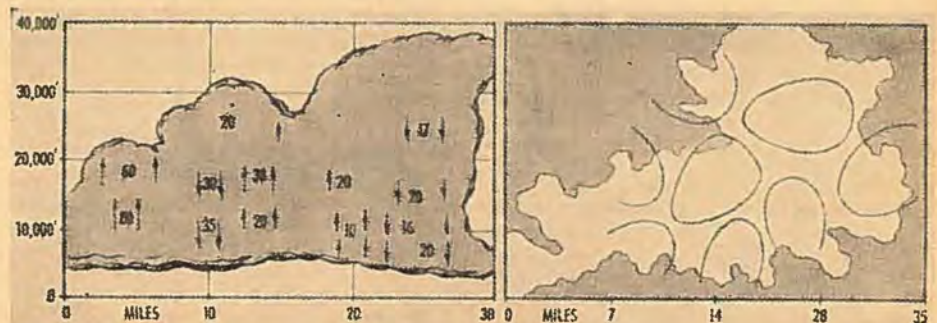
Cellerne i Bygen er antydet ved 3 adskilte Grupper af Op- og Nedvinde (Fod pr. Sek.) i den lodrette Tværsektion til venstre. I den vandrette Tværsektion til højre er Cellerne antydet inden for Skyens hvide Omrids, som dette tager sig ud paa en Radarskærm.
