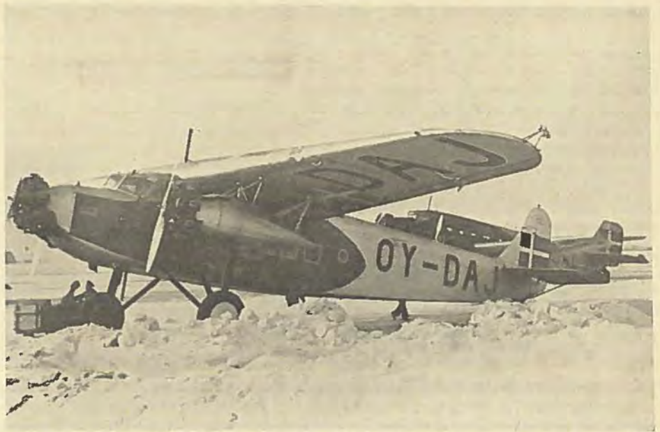
Fokker F.XII, hvoraf DDL har to, som stadig er i Drift. De er bygget paa Orlogsværftet i København i henholdsvis 1933 og 1935. 3 × 460 HK. Bristol Jupiter Motorer. 2 Mands Besætning og 16 Passagerer. Marchhastighed: 210 og 220 km/T.
