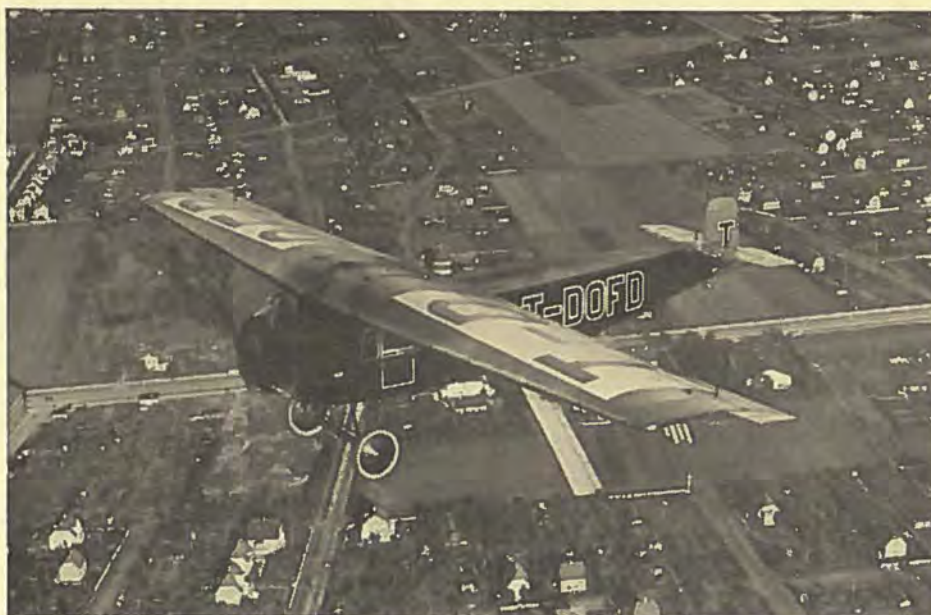
Fokker F.III. 1 × 240 HK. Siddeley Puma Motor. Foruden 1 Fører kunde de rumme 5 Passagerer. 1 havarede i 1925, 1 i 1927 og 2 solgte i 1929 til England.
