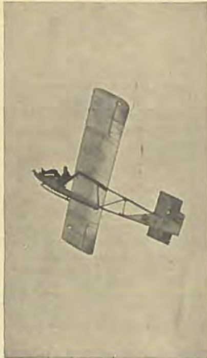
En »Sg 38« i Spilstart. Denne Type udmærker sig navnlig ved at være særdeles robust overfor haarde Landinger. Den skal praktisk talt flyves i Jorden for at gaa i Stykker.
