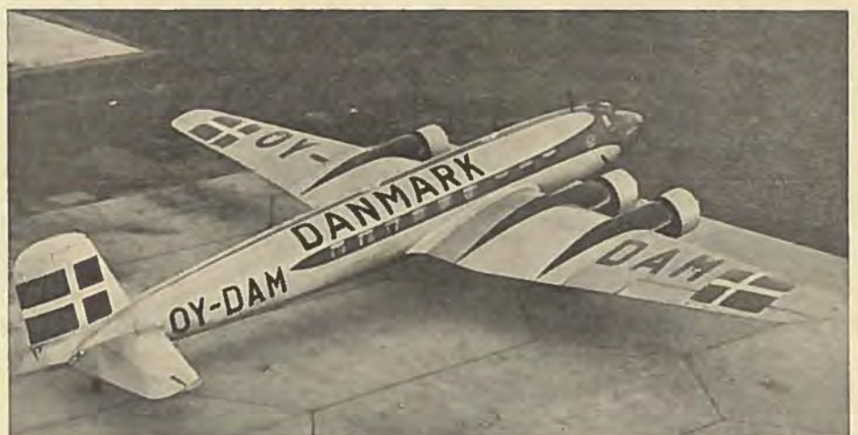
Moderne Trafikflyvemaskine. 4-motoret, fritbærende Monoplan. Maksimal-Hastigheden ligger ved disse Typer paa ca. 400 km/T.
