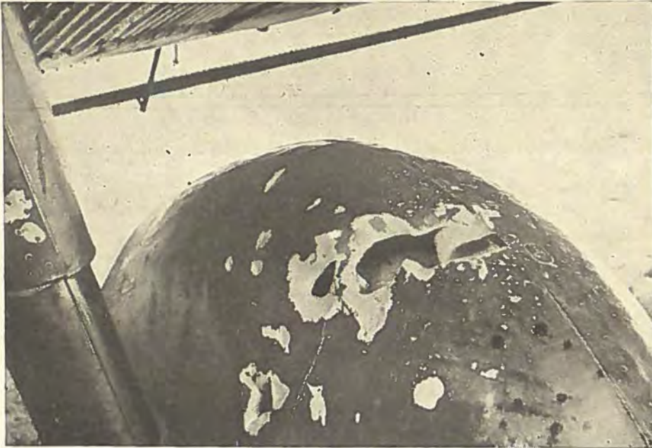
Lynnedslag i Hjulbeklædning paa en Ju 52.
