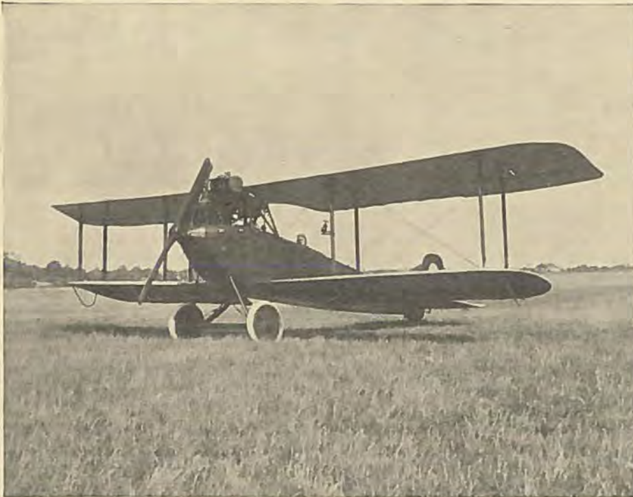
Eldre Flyvemaskine af Biplantypen med Støtter og Barduner mellem Bærepplanerne. Maksimal Hastighed ca. 120 km/T.
