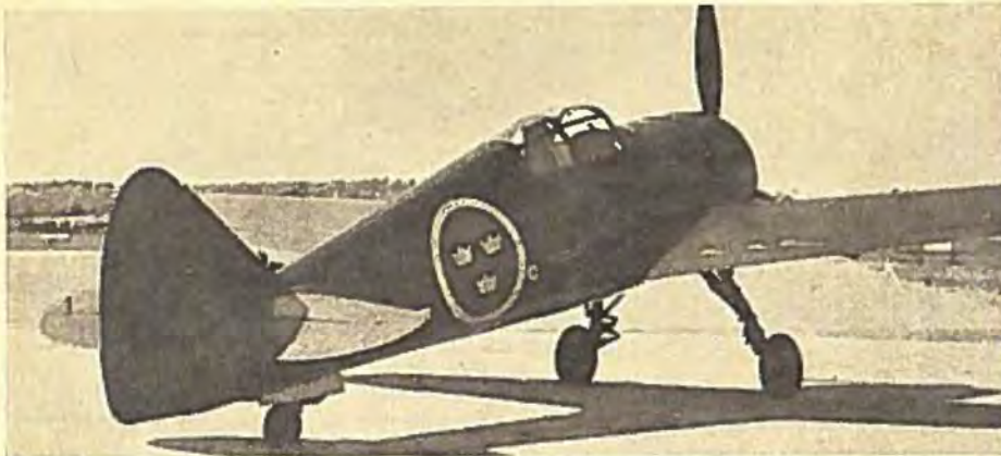
Den svenske Jager J 22 set skraat bagfra. Halefinnens karakteristiske Form ses tydeligt. Desuden lægger man Mærke til de store Balanceklapper.
