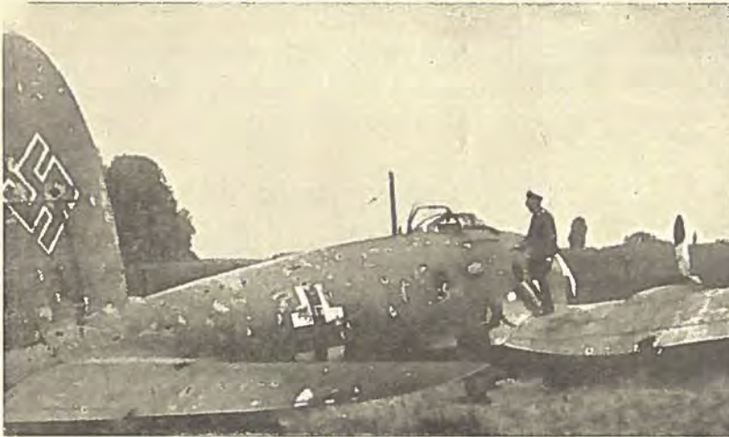
Fig. 4. Heinkel 111. Krop, Planer og Haleorganer er oversaaede med Træffere fra MG-Projektiler. Den eneste — synlige — Virkning har været, at det indtrækkelige Understel ikke har kunnet slaas ned forud for Landingen.
