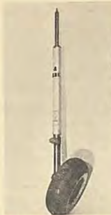
VDM-Fundi-Fjederben med Olie-dæmpning til Fieseler 156 »Storch«.
