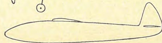
Tegningen viser to Eksempler. Øverst, hvordan en Motor-model i Regelen ser ud, og neden under den korrigerede Model — som den burde være.
