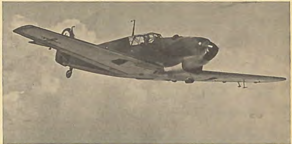
MESSERSCHMIDT ME 109. Eensædet Jager. Een 1150 HK Daimler-Benz DB601 vandkølet Motor. 4 faste Mg. (2 i Kroppen og 1 i hver Planhalvdel). Udstyres ogsaa med Kanon. Stigetid til 5000 m: 5 Min. Hastighed over 600 km/T.
