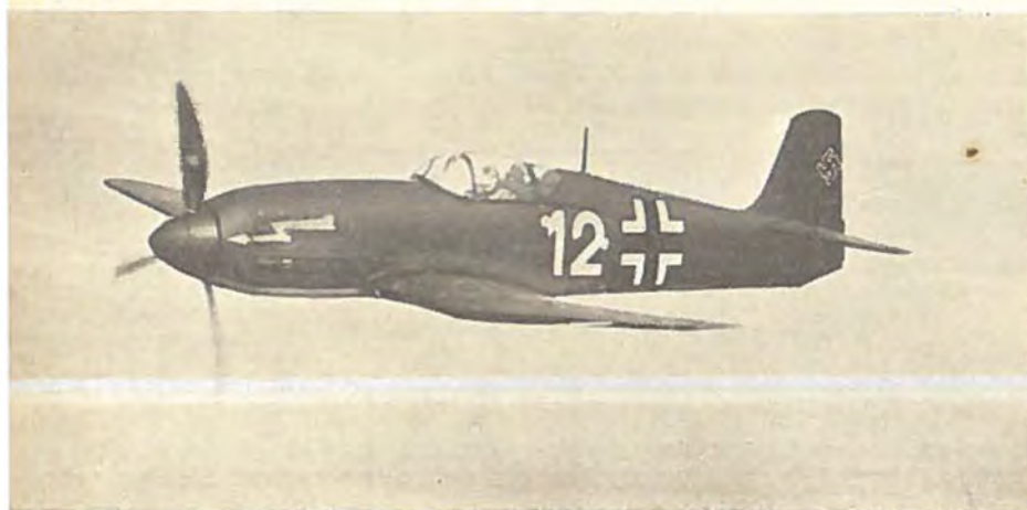
HEINKEL HE 113. Eensædet Jager. Spændvidde 9,4 m, Længde 8,2 m, Planareal 14,5 m 2 . Een 1150 HK vandkølet Daimler-Benz DB601A. 2 faste Mg. og 2 Kanoner. Flyvetid ca. 1½ Time. Hastighed omkring 600 km/T.
