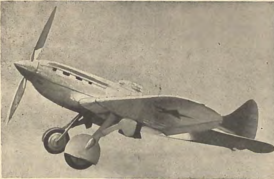
Den russiske Jager Z. K. B-19, et lavninget Metal-Monoplan.
