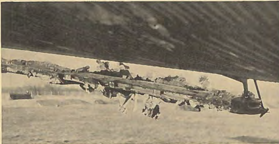
Landingsklapperne paa en Ju 52 er blevet stærkt beskadiget, uden at det har generet Maskinens Flyveegenskaber.
