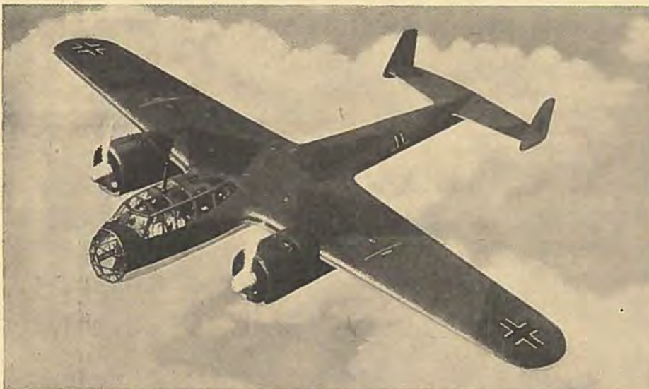
DORNIER DO 215. Mellemtung Bombemaskine. Besætning 4 Mand. 1 bevægeligt Mg. i Næsen, 1 Mg. ovenpaa Kroppen til Skydning bagud og 1 Mg. under Kroppen. To Motorer, enten BMW Stjernemotor eller Daimler Benz vandkølede Motorer. Lasteevne 2181 kg; største Rækkevidde 2970 km; største Hastighed over 500 km/T.
