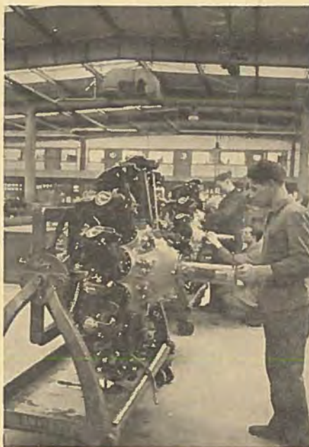
Kontrol af Tændrørsindstillingen paa B. M. W.s Værksteder.
