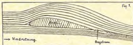
Skematisk Fremstilling af Luftstrøm- men omkring et Planprofil.
