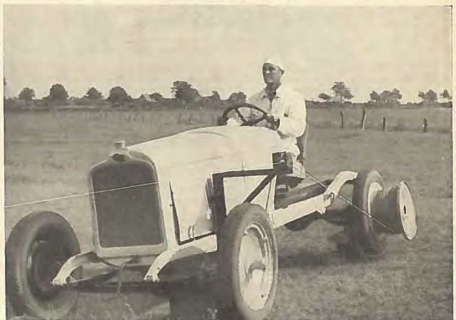
Motorspil med Wiretromle paa Baghjulet.
