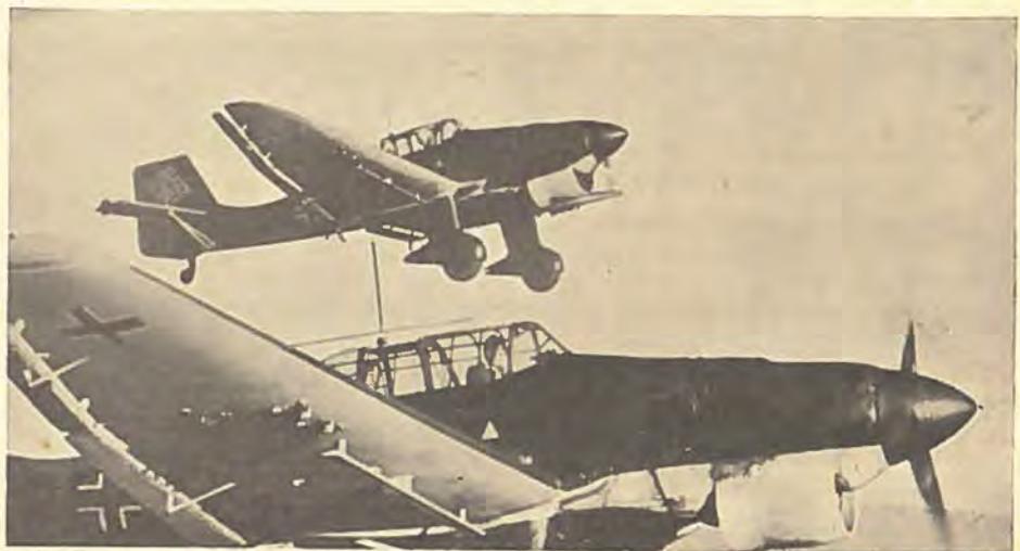
JUNKERS JU 87. Tosædet Dykbomber. Een Junkers Jumo 211 vandkølet Motor paa 1000—1200 HK. 2 faste Mg. og 1 bevægeligt Mg. Bombeophængning: een 250 kg eller en 500 kg Bombe under Kroppen, endvidere to 50 kg under hver Planhalvdel. Største Hastighed under Dyk 688 km/T. Største vandret Hastighed 385 km/T.
