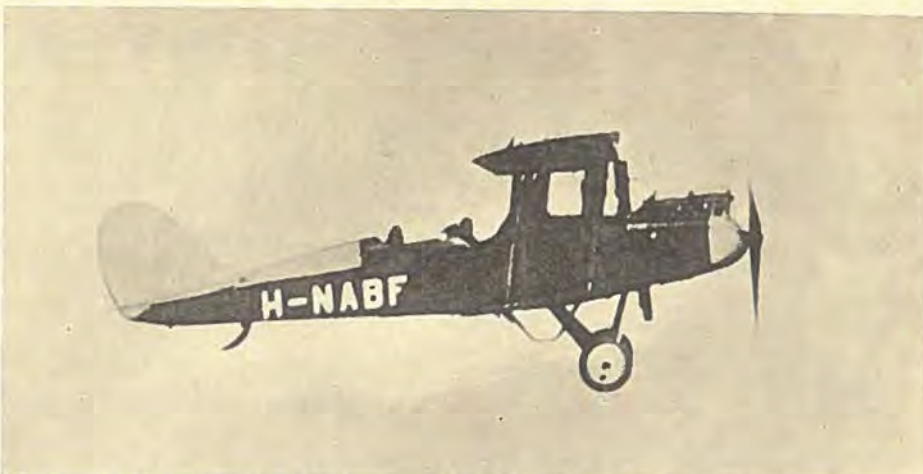
En af K L M's første »Trafikflyvemaskiner«, en ombygget Krigsflyvemaskine af Typen D H 9. — Maskinen kunde tage: en Flyver og to Passagerer, — naar de ikke var for tykke og ikke havde for megen Bagage. — Større Kufferter blev bundet fast paa Siden af Maskinen oven paa det underste Bæreplan.
