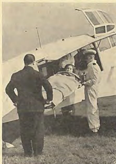
Ambulance-Flyvemaskinen kan aabnes i Siden, saaledes at Baaren bekvemt sættes ind i Kabinen.
