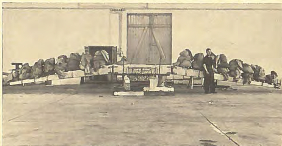
K Z II Bæreplan under Belastningsprøve.
