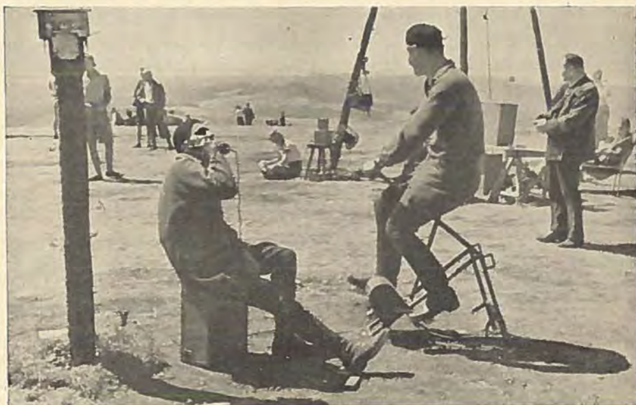
Ved Hjælp af en Telefunken-Kortbølgestation vejledes Svæveflyverne under deres Øvelser over Wasserkuppe. Strømmen frembringes af en Dynamo, der trædes som en Cykel.
