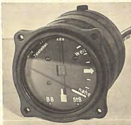
Instrument, hvorefter man aflæser Maskinens Beliggenhed i Forhold til Landingsbaaken.
