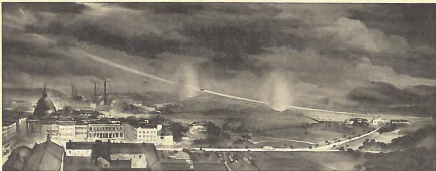
Billedet illustrerer Telefonen Baakelandings-System. Den lange lyse Stribe angiver Baakesenderens Ledetone. Forsignalet (længst tilvenstre) og Hovedsignalet underretter Flyveren om Afstanden fra Lufthavnen.
