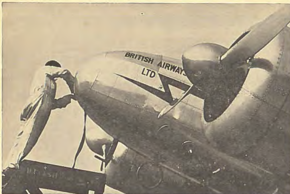
»Næsen« lukkes til paa den store Lockheed Electra Maskine, efter at Passagerernes Bagage er blevet stuvet ned.
