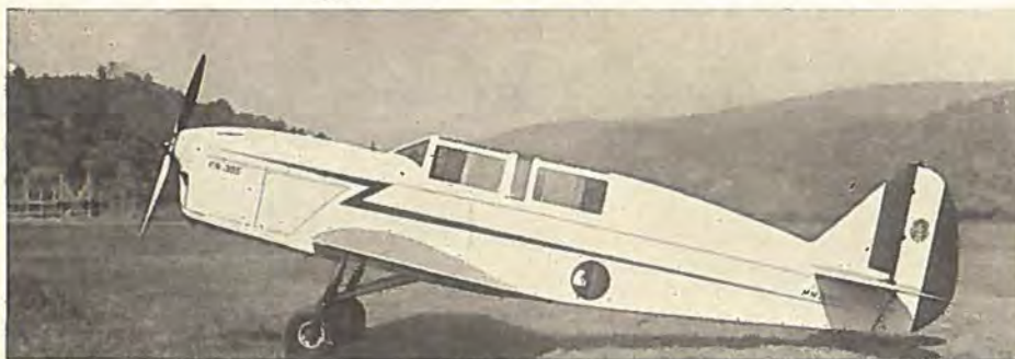
F. N. 305. En-Motors Jagertype, lavvinget Monoplan, den fremstilles enten som eensædet åben Maskine eller tosædet lukket. Motoren er en Alfa Romeo 115-I, seks-cylindret luftkølet paa 200 H.K. Maskinens Nettovægt er 700 kg og der kan transporteres en Nyttelast paa 280 kg. Maximalhastigheden er 310 km/T.
