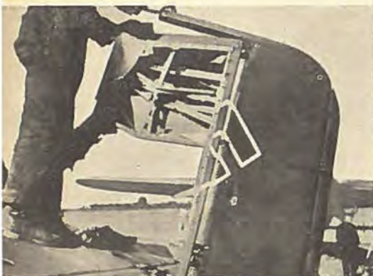
Selv efter at Halefinnen var skudt bort, kunde denne Ju 87 flyve hjem.
