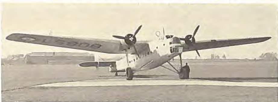
Bristol Bombay med to Bristol Pegasus XXII Motorer.
