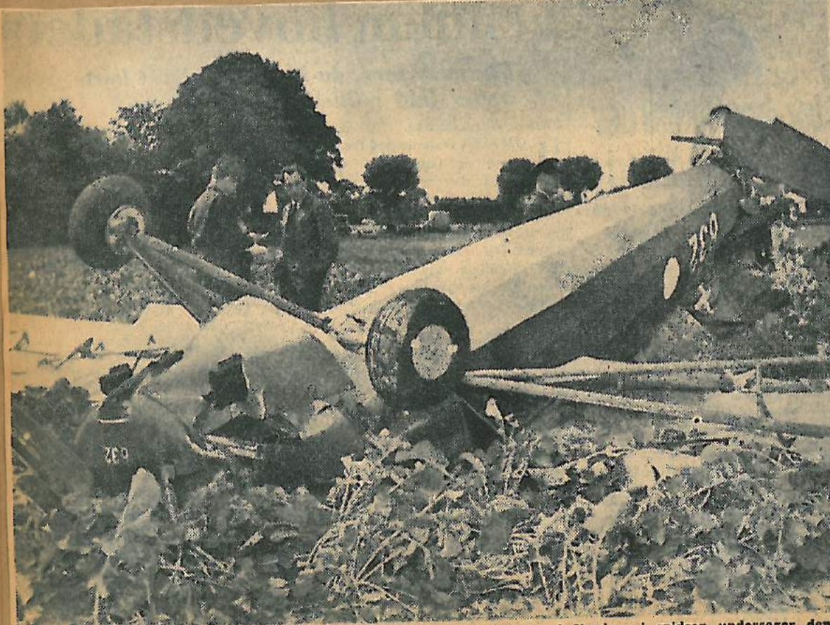
Havarikommissionen med kaptajn A. S. Bendtsen fra flyveinspektionen i Værløse i spidsen undersøger den nedstyrtede KZ-maskine. Bemærk det knækkede haleparti.
